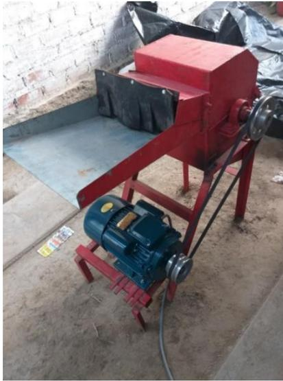
*Figura 3.* Máquina trituradora de botellas de vidrio.
