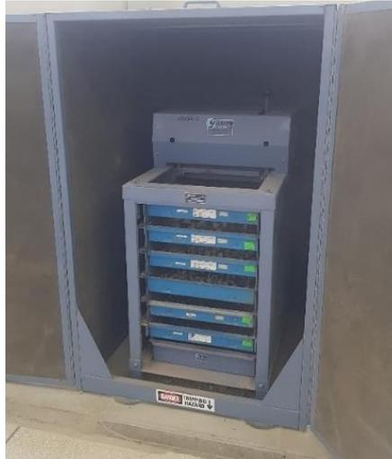
Figura 17. Agitador mecánico de tamices.
