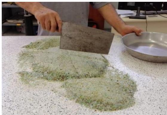
*Figura 8.* Cuarteo del Agregado Fino (vidrio molido).
