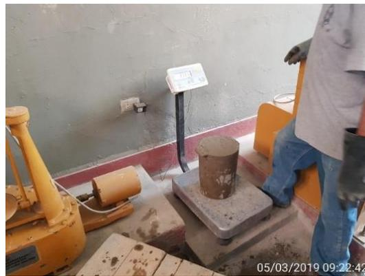
*Figura 19.* Peso unitario del concreto en su estado fresco.
