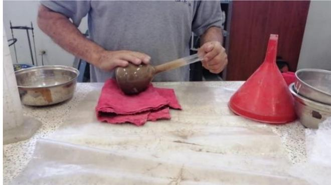
*Figura 15.* Frasco de Le Chatelier ensayo al agregado fino (arena gruesa).
