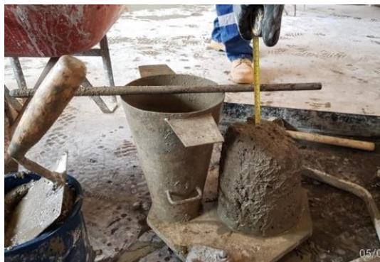
*Figura 18.* Ensayo al concreto fresco con el cono de Abrams.
