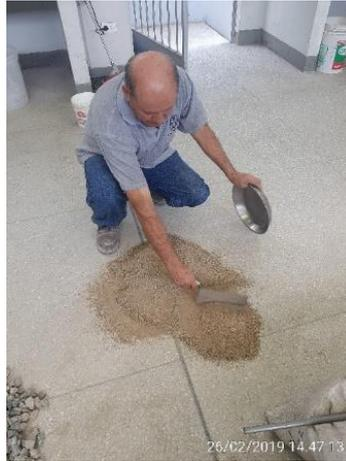
*Figura 7.* Cuarteo del Agregado Fino (arena gruesa).
