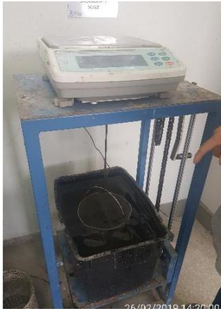
*Figura 14.* Peso específico del agregado grueso
