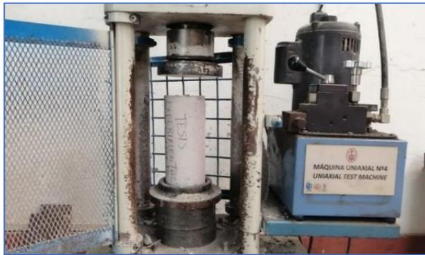
*Figura 22.* Máquina de ensayo a compresión.
