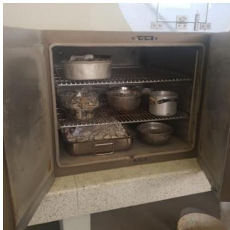
*Figura 10.* Horno de secado temperatura uniforme de  $110^{\circ}\text{C} \pm 5^{\circ}\text{C}$ .
