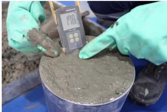
*Figura 20.* Termómetro para concreto.
