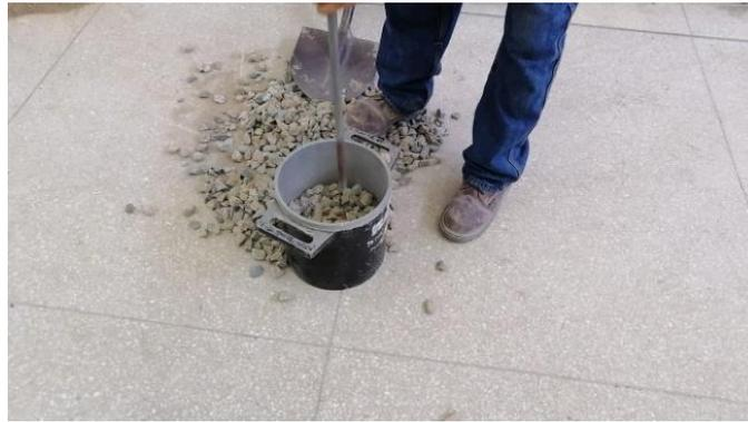
*Figura 13.* Peso unitario del material compactado del agregado grueso.
