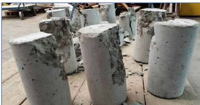
*Figura 24.* Testigos después del ensayo a compresión.
