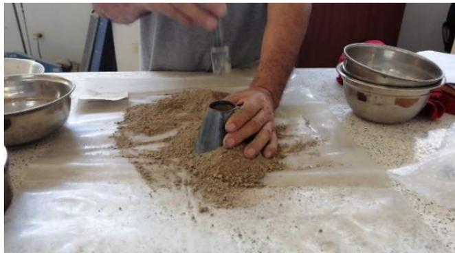
*Figura 16.* Cono Truncado ensayo al agregado fino (arena gruesa).
