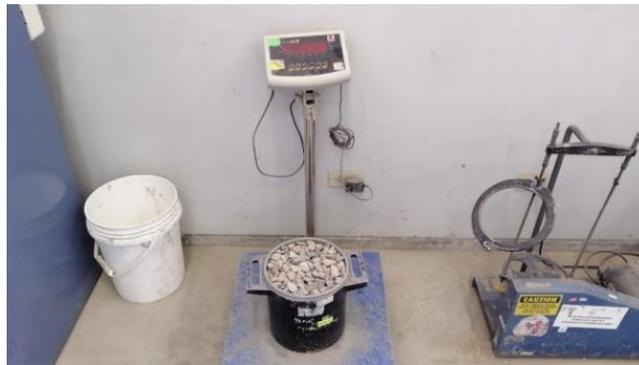
*Figura 12.* Peso unitario suelto del agregado grueso.
