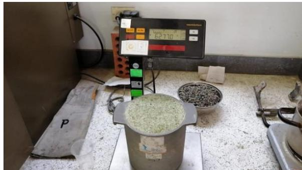
*Figura 11.* Balanza para agregados con certificado de Calibración.
