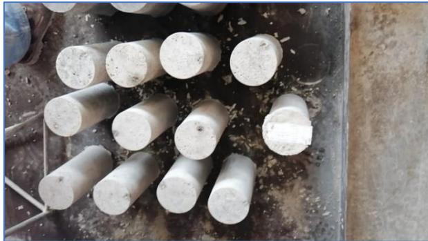
*Figura 23.* Testigos (Población de probetas).
