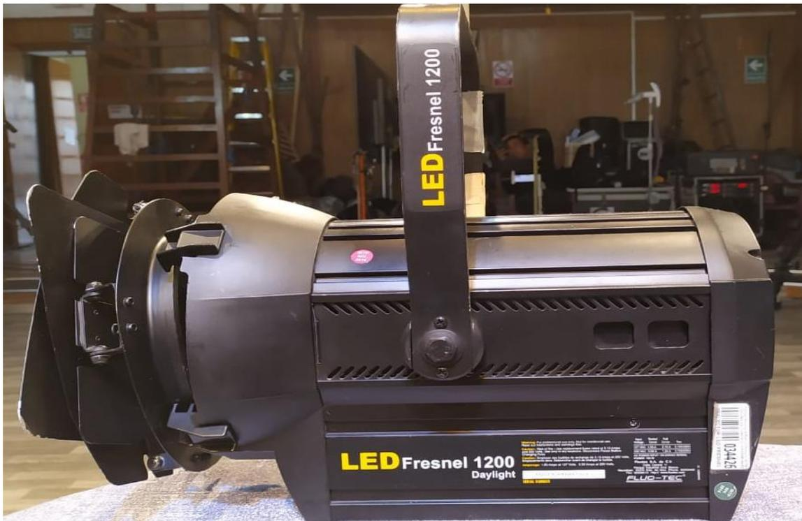
**Figura 31:** Fresnel led tiene la misma potencia lumínica que un fresnel de tungsteno, pero su consumo es menor.
