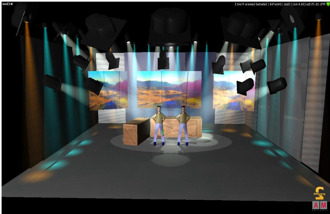
**Figura 34:** Diseño de iluminación 3 D del estudio 1 de TV Perú con tecnología led.
