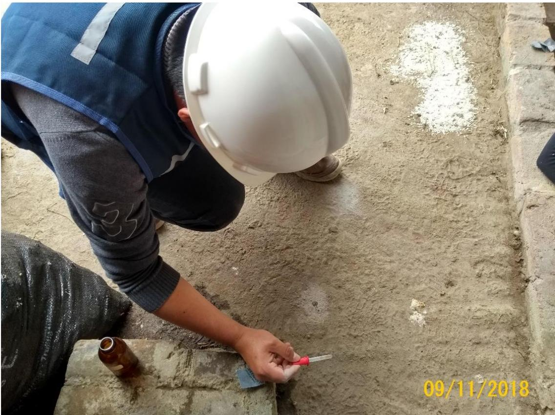
*Figura 13.* Prueba de presencia de cloruros en losa aligerada usando nitrato de plata, concentración 0.01N.
