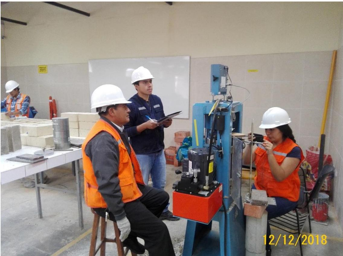
*Figura 21.* Ensayo: Resistencia a la compresión de las unidades de albañilería.
