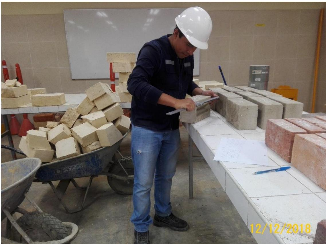
*Figura 19.* Ensayo: Variación dimensional en unidades de albañilería.
