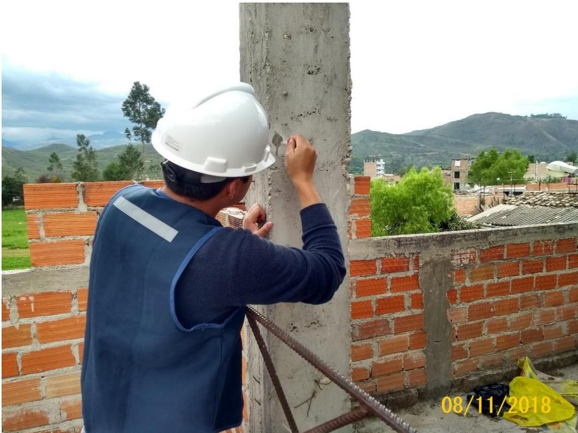
*Figura 9.* Pruebas de carbonatación en columnas usando fenolftaleína al 1% en alcohol, Vivienda 02.
