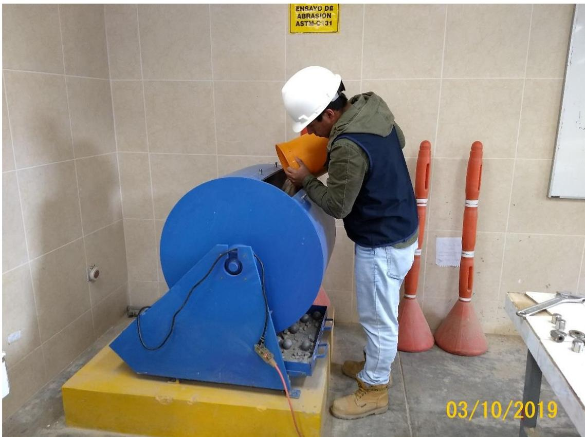
*Figura 22.* Ensayo: Abrasión los ángulos al desgaste de los agregados.
