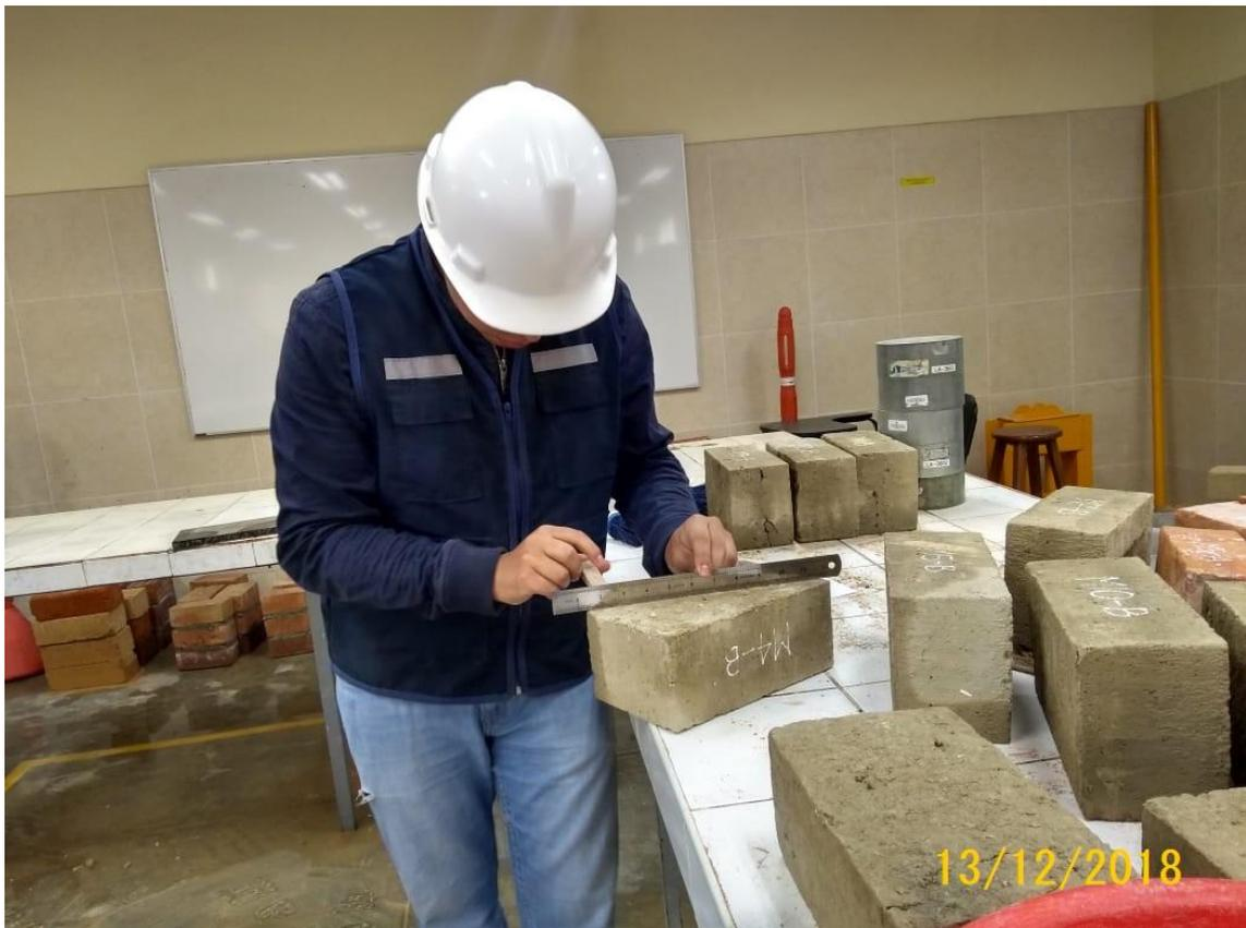
*Figura 20.* Ensayo: Alabeo en unidades de albañilería.
