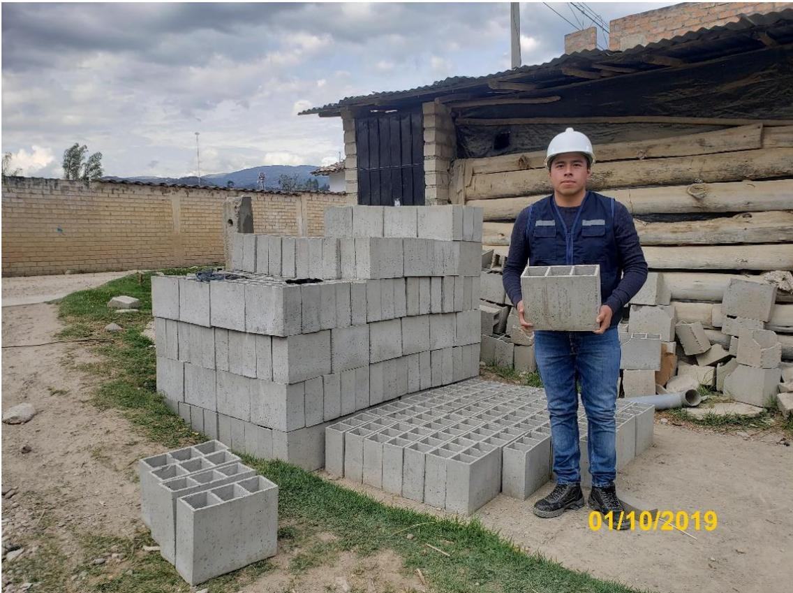
*Figura 17.* Recolección de muestras de ladrillo hueco de concreto para losa aligerada de la ciudad de San Marcos.
