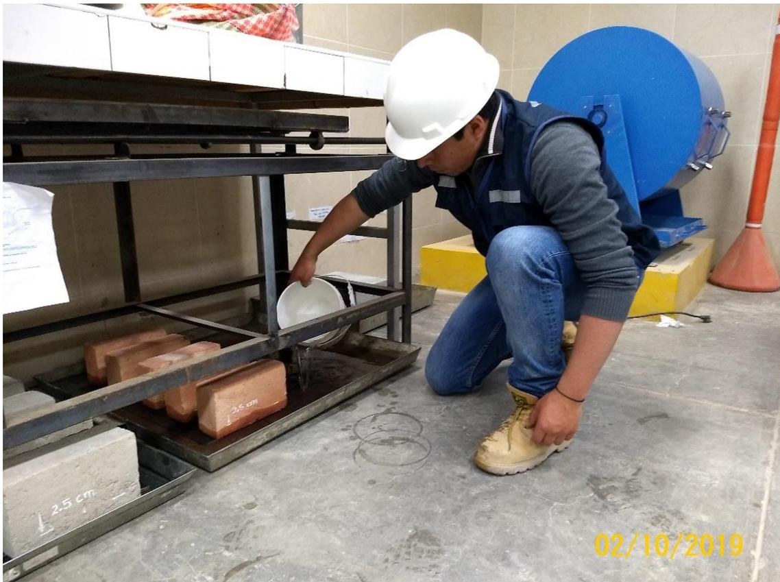
*Figura 24.* Ensayo: Eflorescencia en unidades de albañilería.
