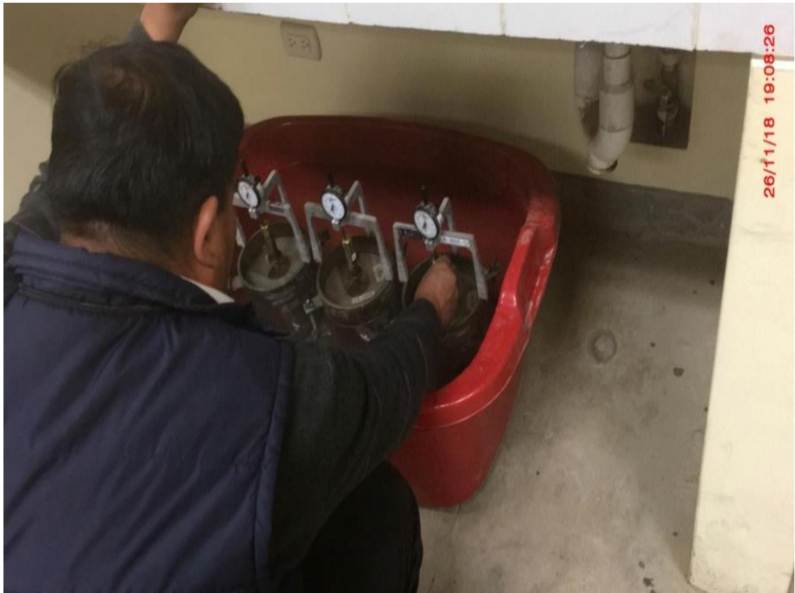
Fotografía N° 06: Se puede apreciar al técnico de laboratorio colocando los deformímetros para el ensayo de hinchamiento de los especímenes de CBR.
