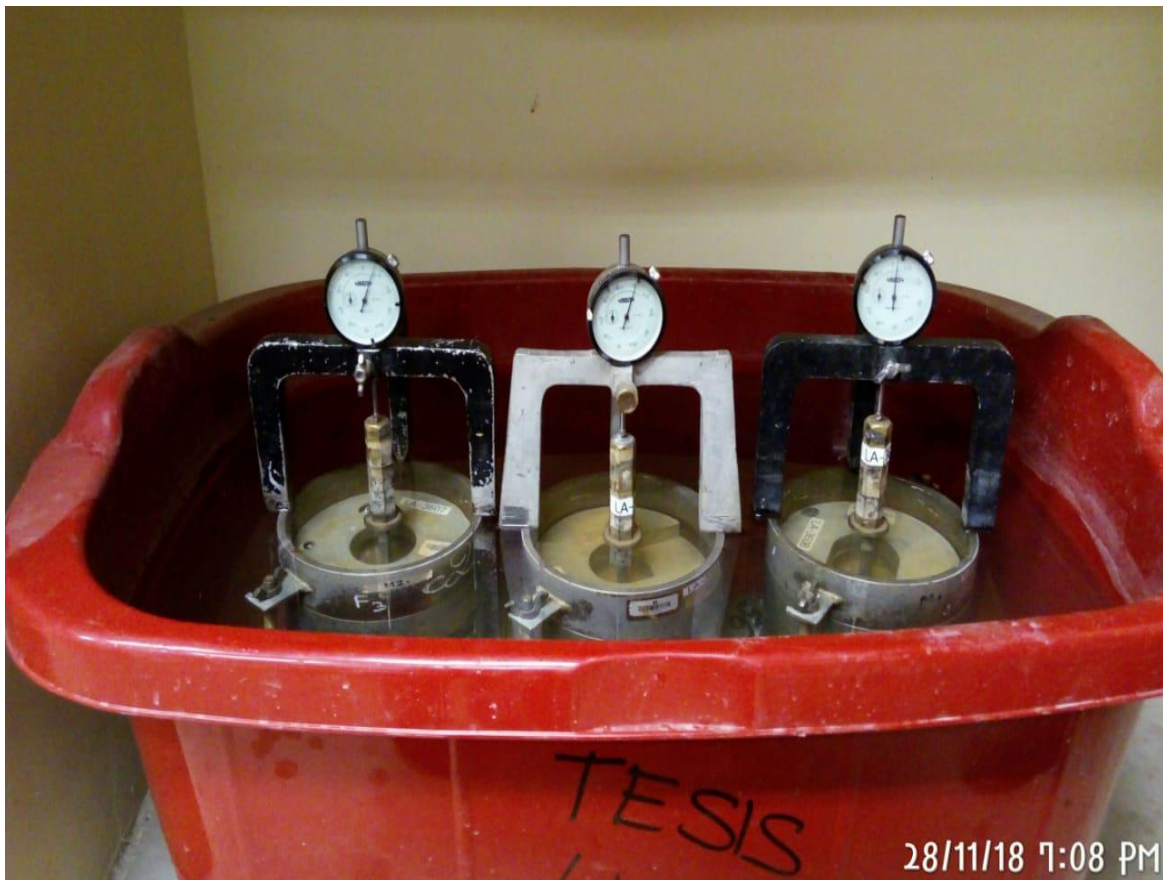
Fotografía N° 07: Se puede apreciar los tres especímenes (13 golpes, 27 golpes y 56 golpes) mientras se encuentran sumergidos.
