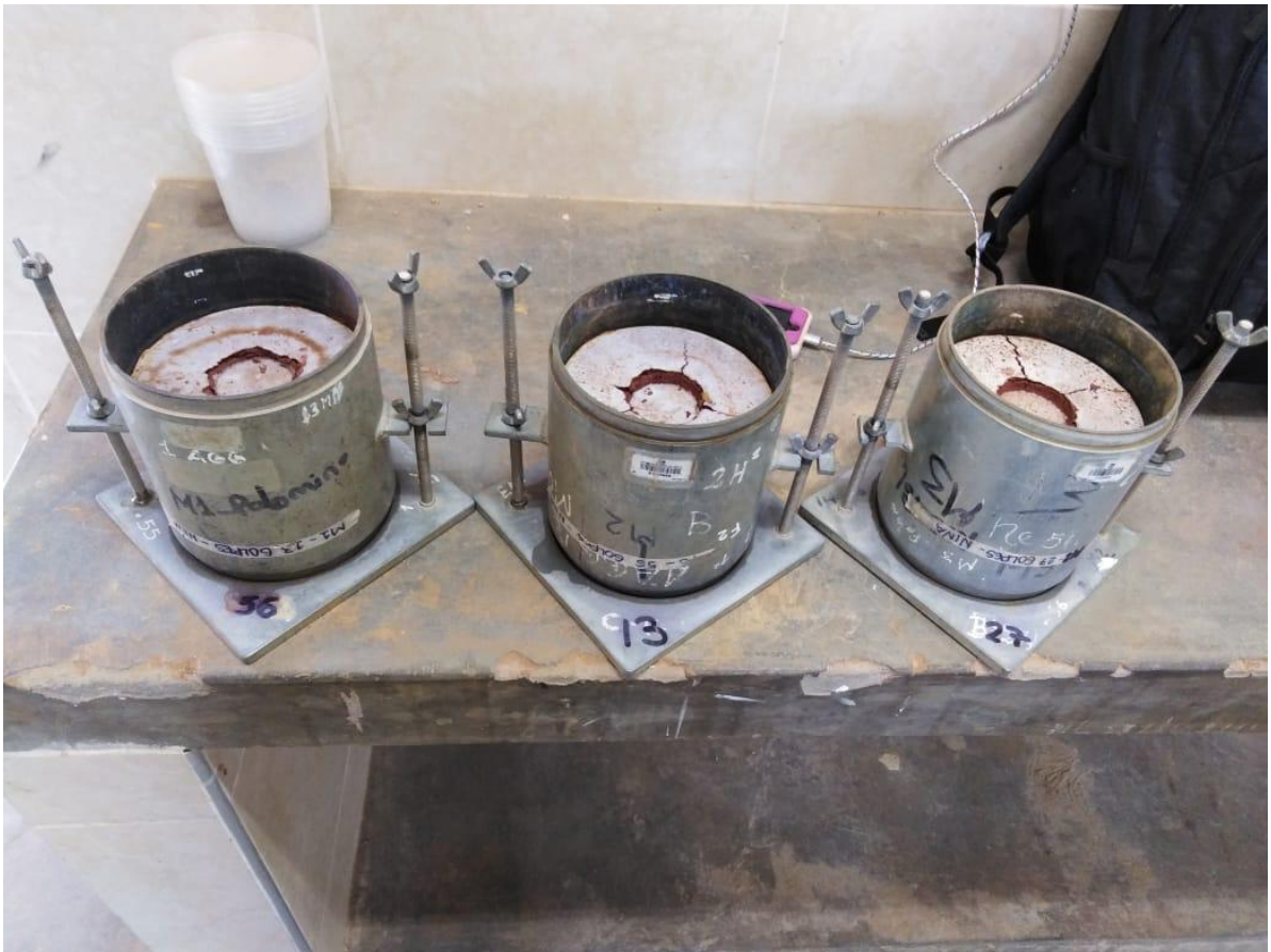
Fotografía N° 08: Se puede apreciar los especímenes luego del ensayo de Penetración.
