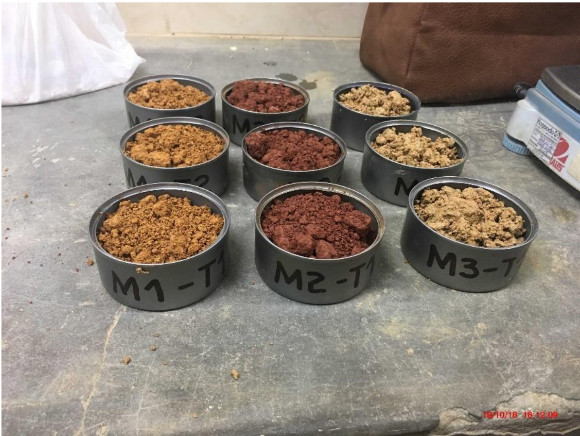
Fotografía N° 01: Se observan recipientes con las muestras de los tres suelos para el ensayo de contenido de humedad.
