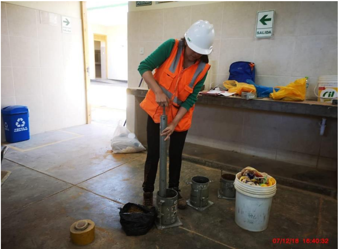
Fotografía N° 05: Se aprecia a la estudiante realizando la compactación de los especímenes de CBR.
