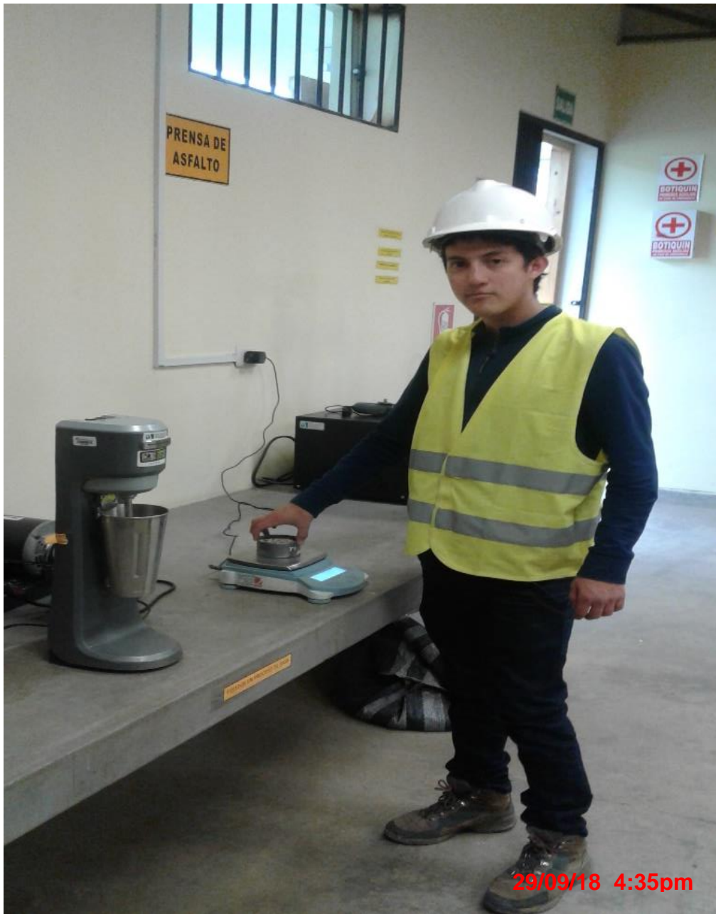
Figura 9. Peso para determinar la cantidad de material que pasa por el tamiz N°200
