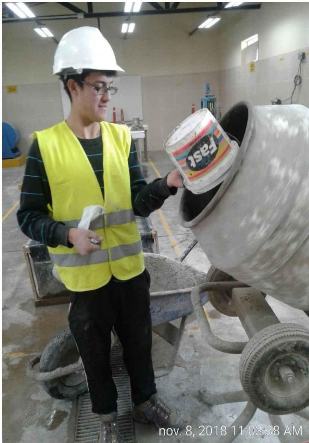
Figura 17. Proceso de elaboración de ladrillos de concreto
