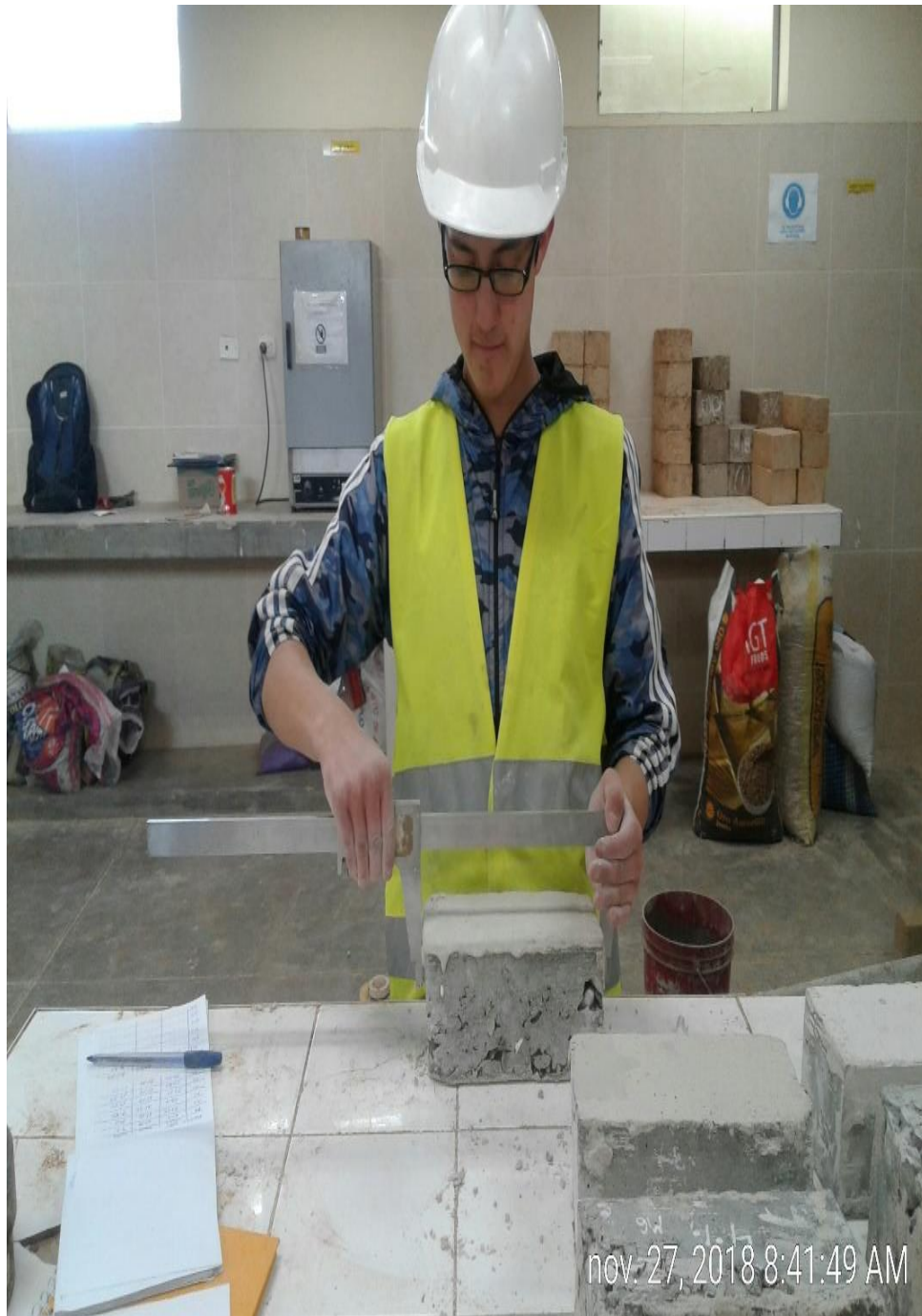
Figura 22. Medición de las dimensiones del ladrillo de concreto
