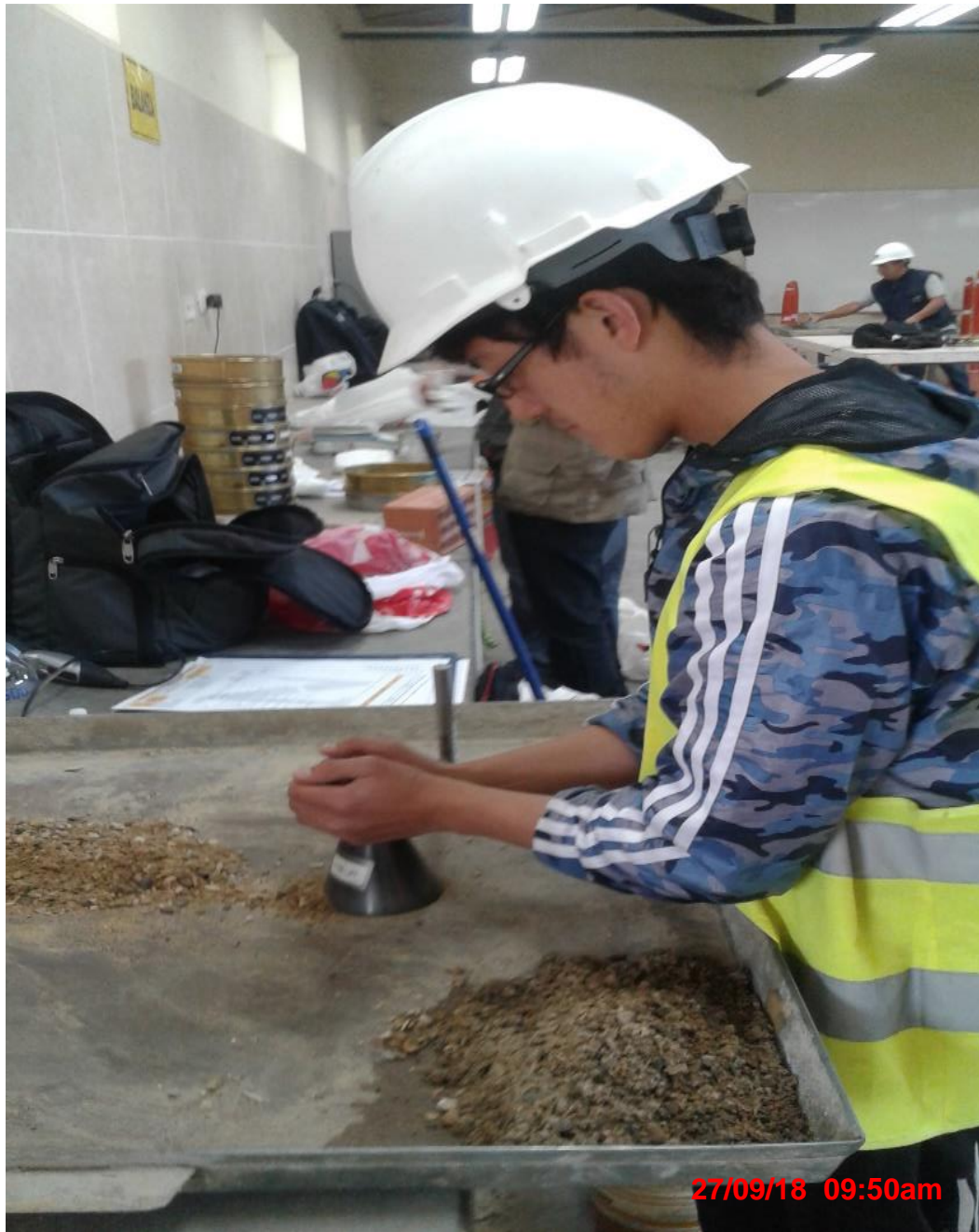
Figura 7. Elaboración de ensayo de gravedad específica y absorción de agregados finos
