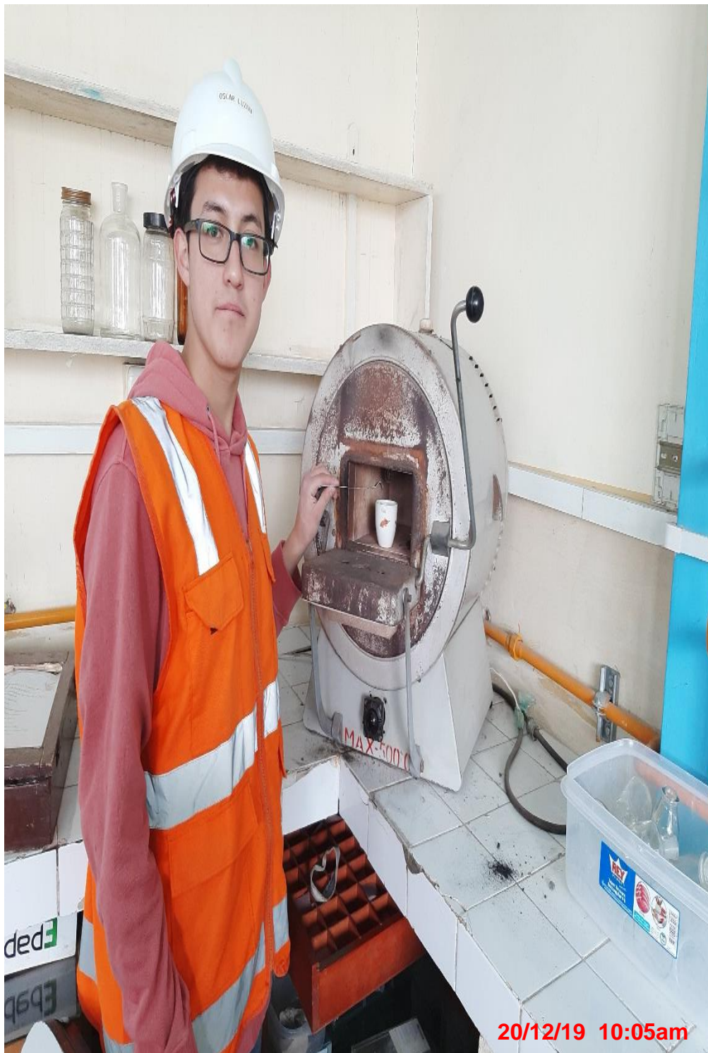
Figura 16. Proceso de calcinación de la ceniza de cáscara de arroz
