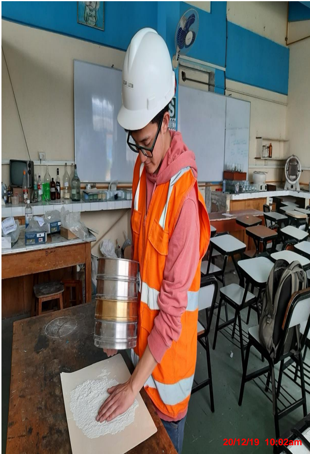
Figura 15. Tamizado de ceniza de cáscara de arroz
