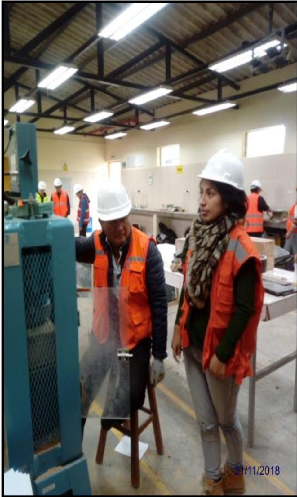
Fotografía N° 32: Toma de lectura de la carga máxima en la máquina compresora, con ayuda del técnico Víctor – compresión axial.
