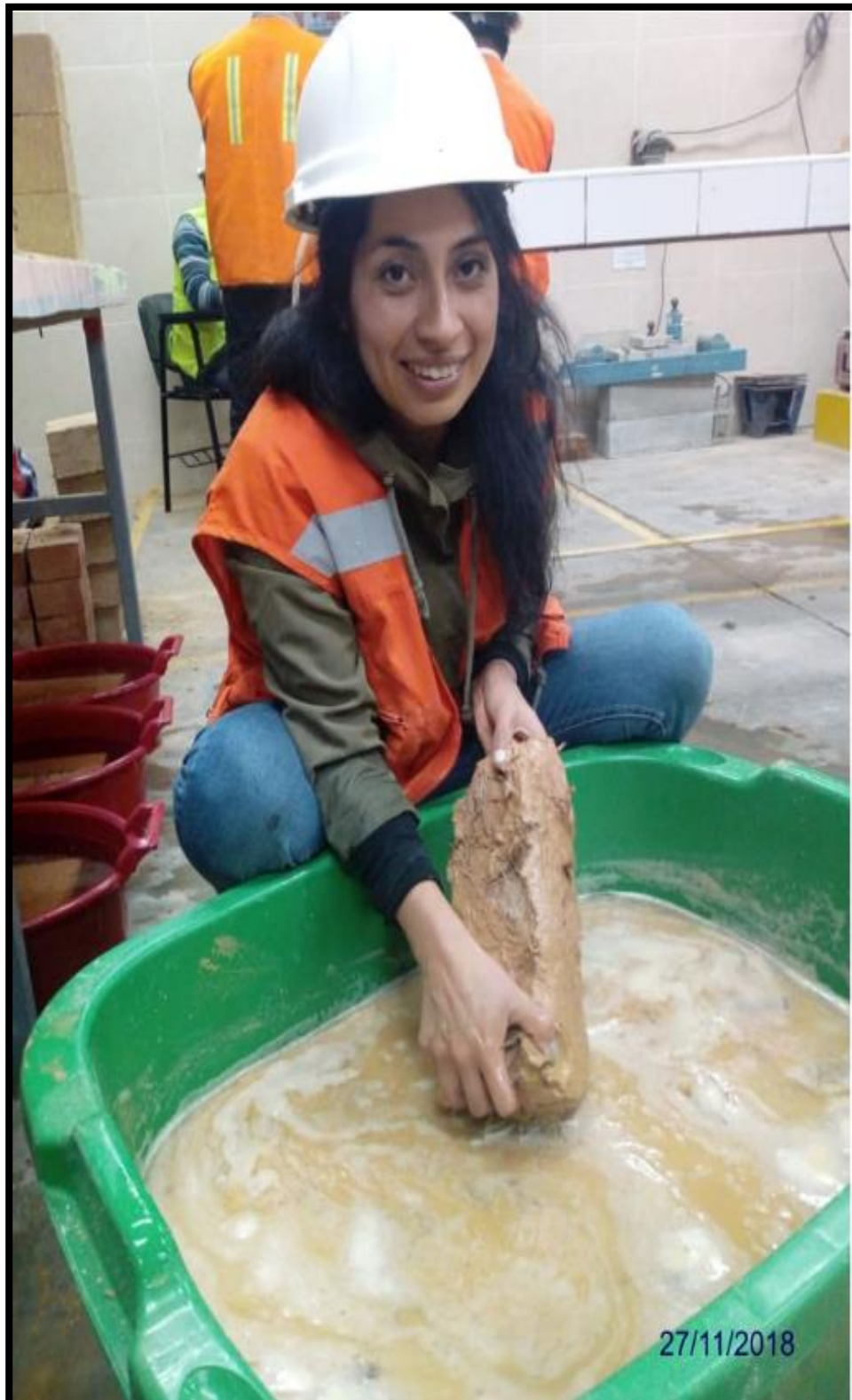
Fotografía N° 40: Muestra con incorporación de fibra de coco sumergido 24 horas – no resiste al grado de absorción.
