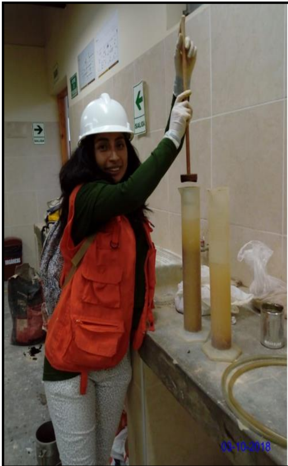
Fotografía N° 10: Introducción del disco metálico cuando el material está totalmente sedimentado.
