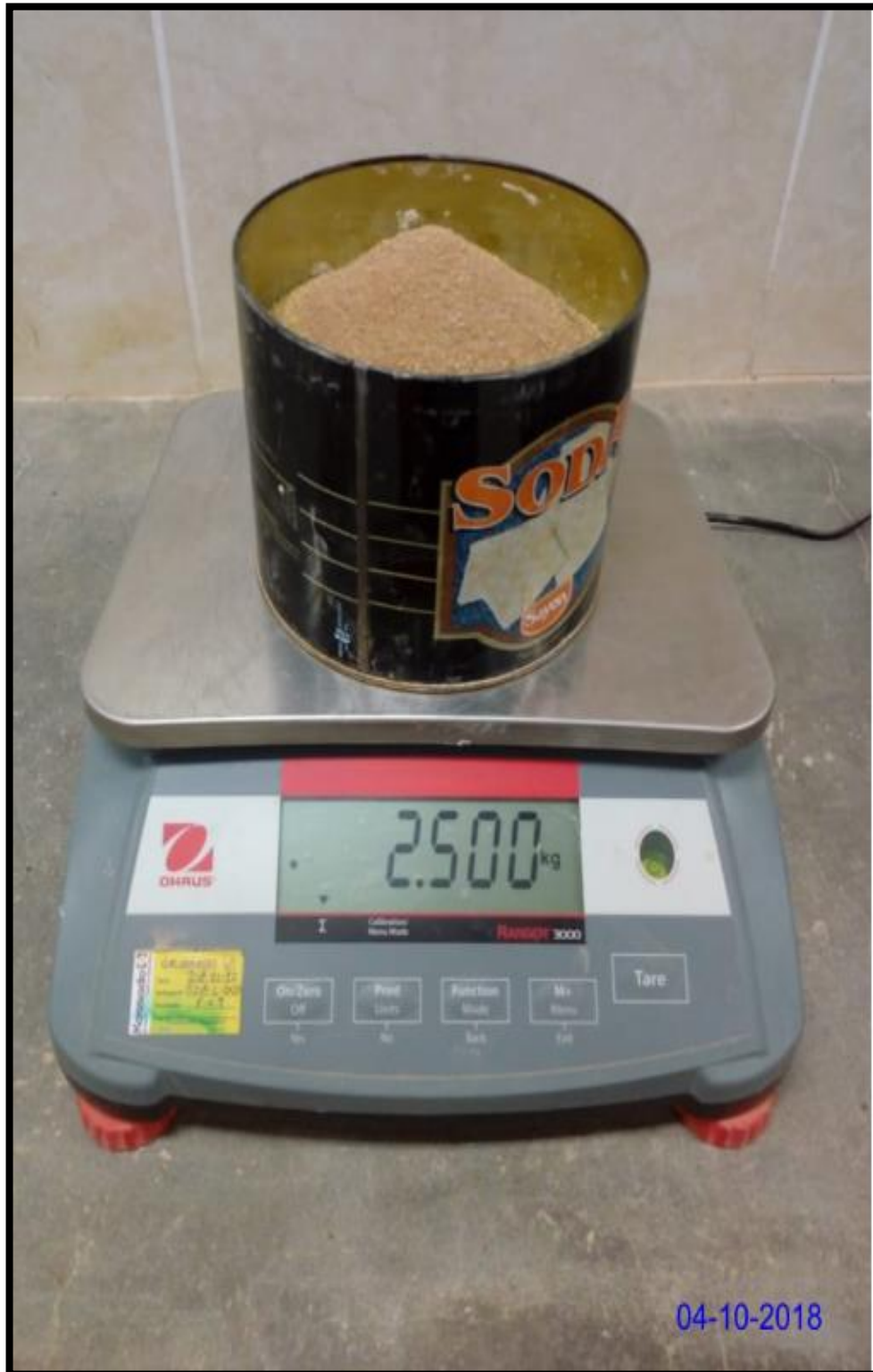
Fotografía N° 14: Muestra para realizar el ensayo de proctor modificado método A, para la muestra patrón.
