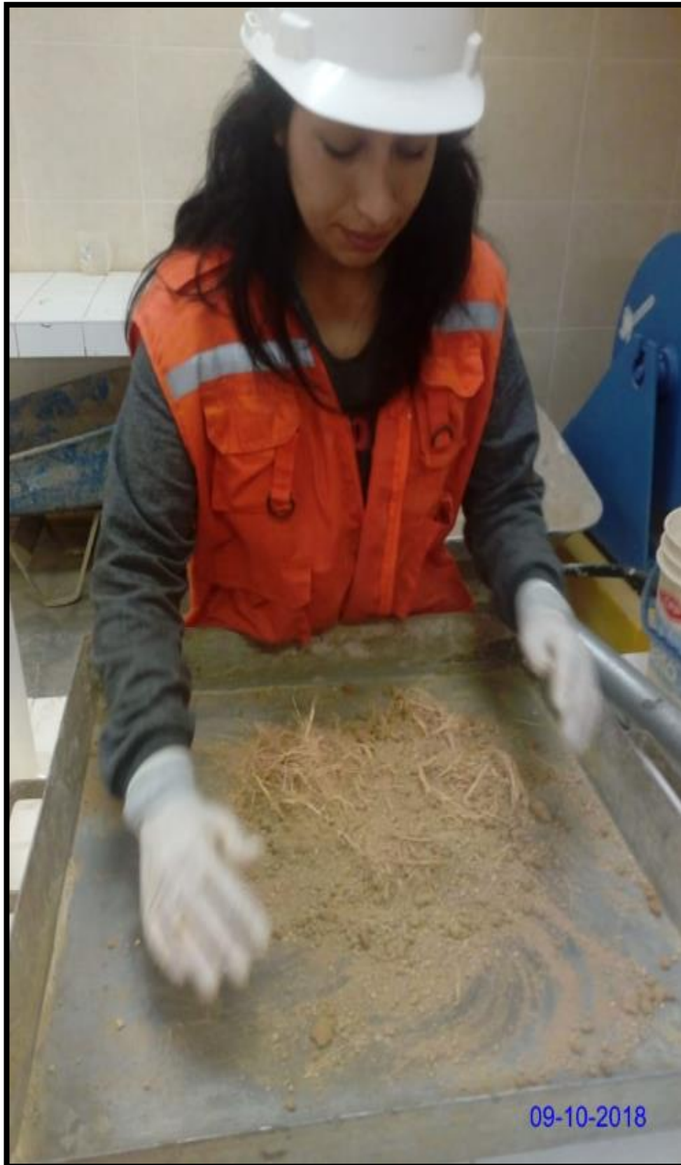
Fotografía N° 19: Mezclando la tierra con la fibra de coco.
