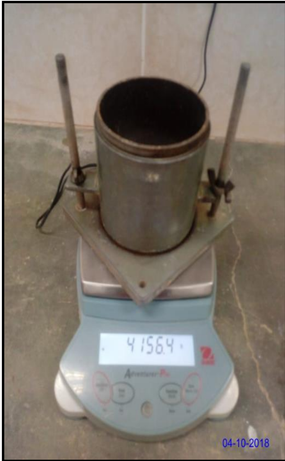
Fotografía N° 13: Peso del molde para el ensayo de proctor modificado método A, para la muestra patrón.
