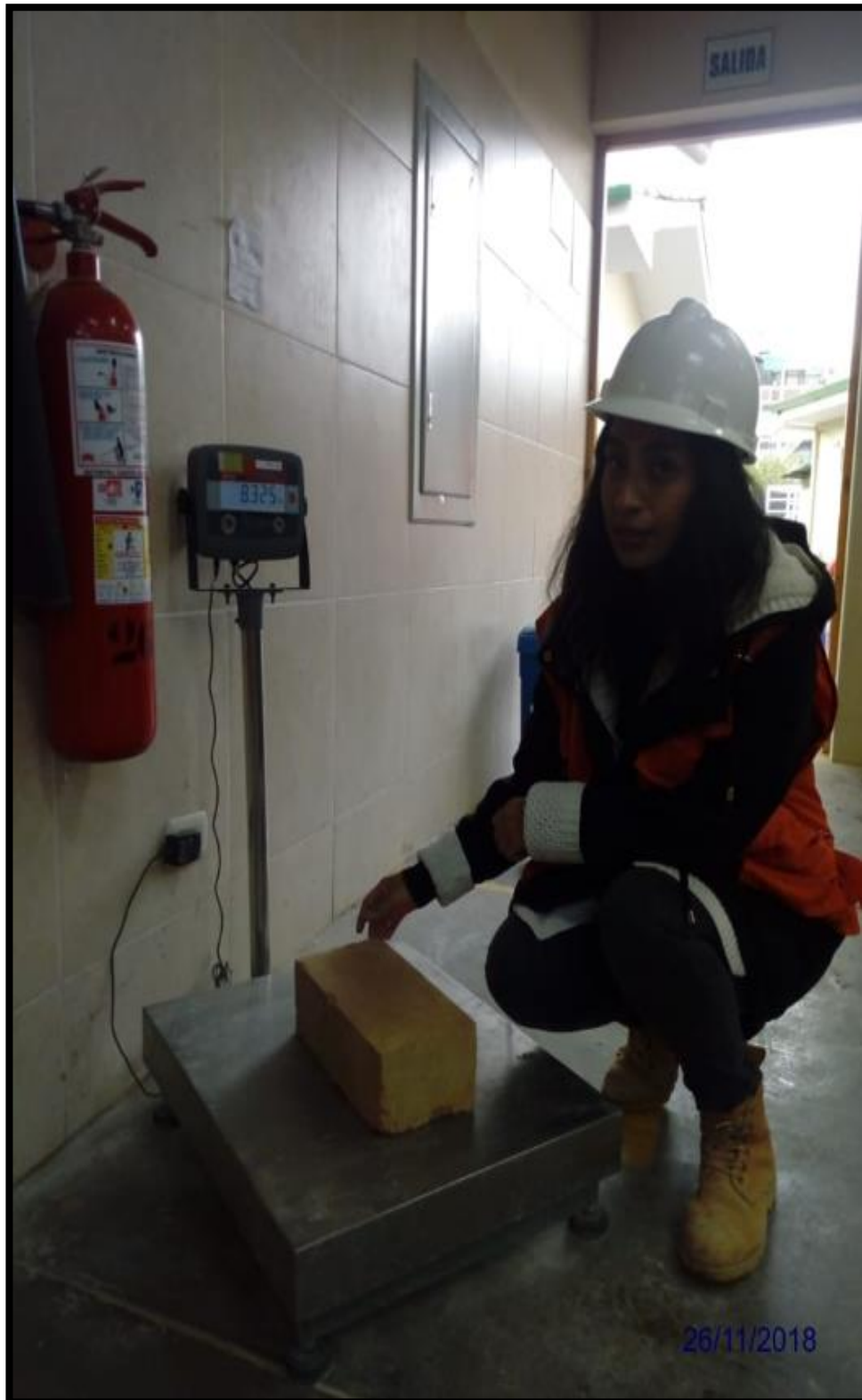
Fotografía N° 34: Pesando la unidad de adobe compactado – muestra patrón – grado de absorción.
