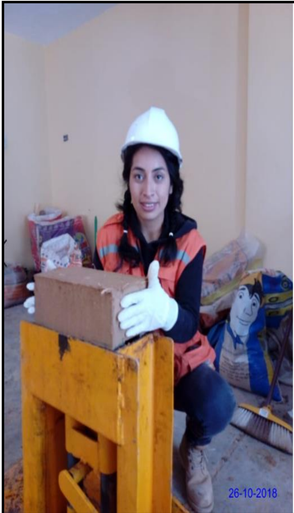
Fotografía N° 28: Adobe compactado en la máquina CINVA-RAM.
