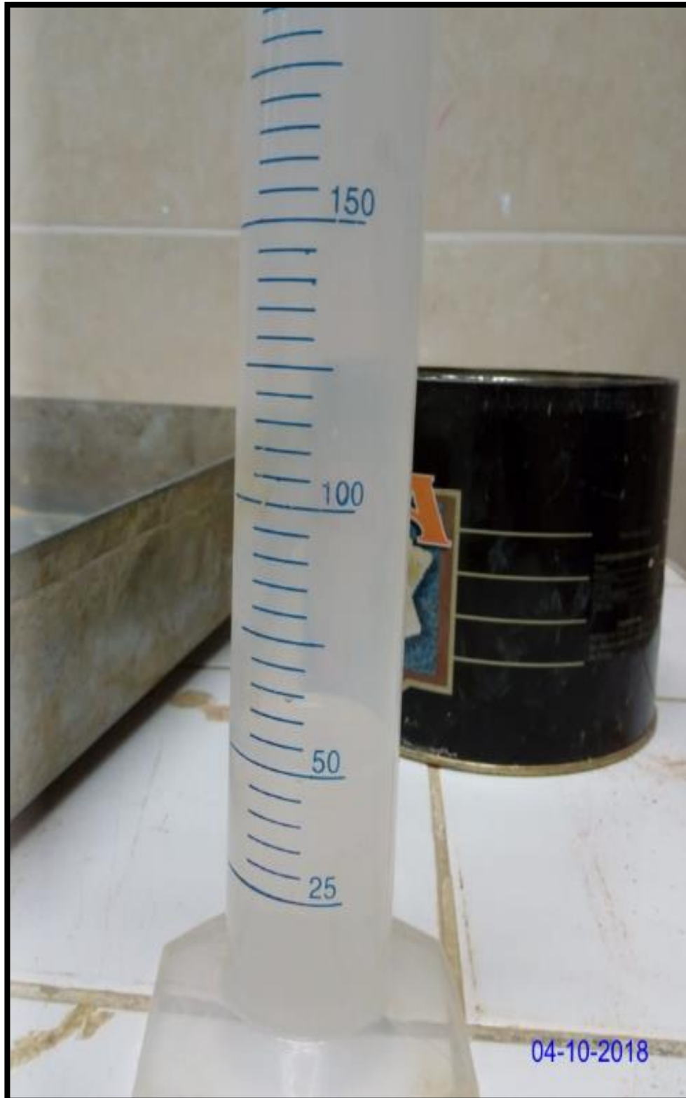
Fotografía N° 15: Cantidad de agua para el ensayo de proctor modificado método A, para la muestra patrón.
