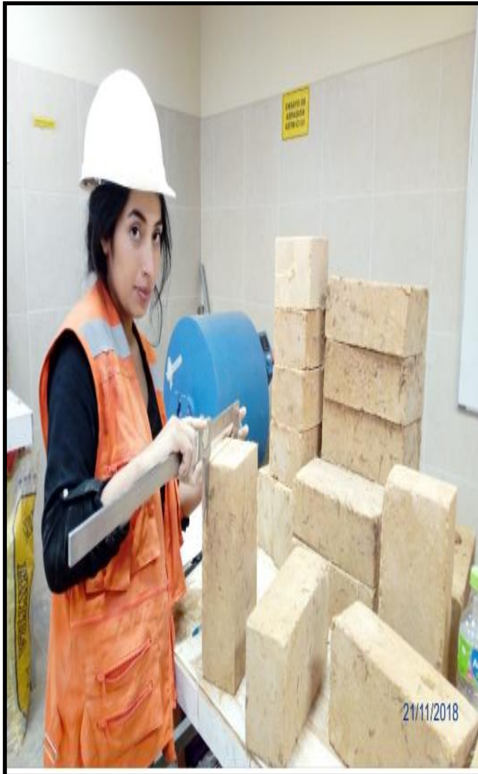
Fotografía N° 31: Realizando la toma de medidas del largo, ancho y alto del adobe con el instrumento vernier.
