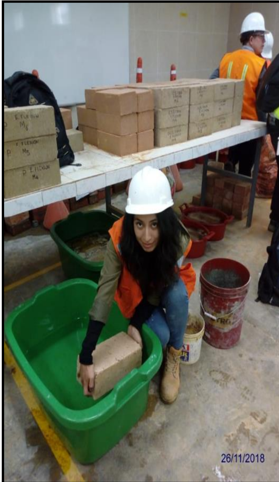
Fotografía N° 35: Colocación del adobe compactado en la tina con agua.
