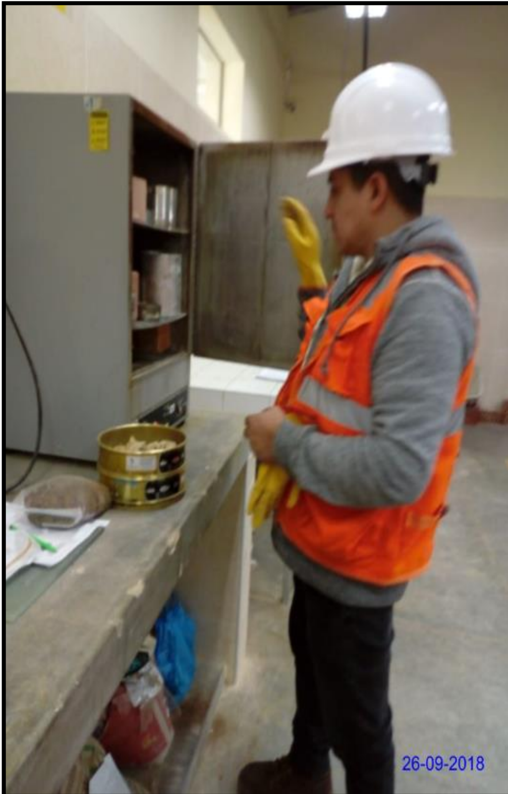
Fotografía N° 7: Colocación de las muestras de límites de plasticidad al horno por el
