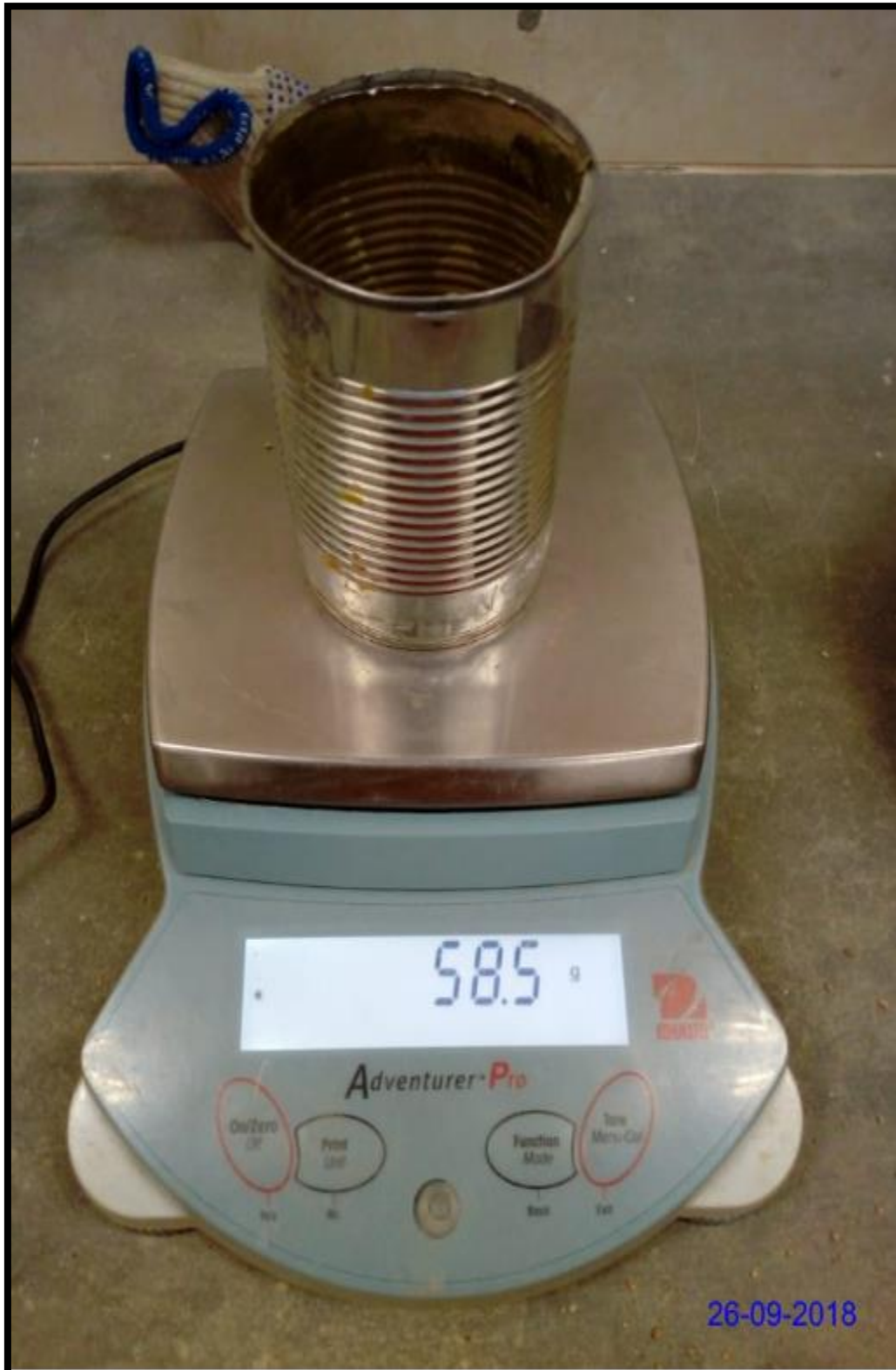
Fotografía N° 6: Pesos del material -ensayo límite plástico
