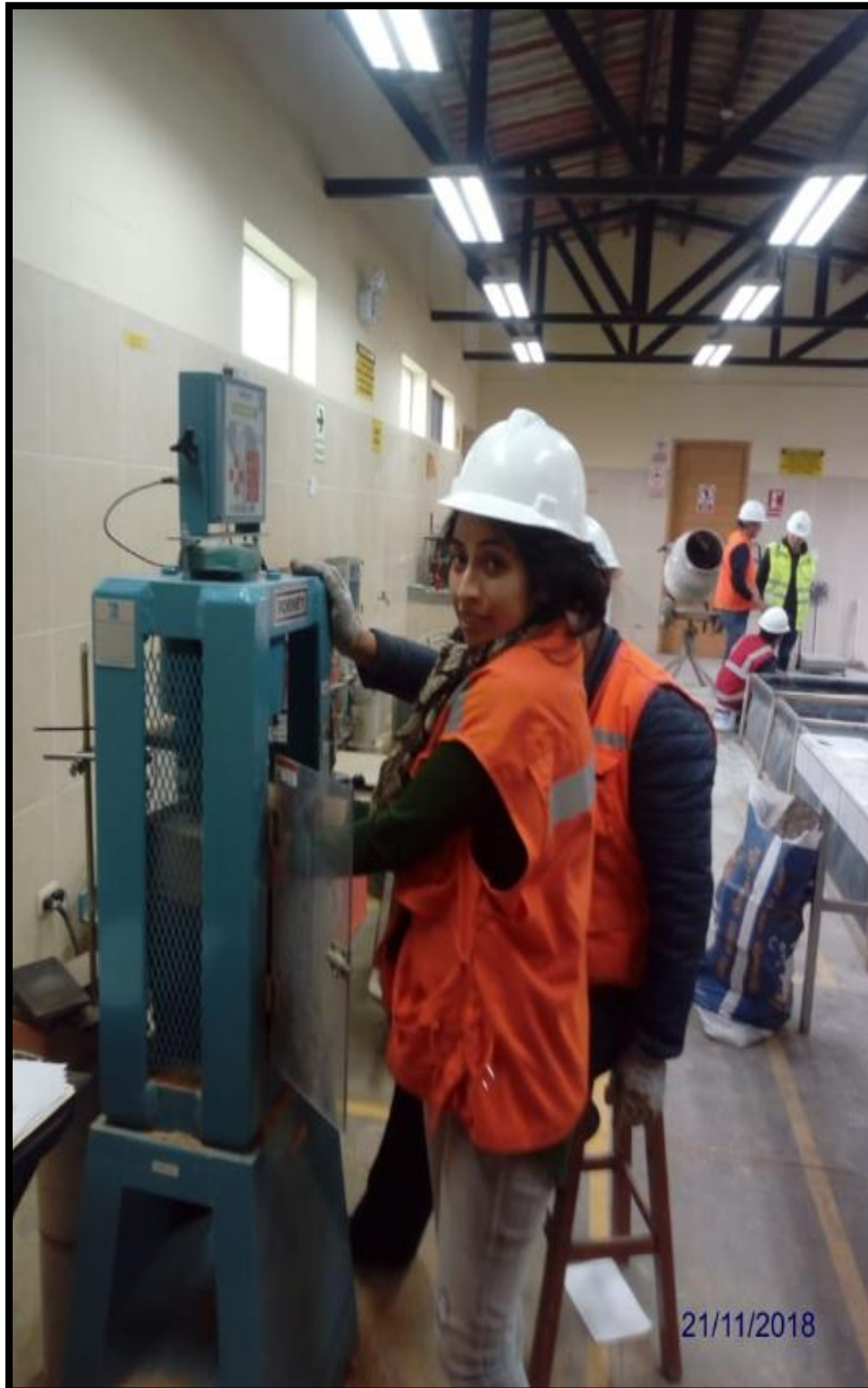
Fotografía N° 33: Sacando el adobe compactado, llegando a la resistencia máxima de flexión.
