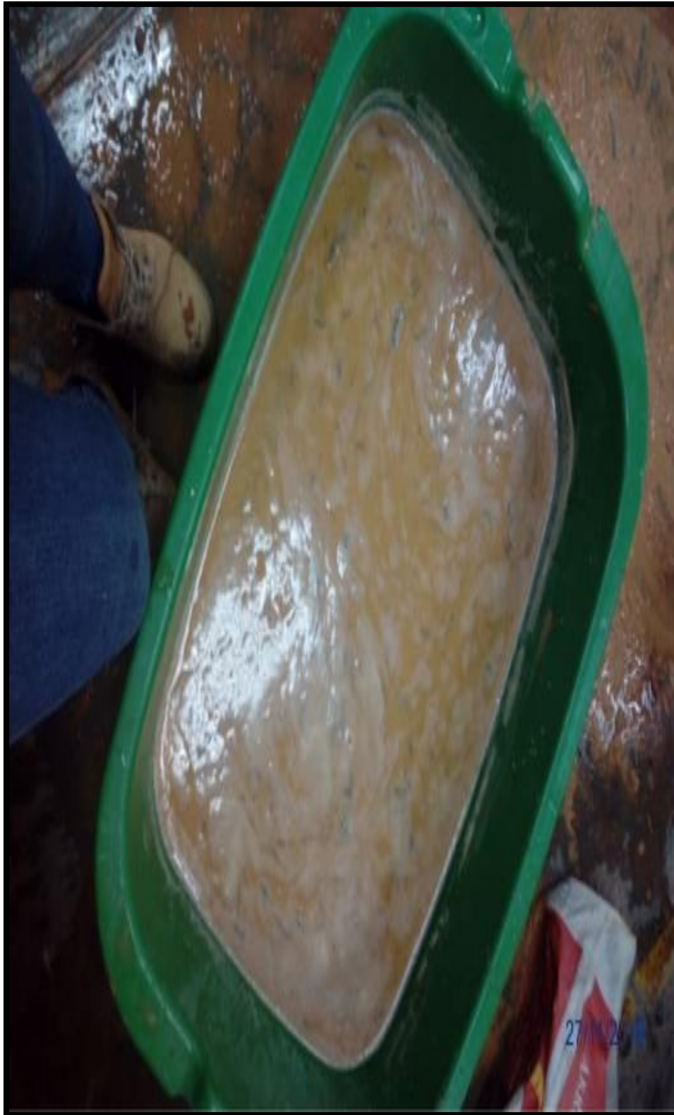
Fotografía N° 37: Muestra patrón – disuelto por completo en el agua, sumergido por 24horas.
