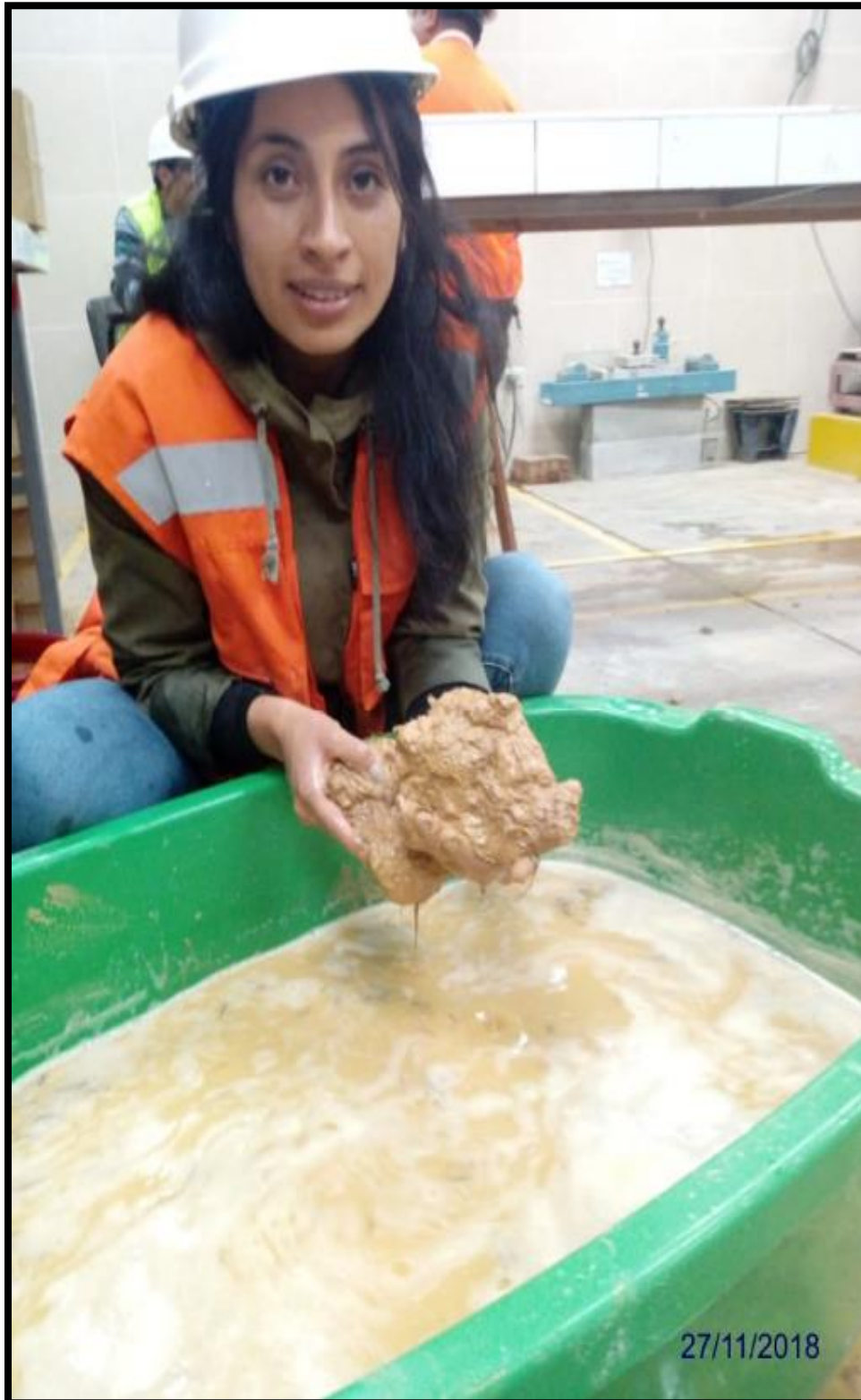
Fotografía N° 41: Muestra con incorporación de fibra de coco sumergido 24 horas – no resiste al grado de absorción.
