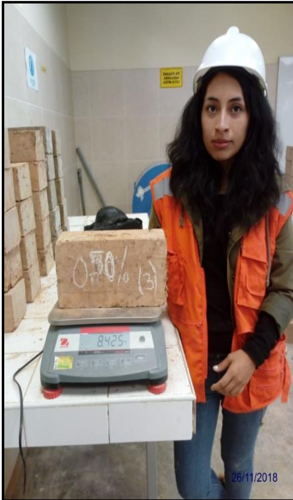
Fotografía N° 38: Peso de adobes con incorporación de fibra de coco.
