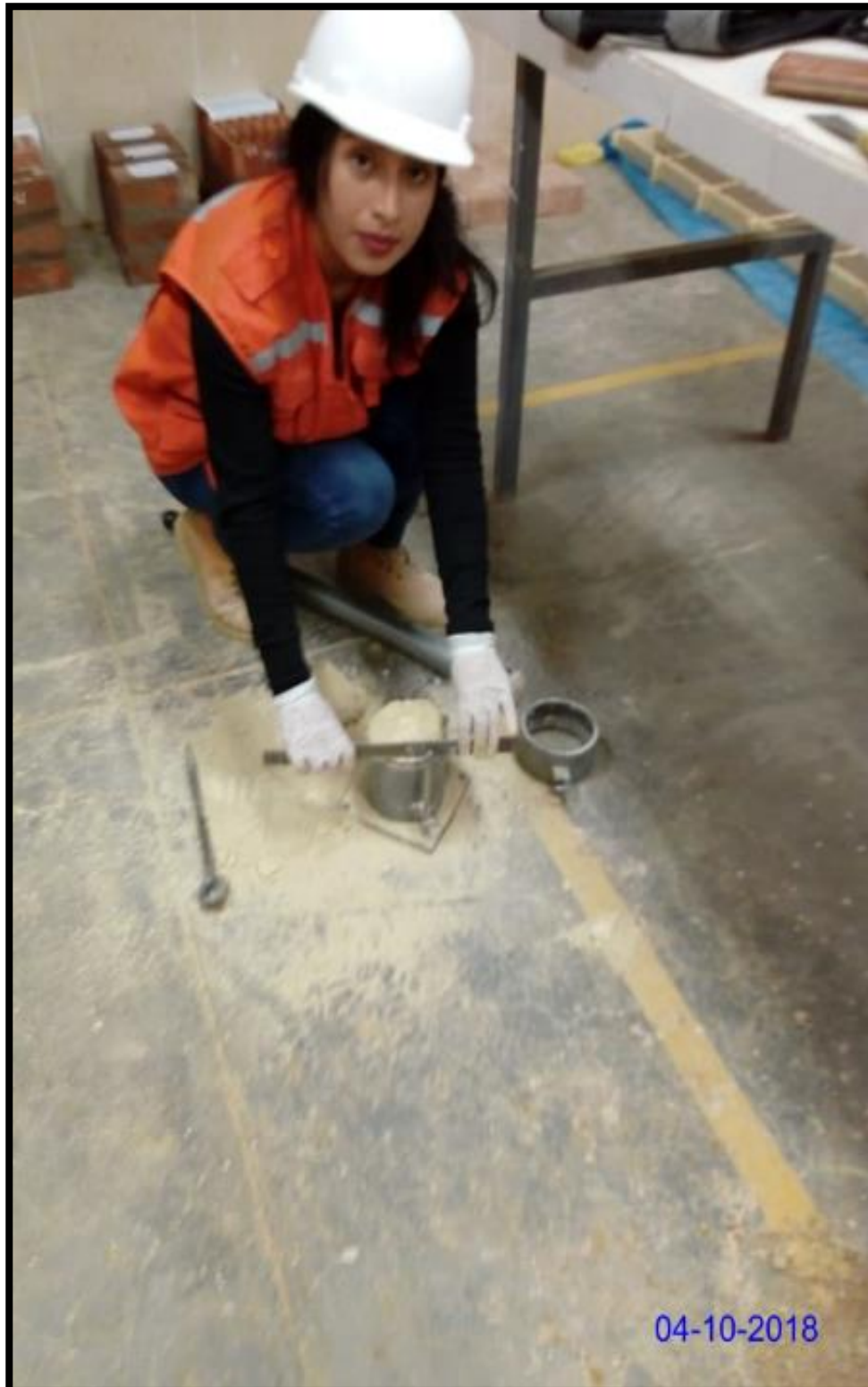
Fotografía N° 17: Enrazando para el ensayo de proctor modificado método A, para la muestra patrón.
