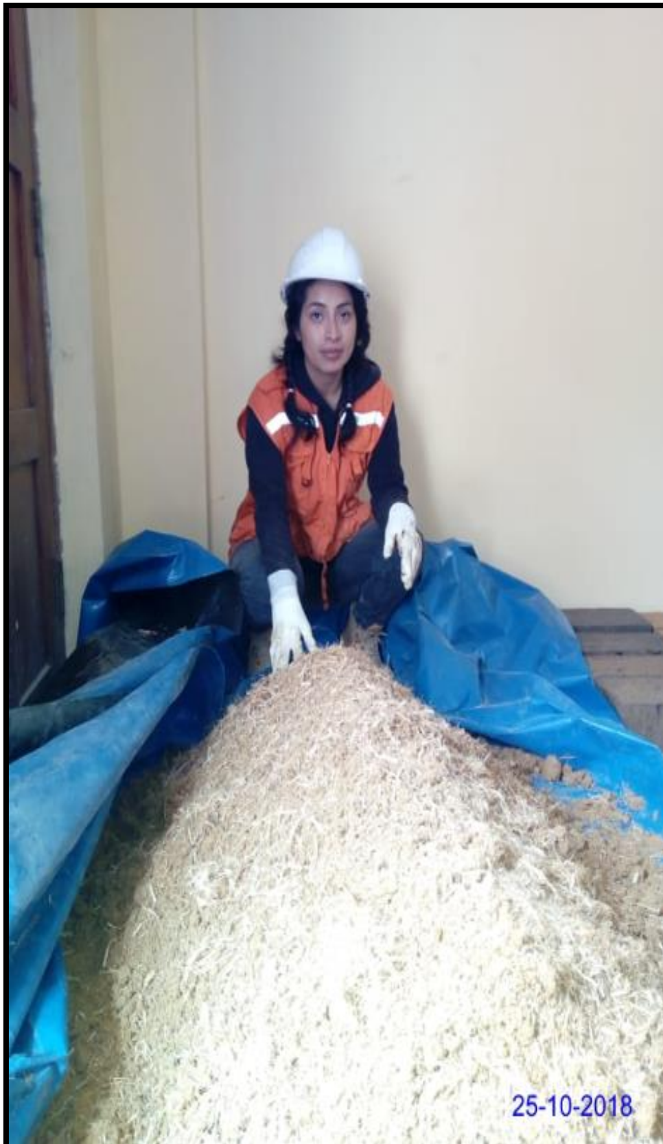
Fotografía N° 26: Mezclando la tierra con la fibra de coco.
