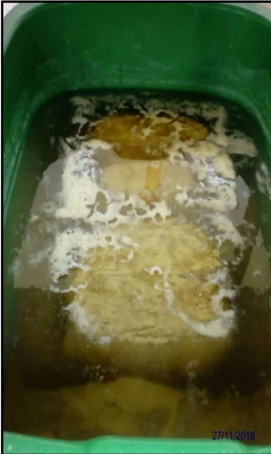
Fotografía N° 39: Muestra con incorporación de fibra de coco sumergido en la tina con agua
