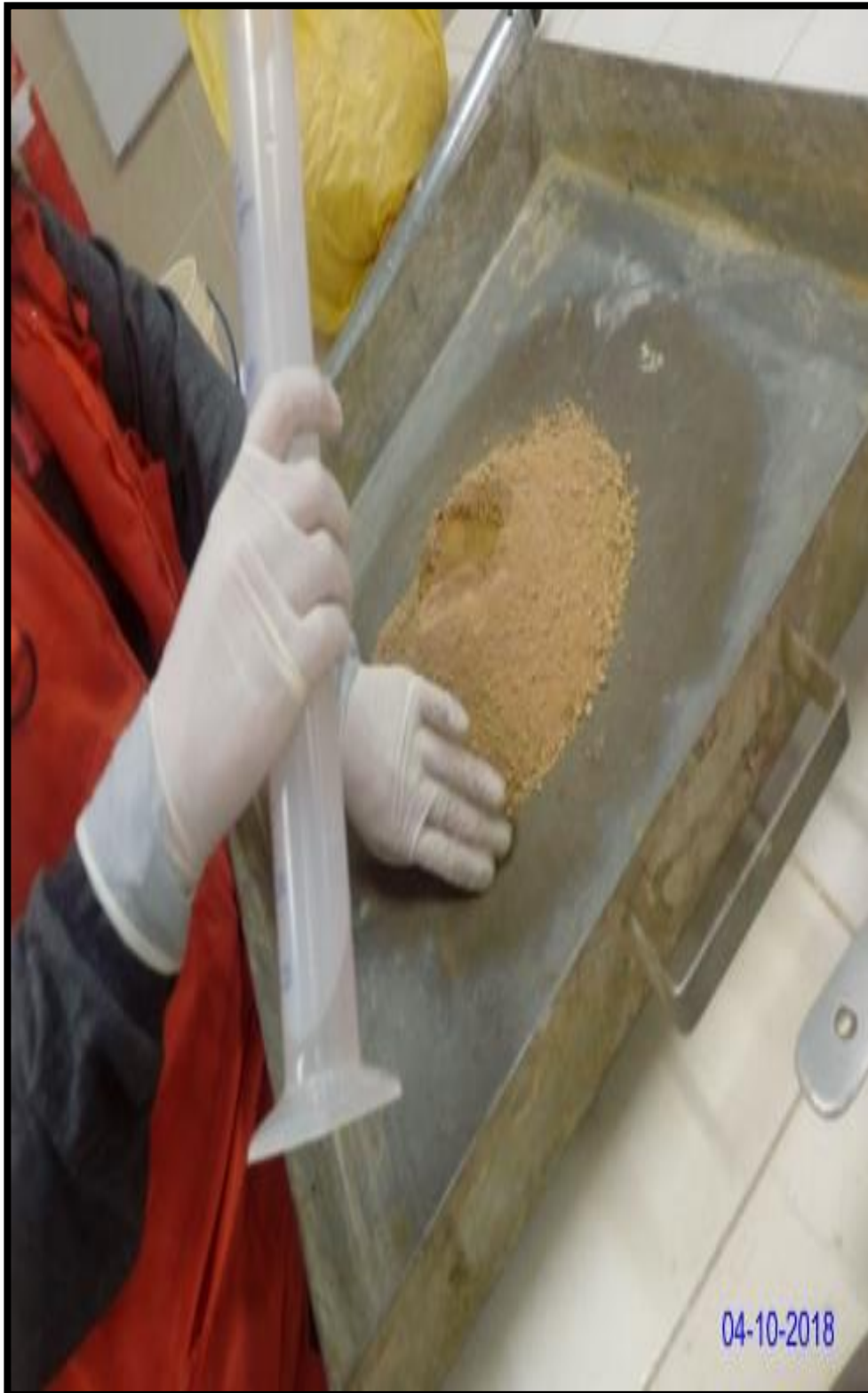
Fotografía N° 16: Mezclando la tierra con el porcentaje de agua, para el ensayo de proctor modificado método A, para la muestra patrón.
