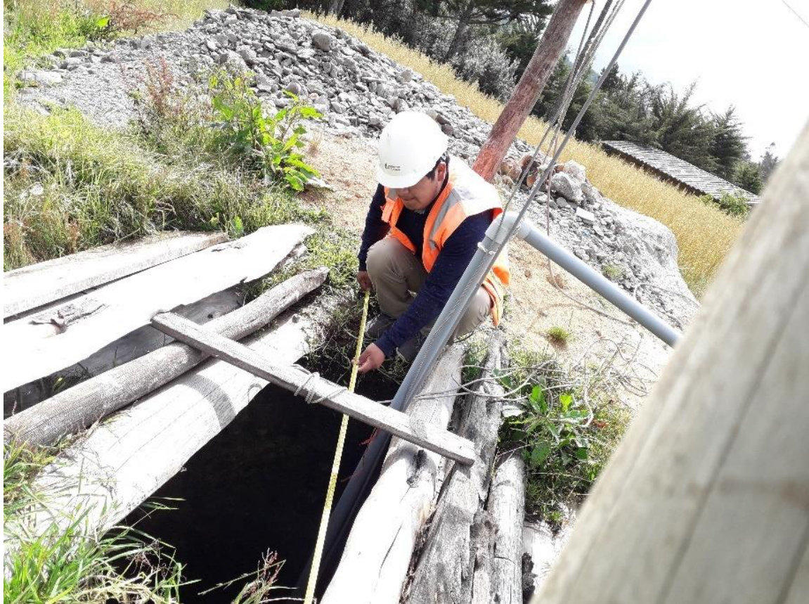
Imagen 3: Medidas geométricas de pozo tubular.
