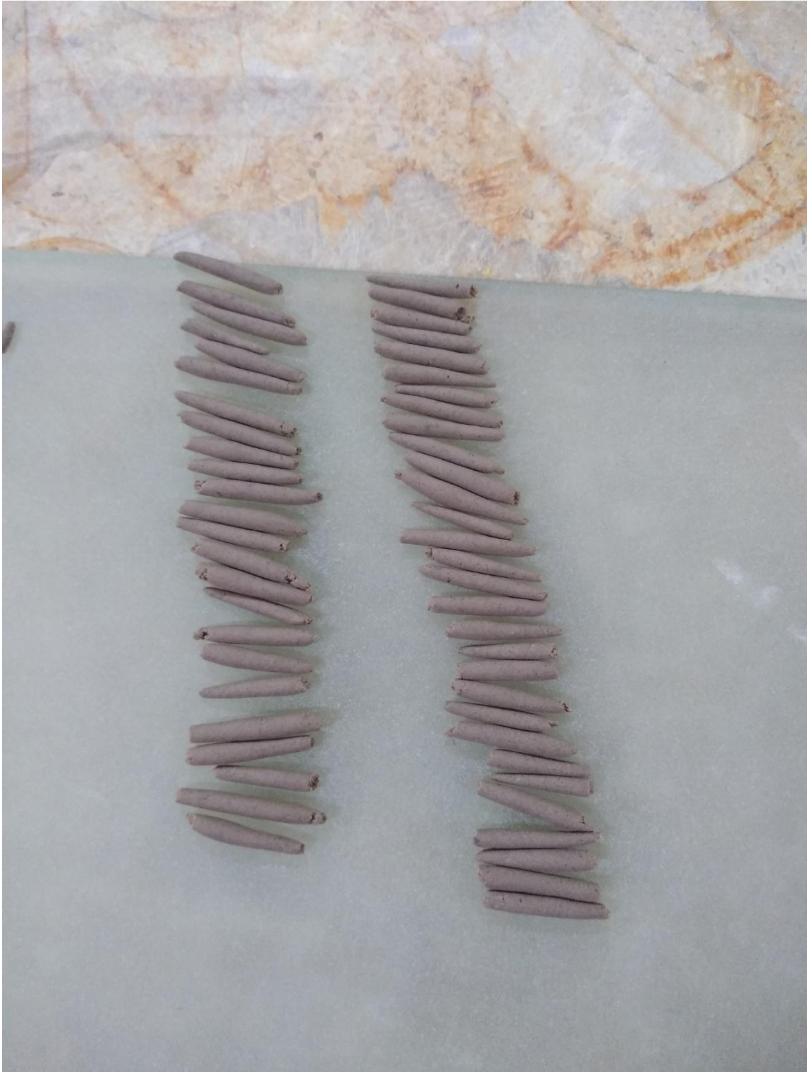
ANEXO 35: Muestras de 3 mm. de diámetro para obtener limite plástico.
