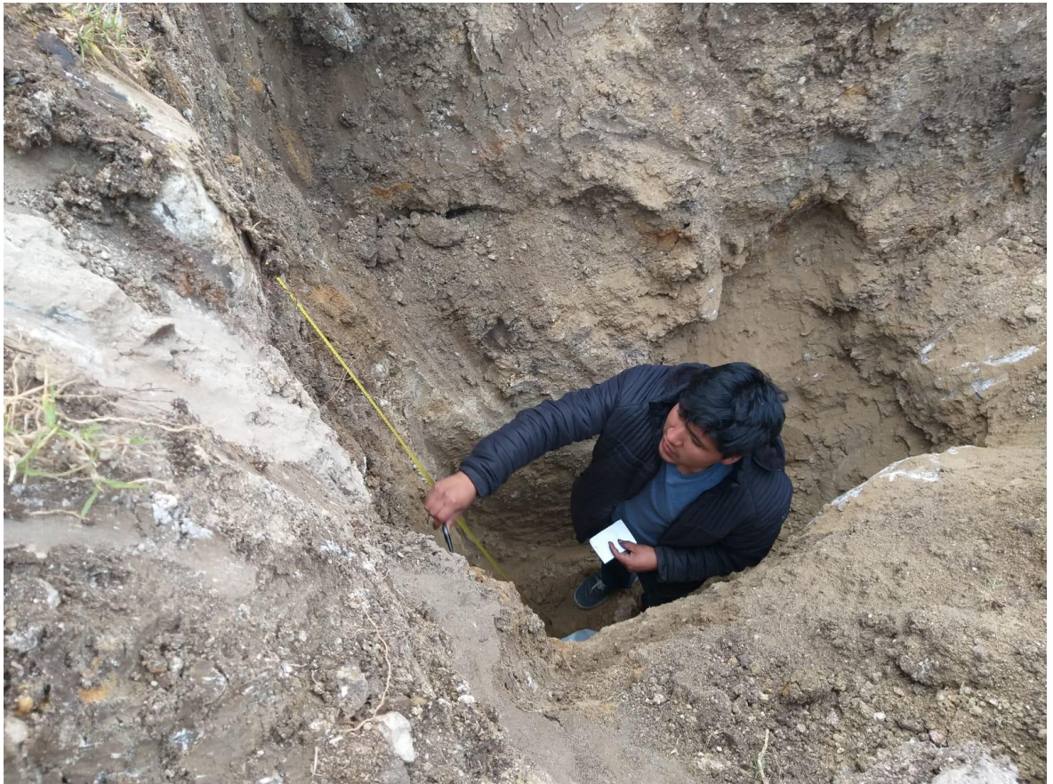
Figura 23: Calicata para obtener muestra del suelo
