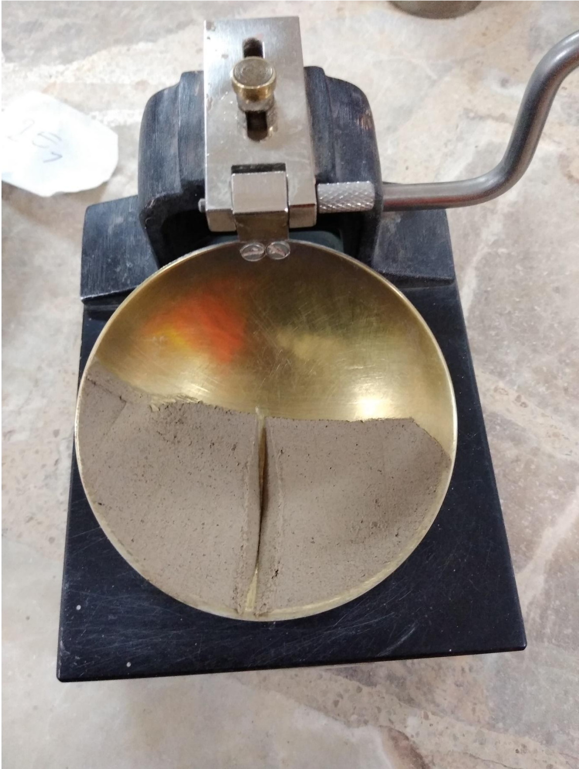
ANEXO 34: Muestra de suelo en la copa de Casagrande, para obtener limite líquido.
