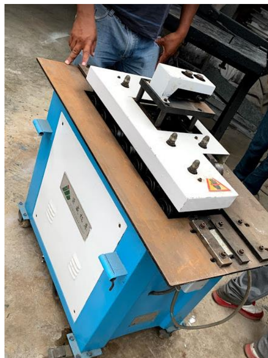
Imagen 2, Doblado de pestañas con Lockformer.
