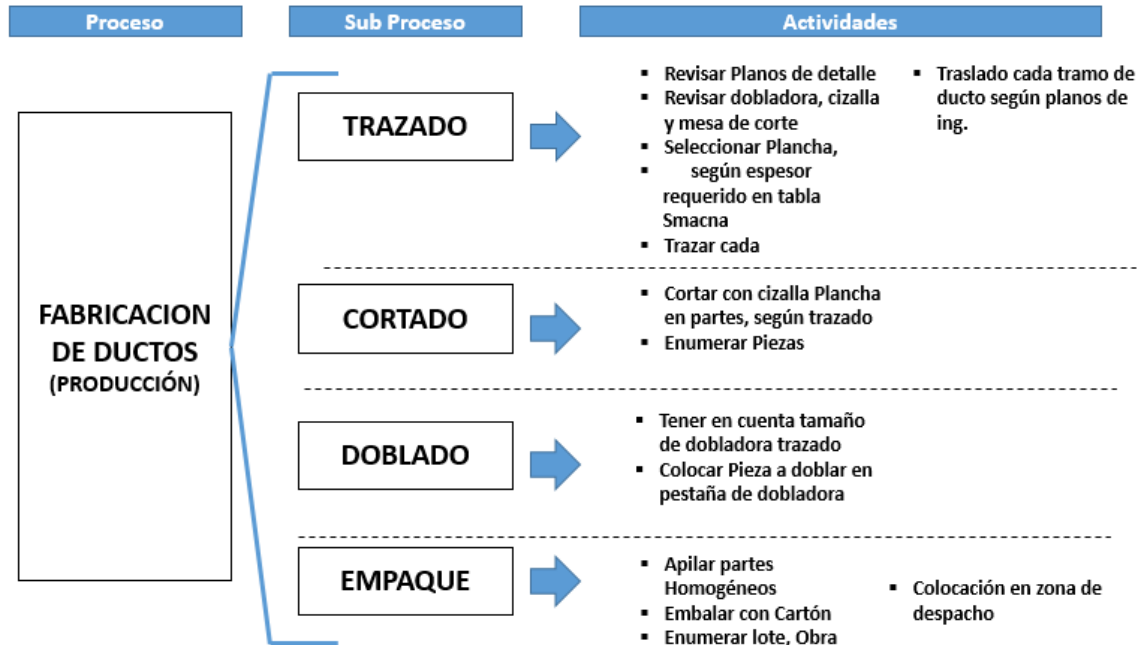
Figura 16, Actividades del proceso de fabricación de ductos.
