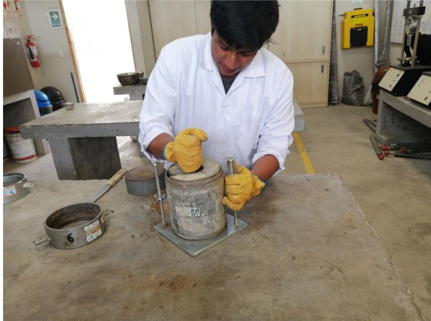
*Ilustración 36: Preparando la Muestra para Someterlo al Agua*
