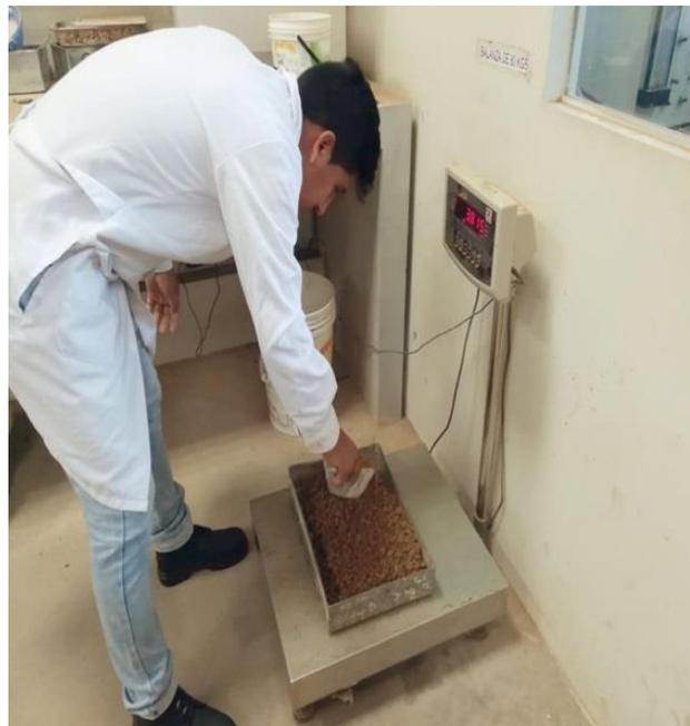
*Ilustración 19: Peso Volumétrico después de salir del secado*
