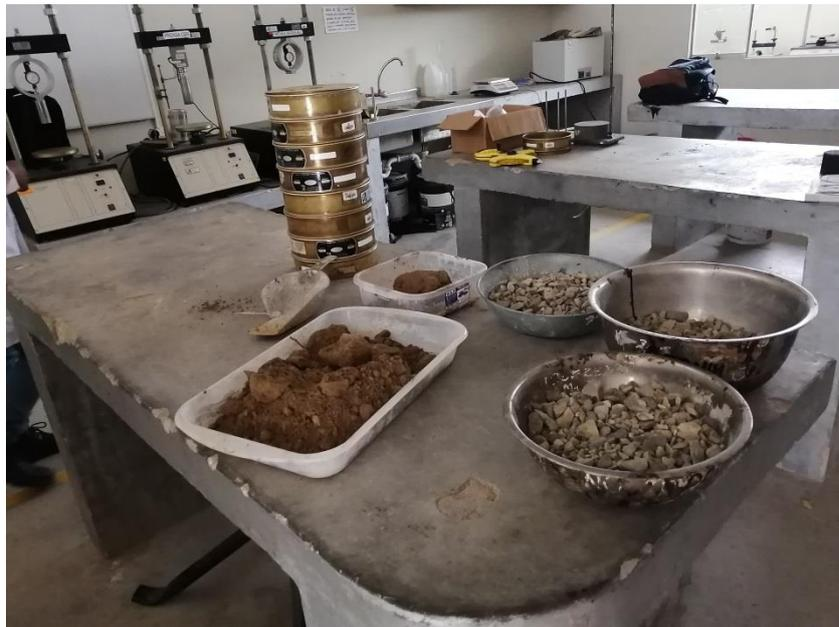
*Ilustración 21: Preparando el Material para realizar el ensayo de Granulometría*
