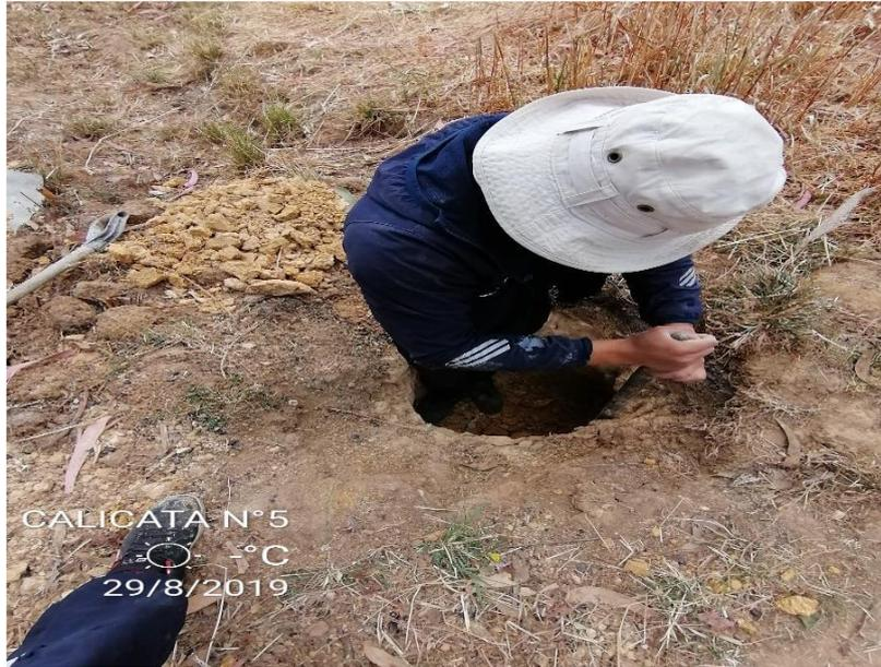
*Ilustración 14: Excavación de la Calicata N° 5 Progresiva Km 23+500.*
