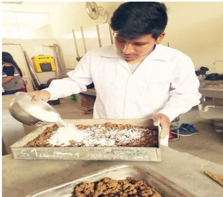
*Ilustración 33: Preparando Muestra para realizar el Ensayo de CBR con Cal Hidratada*
