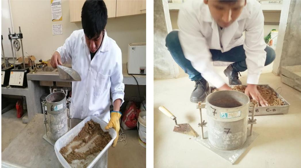
*Ilustración 32: Tesistas realizando los Ensayos de CBR de cada una de las Muestras*
