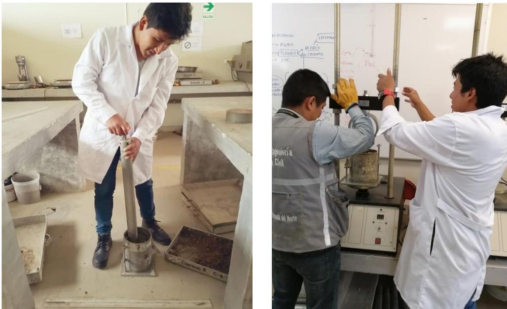
*Ilustración 8: Ensayo de CBR realizados para el suelo natural y con los dos aditivos*
