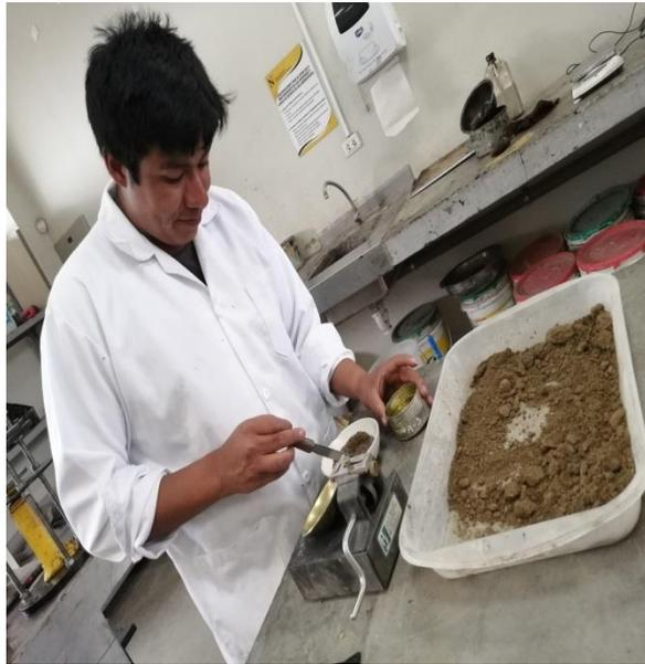
*Ilustración 5: Límite Líquido con Muestra Natural.*
