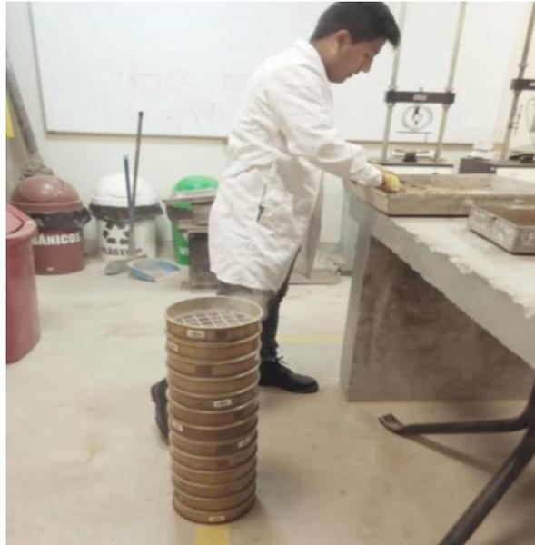
*Ilustración 23: Realizando el Ensayo de Granulometría*
