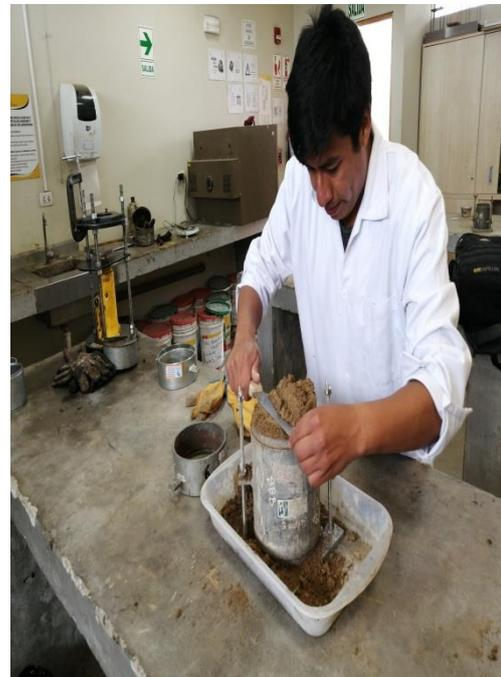
*Ilustración 35: Muestra Compactada Lista y Enrasado*
