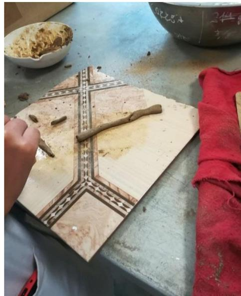
*Ilustración 27: Ensayo de Limite Plástico de cada Muestra*
