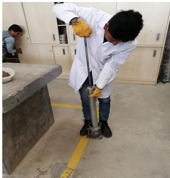
*Ilustración 29: Ensayo Proctor*
