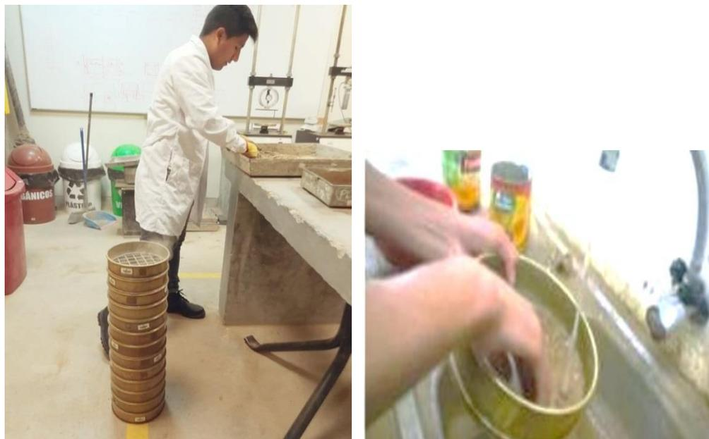
*Ilustración 4: Análisis Granulométrico de Suelos por Tamizado-Lavado Malla #200*
