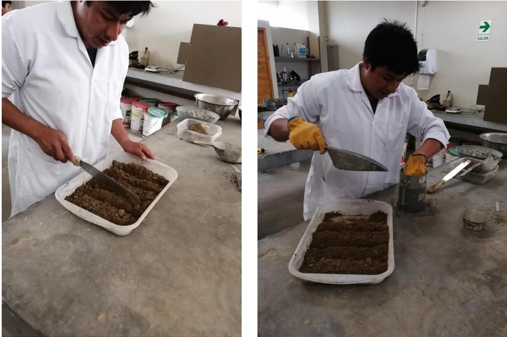
*Ilustración 28: Muestra para realizar el Ensayo de Proctor*
