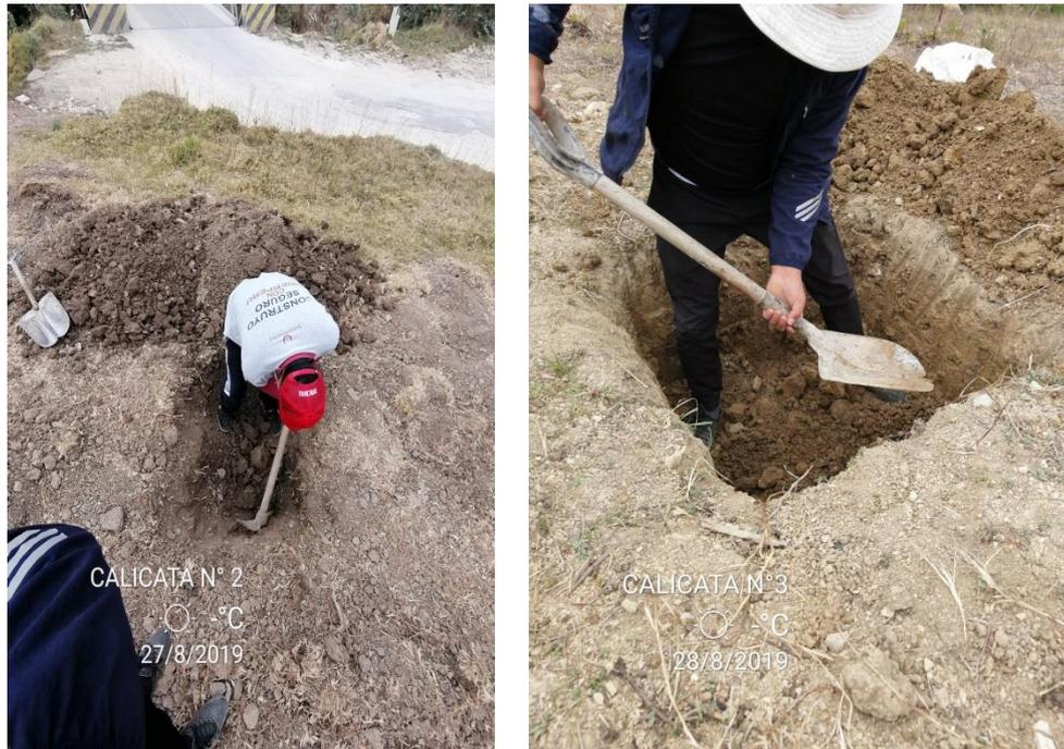
*Ilustración 2: Excavación de las Calicatas*
