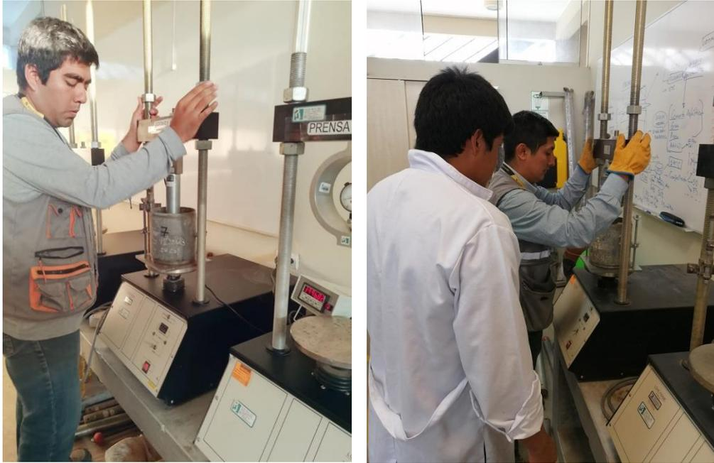
*Ilustración 40: Realizando la Compresión de las Muestras*
