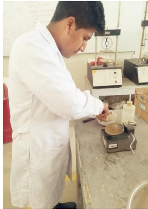
*Ilustración 26: Tesistas realizando el Ensayo de Limite Liquido*
