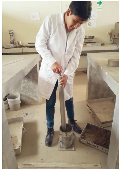
*Ilustración 34: Tesistas realizando la compactación de las Muestras Obtenidas*
