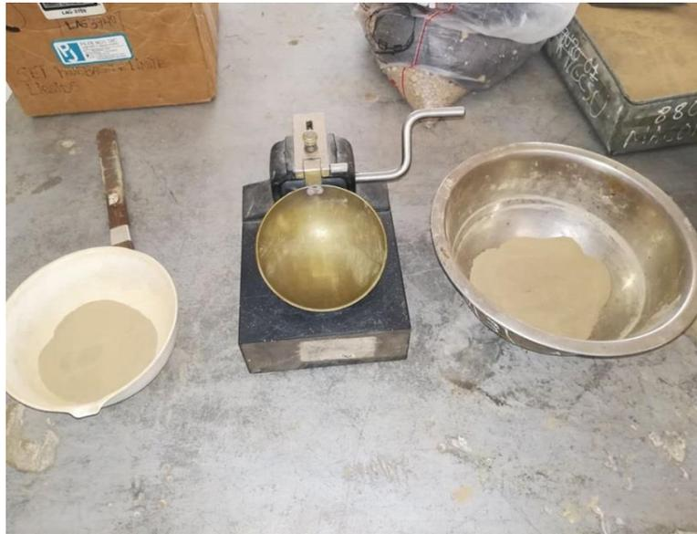
*Ilustración 24: Equipos para desarrollar el Ensayo de Limite Liquido*
