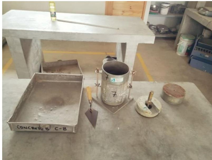
*Ilustración 31: Equipos para realizar los Ensayo de CBR*
