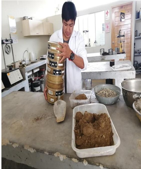
*Ilustración 22: Tesista realizando el ensayo de Granulometría*
