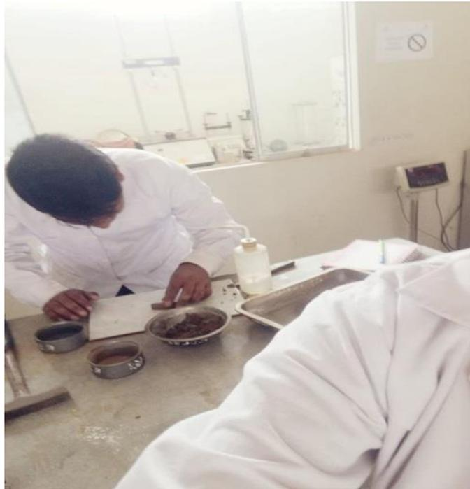
*Ilustración 6: Limite Plástico de Cada Muestra.*
