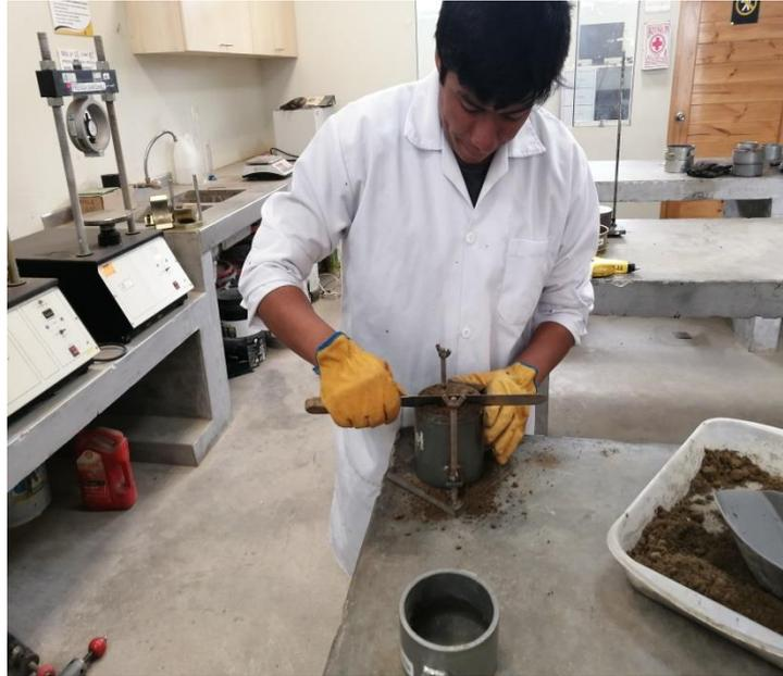
*Ilustración 30: Realizando el Enrazado luego de ser compactado*
