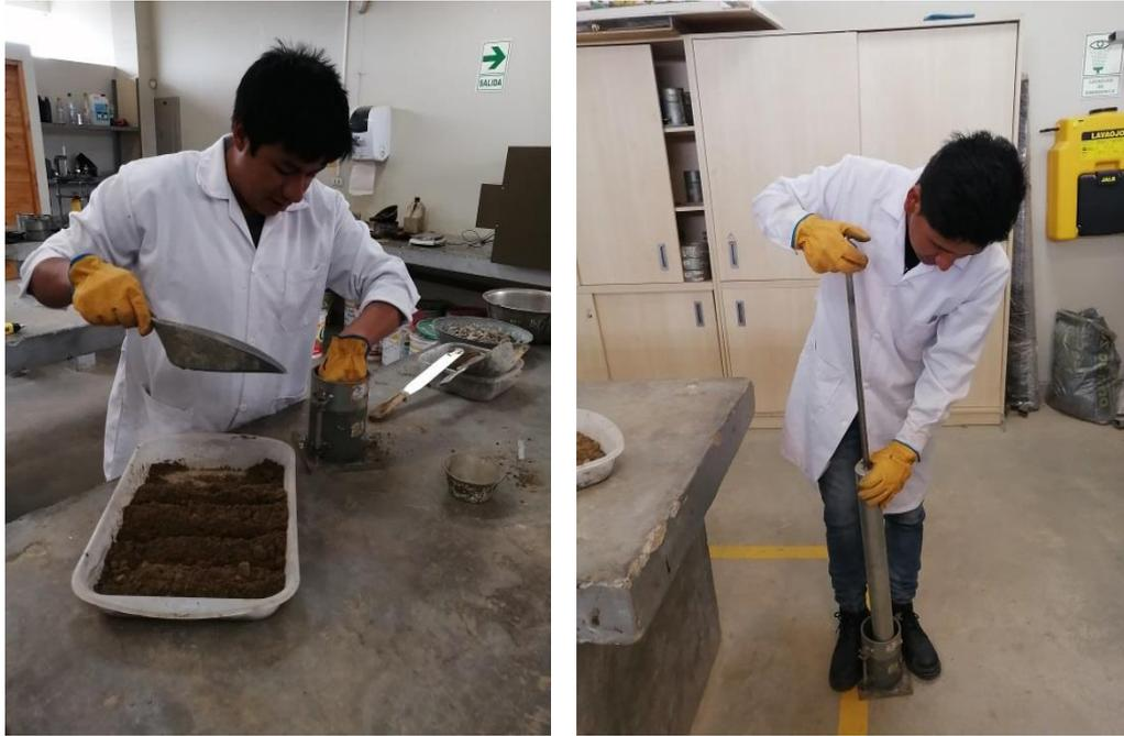
*Ilustración 7: Ensayo de Proctor Modificado del Suelo en estado natural*
