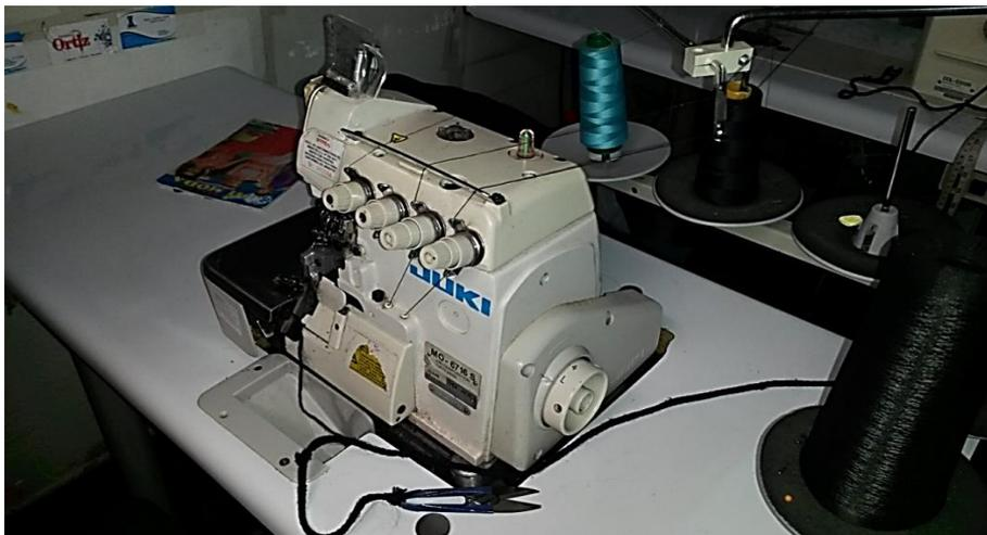
Figura 10. Máquina remalladora de la empresa IISAC
