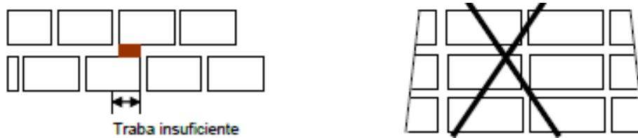
Fig. 7 y 8: (izquierda) Adobes de cabeza, (Derecha) Las juntas verticales no deben coincidir. (Morales, Torres, Rengifo, & Irala, 1994)
