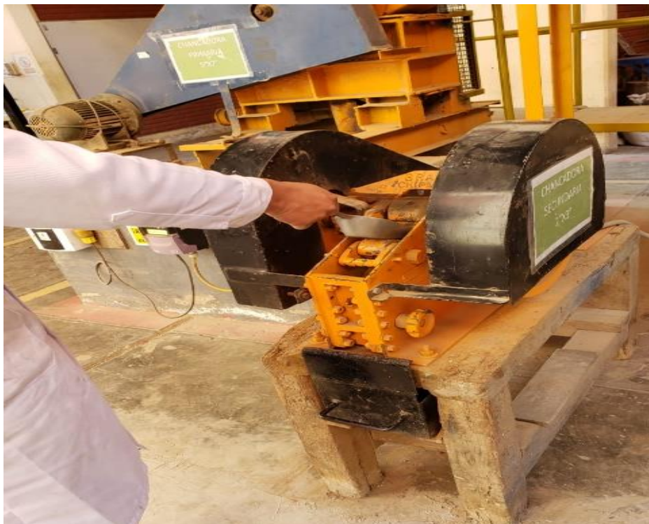
Figura 13. Conminución del Mineral a Malla #-10.
