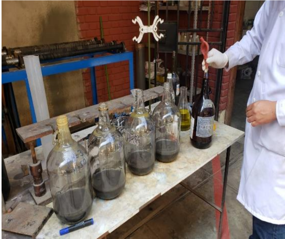
Figura 20. Preparación de solución con 1.5 g/L de tiourea, 500 ml de agua, 250 g de muestra y ácido sulfúrico a diferentes pH.
