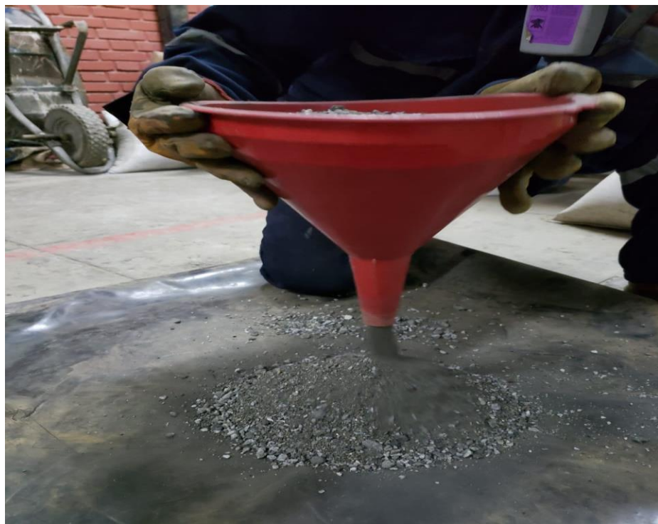
Figura 15. Homogenizacion de la muestra por coneo, 3 Veces.
