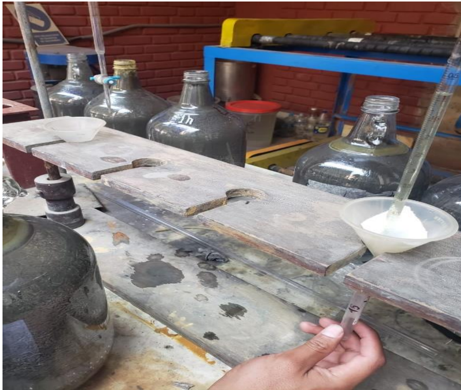
Figura 22. Retiro de solución a 24 h, (filtrado) para análisis ICP - OES.
