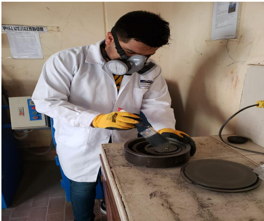
Figura 17. Conminución de la muestra al 80% a Malla #-200.
