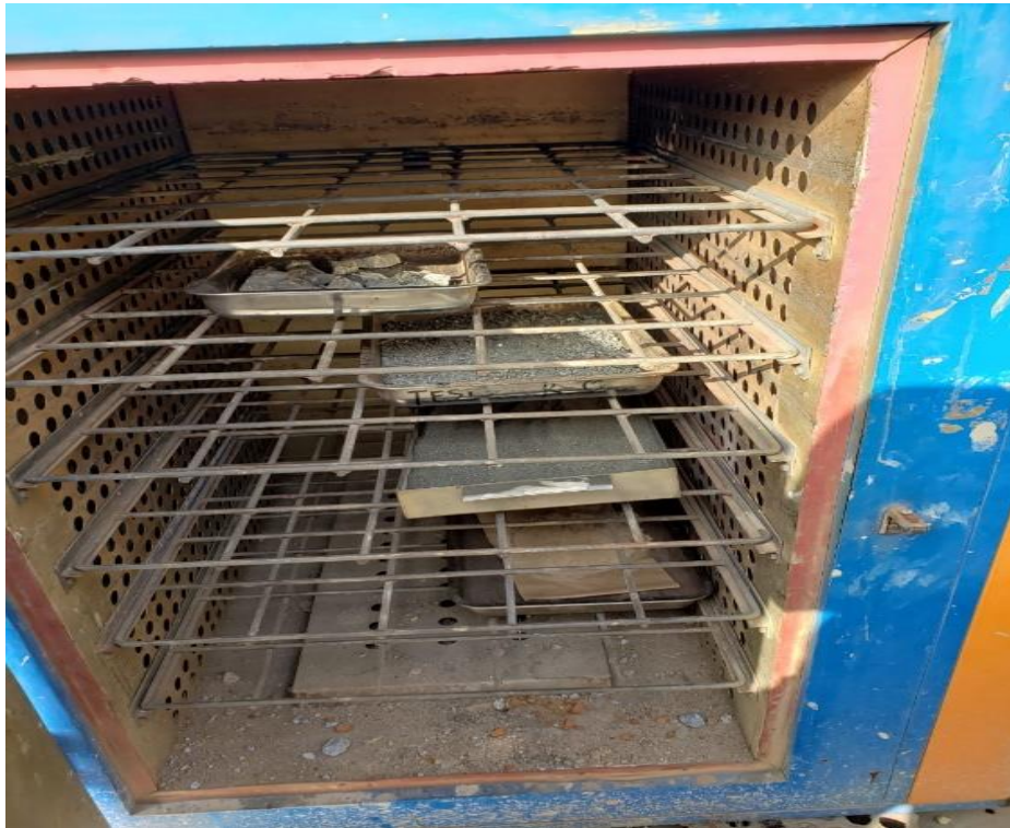
Figura 14. Secado del Mineral.
