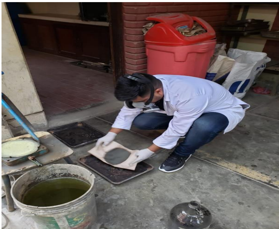
Figura 25. Puesta de fracción sólida (relave) en la bandeja de acero.
