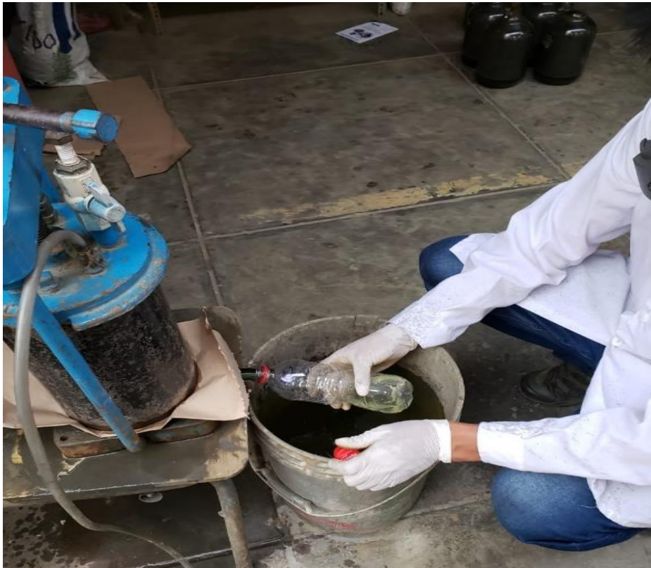
Figura 24. Filtrado de solución rica a 48h (filtro prensa).
