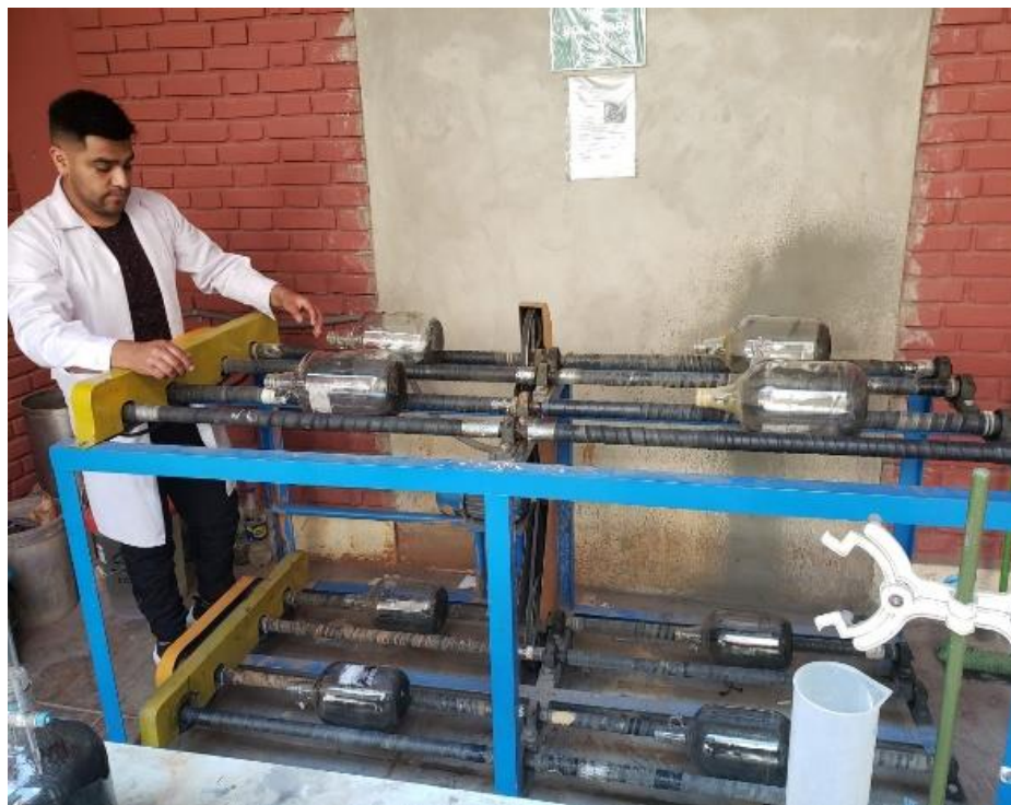
Figura 21. Lixiviación por agitación en botellas en la máquina roladora.
