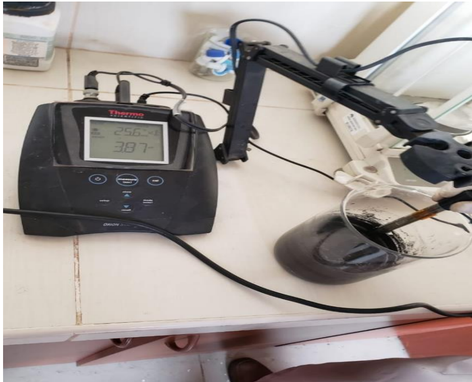
Figura 18. Medición pH de cada vaso de precipitados con oxidantes.
