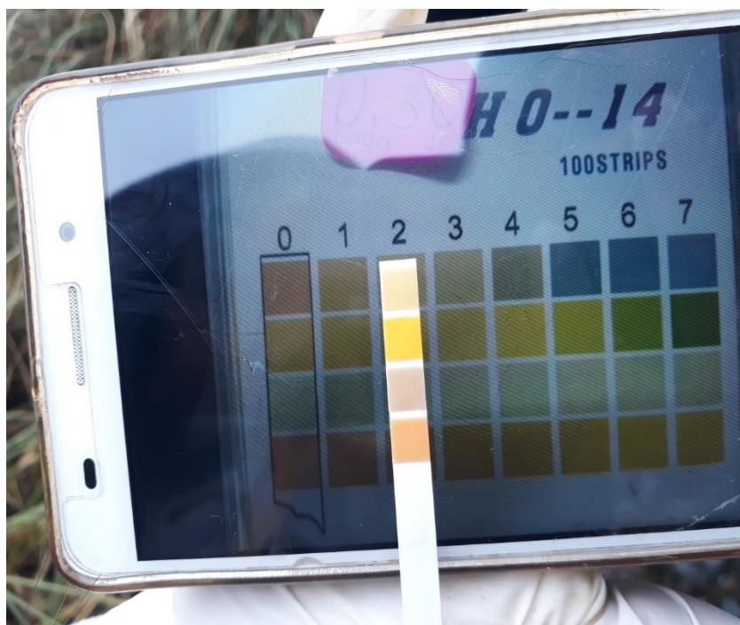
Ilustración 4: pH inicial de la muestra base comparado con las cintas Merck.
