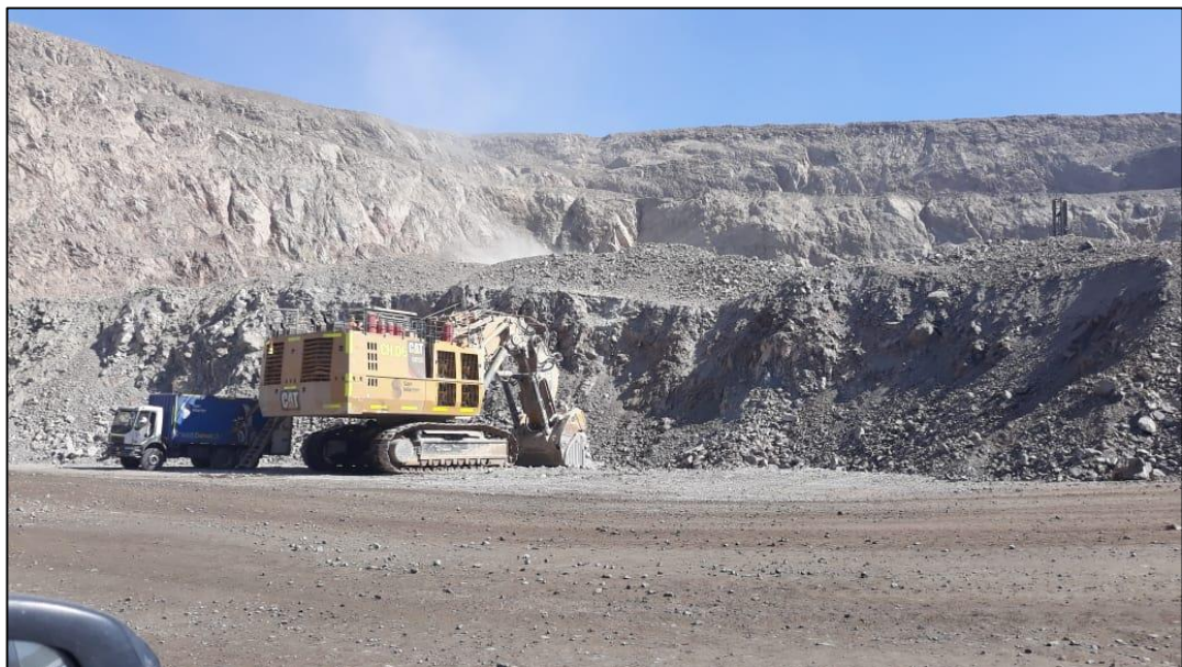
Figura 11. Pala CH-06 CAT6040 de la empresa San Martín en minera Shougan Hierro Perú.
