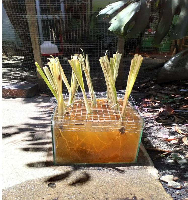
*Figura 25.* Fotografía del modelo hidropónico experimental para el tratamiento del efluente minero.
