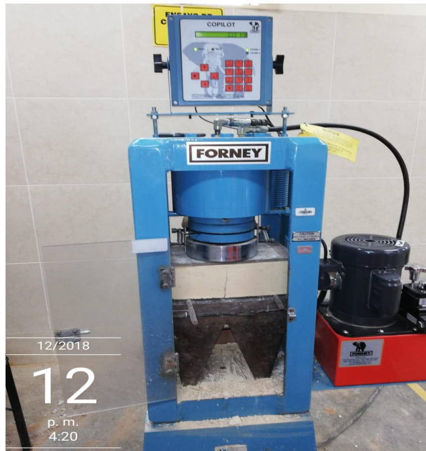
Figura 9. Ensayo de resistencia a la flexión del adobe compactado en laboratorio
