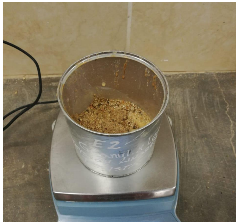
Figura 6. Ensayo de granulometría por lavado
