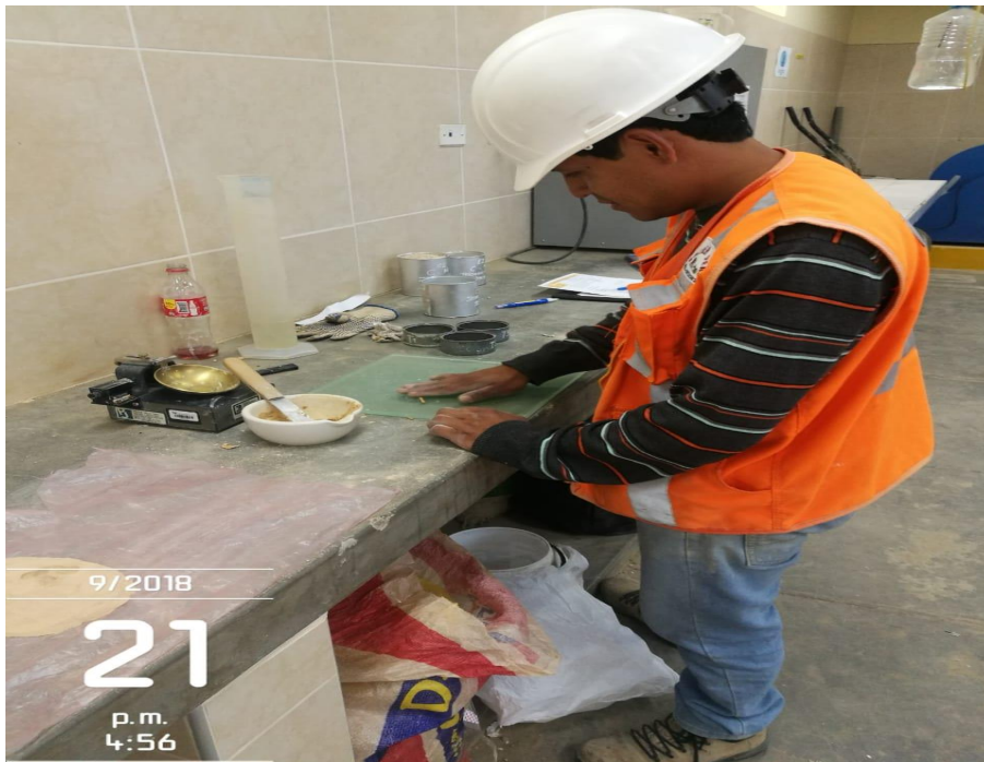
Figura 15. Realizando el ensayo de límite plástico
