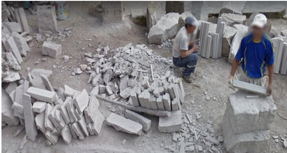
Figura 3. Piedra granito usada en la cantería
