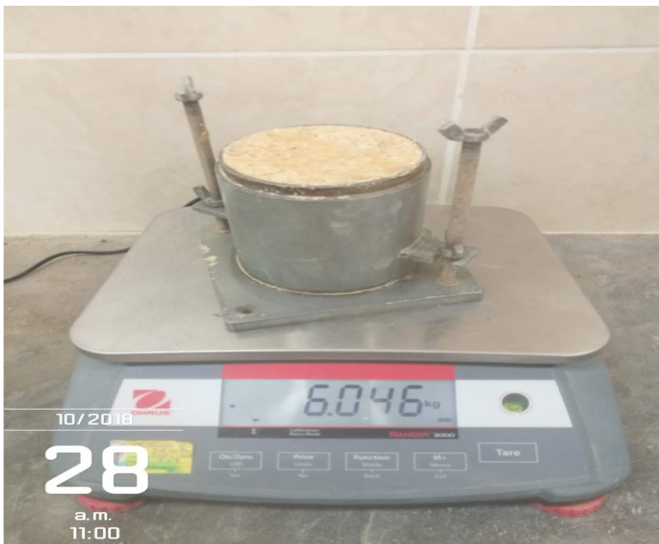
Figura 20. Proctor con 18% de contenido de agua y % de cantería triturada
