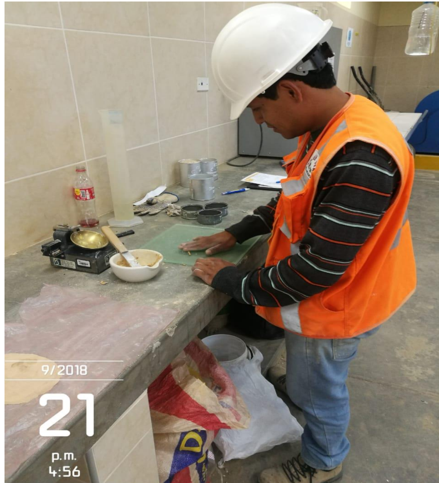
Figura 5. Ensayo límite plástico
