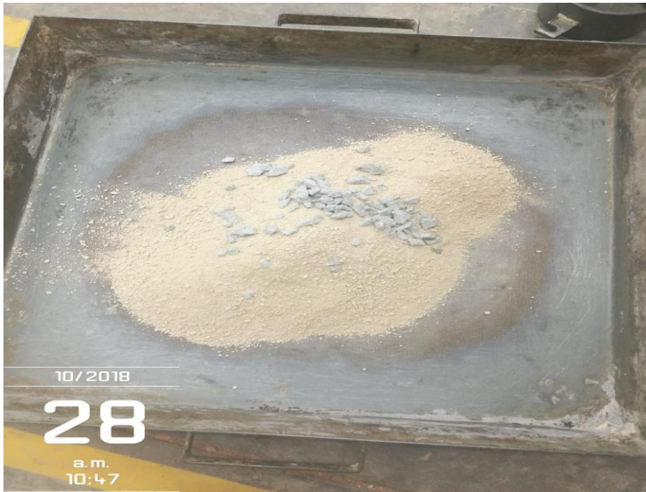
Figura 19. Muestra de tierra + muestra de granito 5% de cantería triturada
