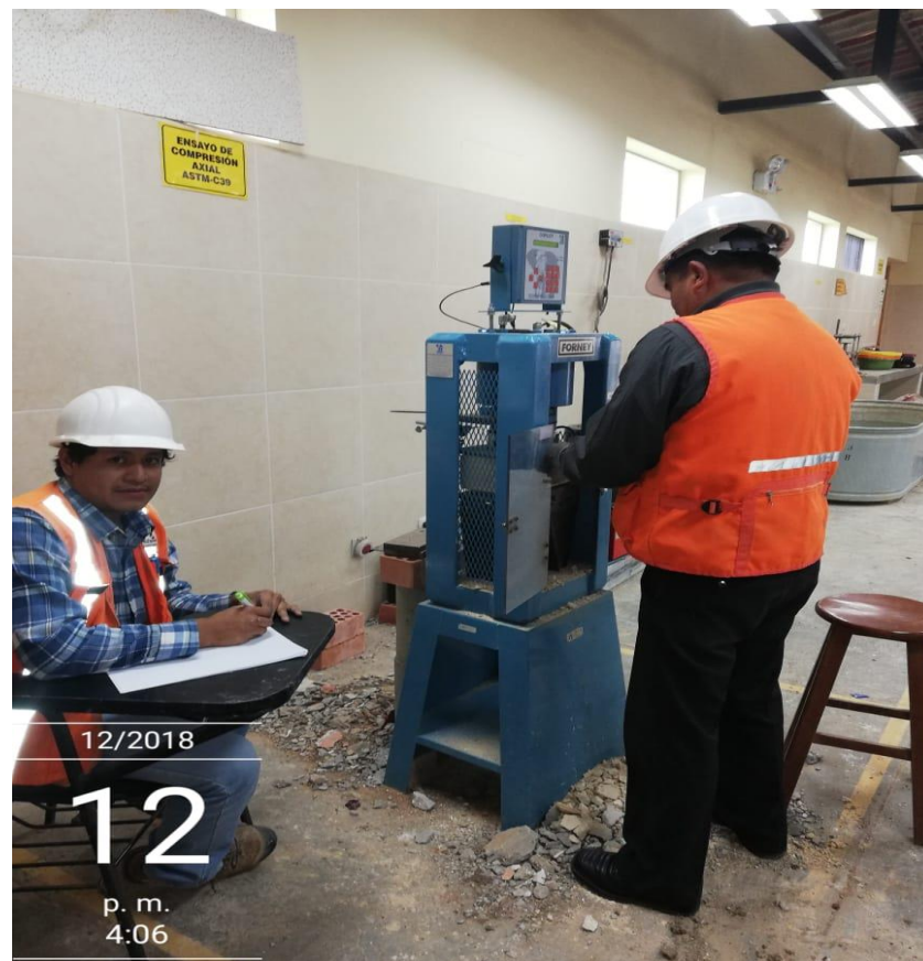
Figura 10. Ensayo a compresión del adobe compactado en laboratorio
