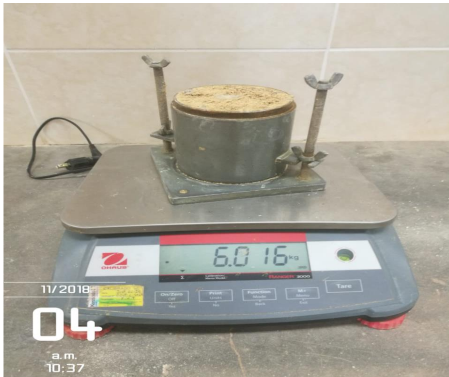
Figura 23. Proctor con 20% de contenido de agua y 15% de cantería triturada
