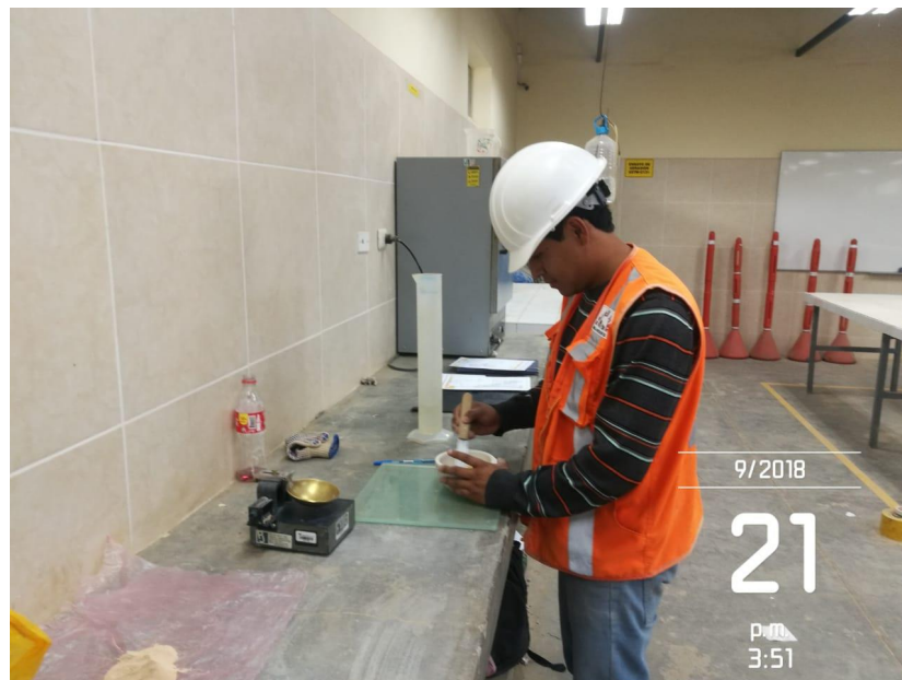
Figura 4. Ensayo límite líquido
