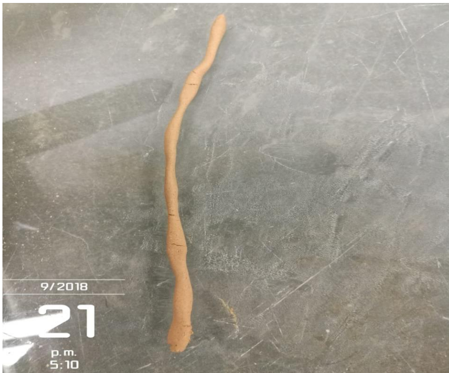
Figura 16. Muestra de límite plástico, lista para ser pesada y llevada al horno
