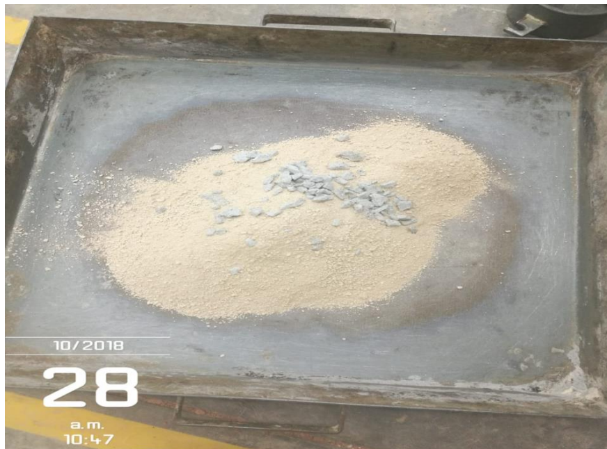
Figura 7. Material preparado para ensayo de compactación proctor
