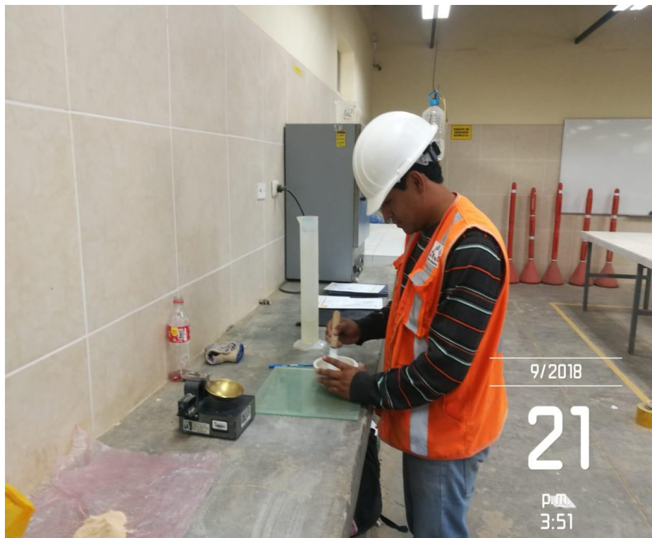
Figura 14. Mezcla para ensayo de límite líquido
