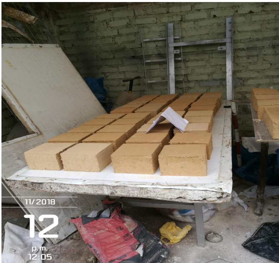
Figura 26. Adobe elaborados para el ensayo a compresión
