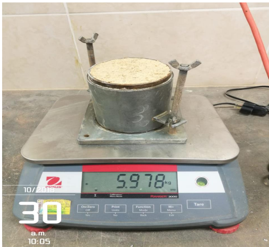
Figura 22. Proctor con 16% de contenido de agua y 10% de cantería triturada
