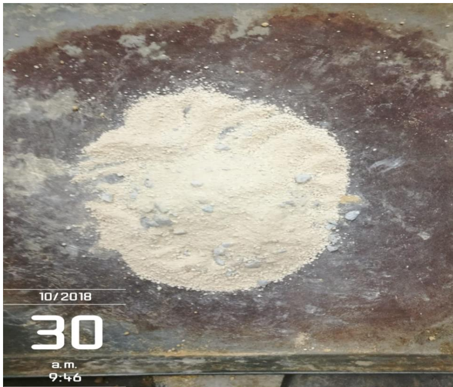
Figura 21. Muestra de tierra + muestra de granito 10% de cantería triturada
