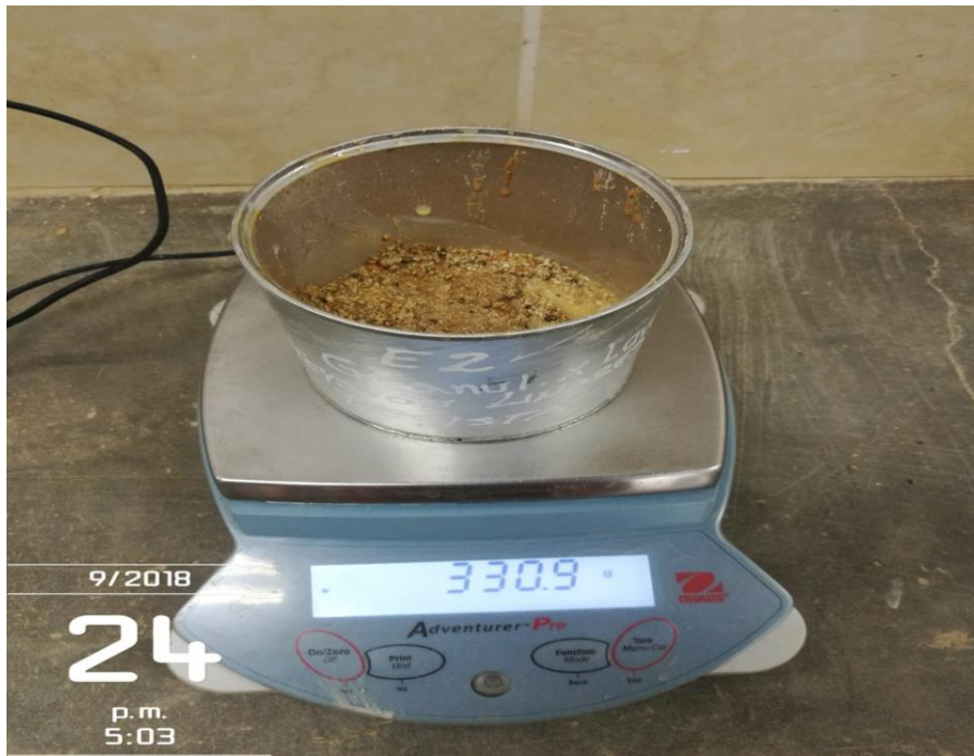
Figura 17. Muestra lavada por la malla N° 200, ensayo granulometría mediante tamizado por lavado
