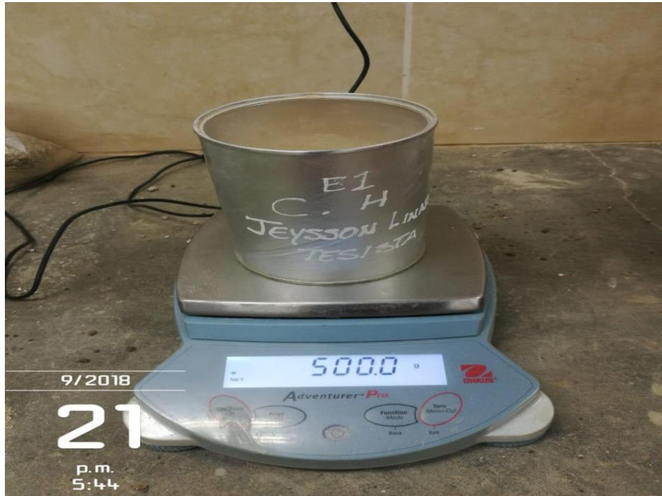
Figura 13. Pesando muestra de arcilla en estado natural para contenido de humedad
