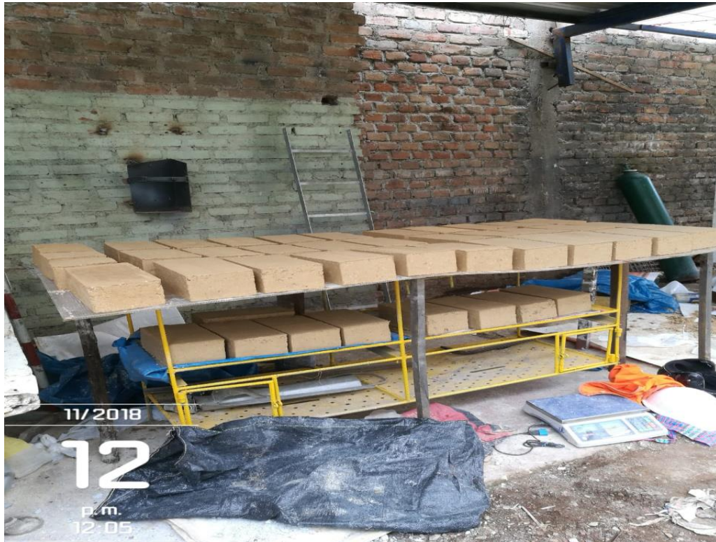
Figura 27. Adobes elaborados para ser sometidos al ensayo a flexión.
