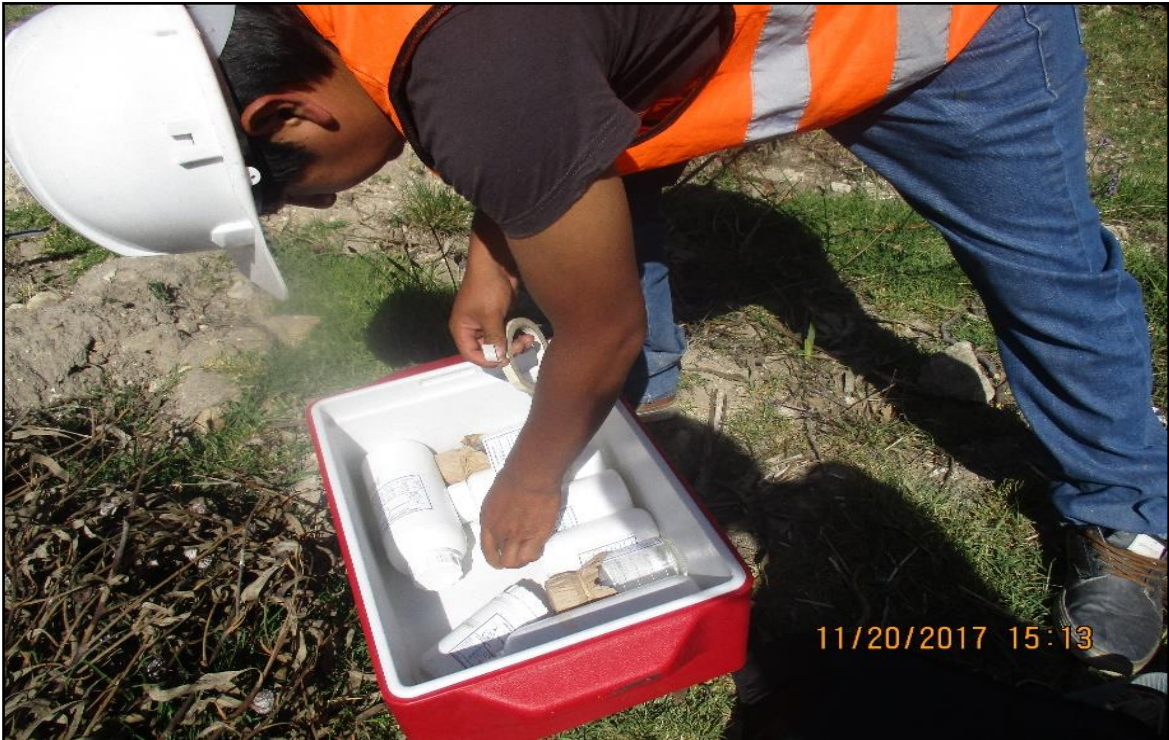
Figura 45: Ordenamiento de las muestras que no sufran movimientos bruscos que alteren el resultado al ser transportadas al laboratorio.
