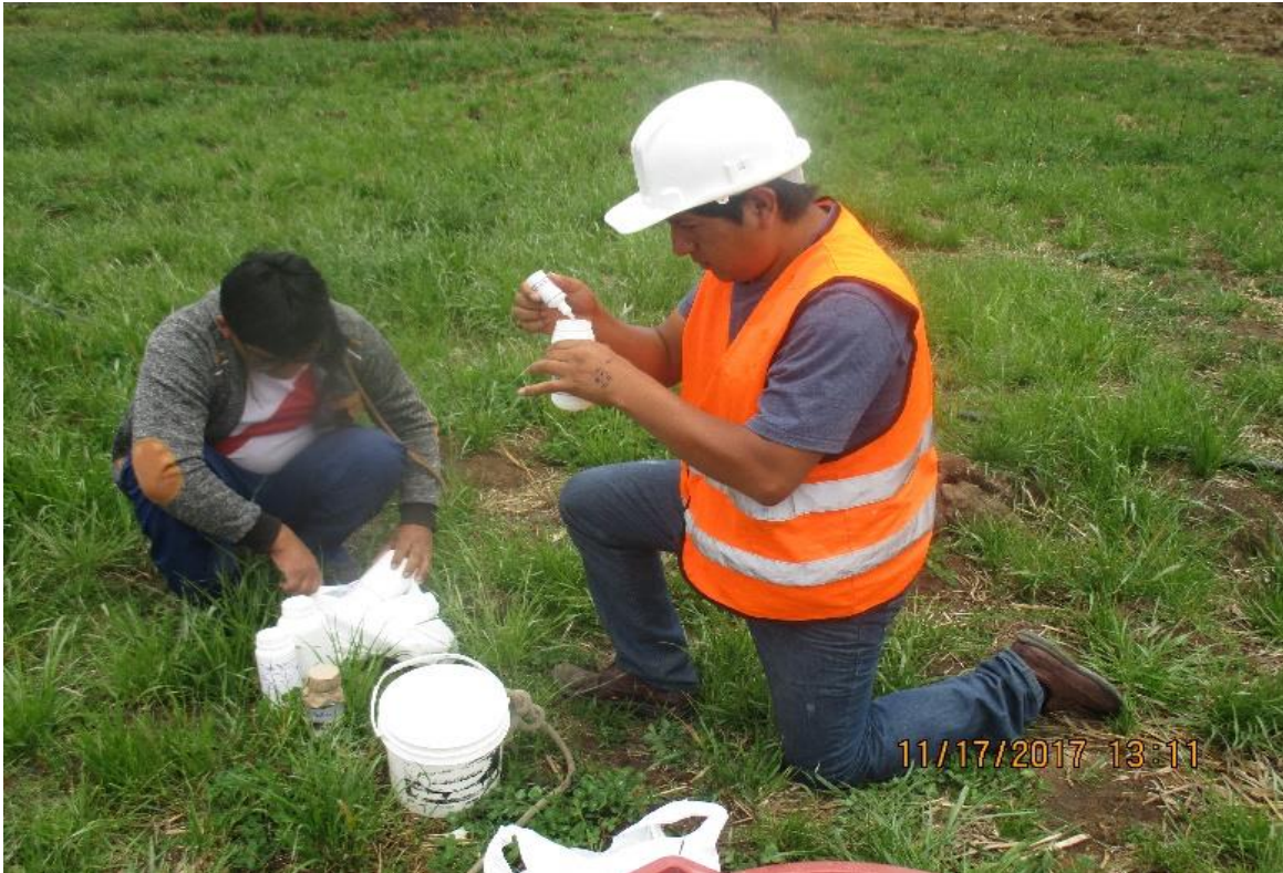
Figura 39: Colocación de conservantes a las muestras de agua extraído de los pazos subterráneos.
