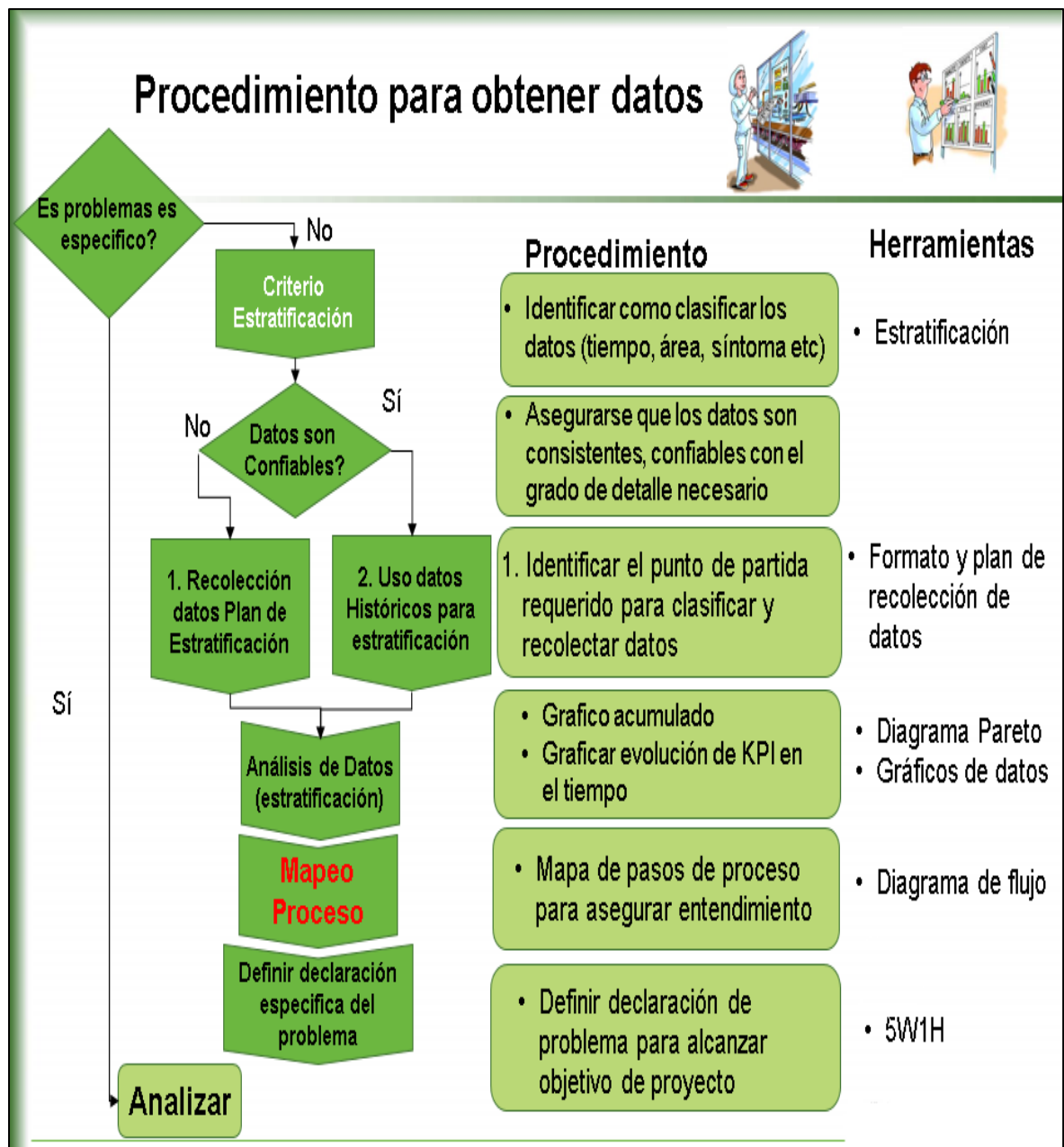
Figura 3: Procedimiento y herramientas para obtener datos de muestras
