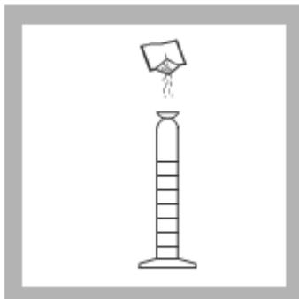
8. Se agregó el contenido de una almohada de polvo de reactivo de blanqueo 3 a los 25 ml restantes en el cilindro graduado de mezcla (el blanco). Tapamos el cilindro.
