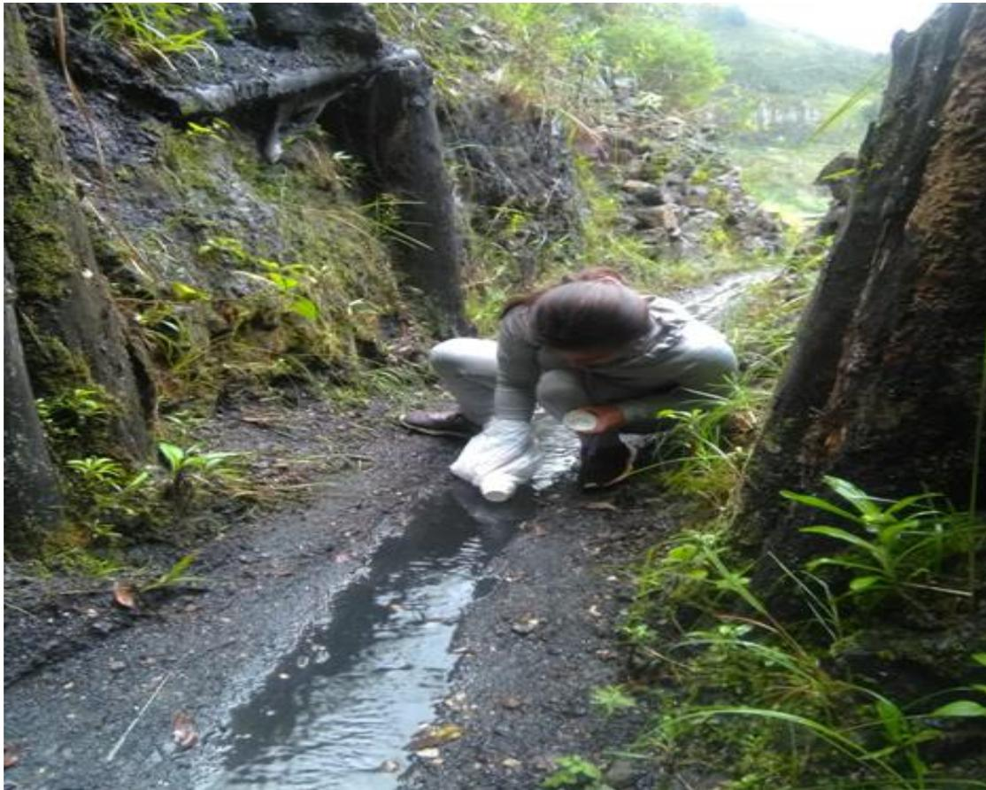
ANEXO N° 6. Análisis in situ con el multiparámetro en el efluente de la mina de Carbón.
