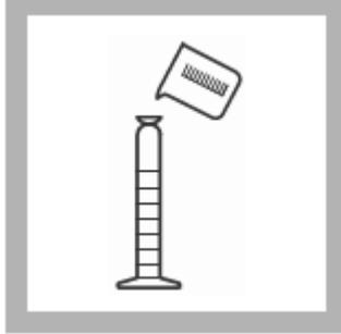
3. Se llenó un cilindro de mezcla graduado de 50 ml hasta la marca de 50 ml con muestra.
