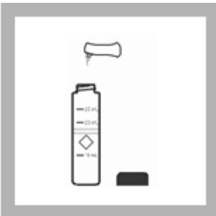
7. Se agregó el contenido de una almohada de solución de reactivo de hierro FerroZine a la celda (la muestra preparada). Se tapó y se invirtió para mezclar.
