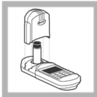
4. Se insertó la muestra del blanco en el soporte de la celda. Se cubrió bien la celda de muestra con la tapa del instrumento.
