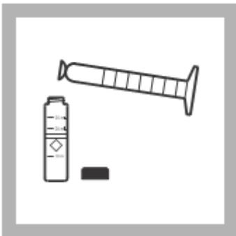
7. Se vertió 25 ml de mezcla en una celda de muestra de 25 ml (la muestra preparada).
