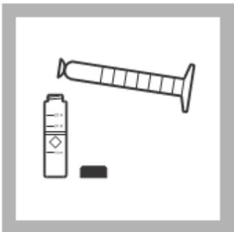
10. Se vertió los 25 ml de mezcla en el cilindro en una segunda celda de muestra de 25 ml (el blanco).
