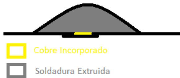
Imagen 23 Vista Frontal Soldadura Extruida
