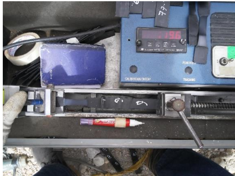
Imagen 30 Prueba de Desgarro en Campo
