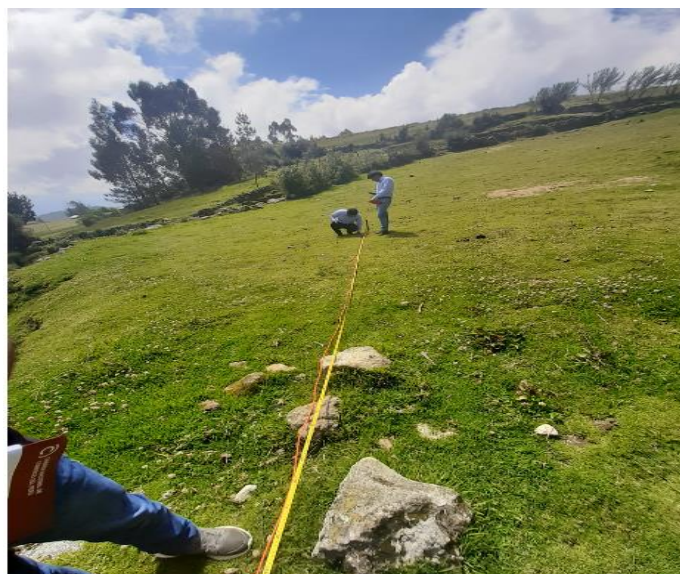
Figura 4. Alineamiento y distribuciones de los electrodos utilizados en el área de campo configuración Dipolo-Dipolo.
