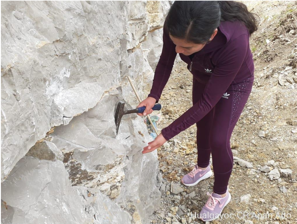
Figura 36. Toma de muestras del Yacimiento de calizas Apan Alto.
