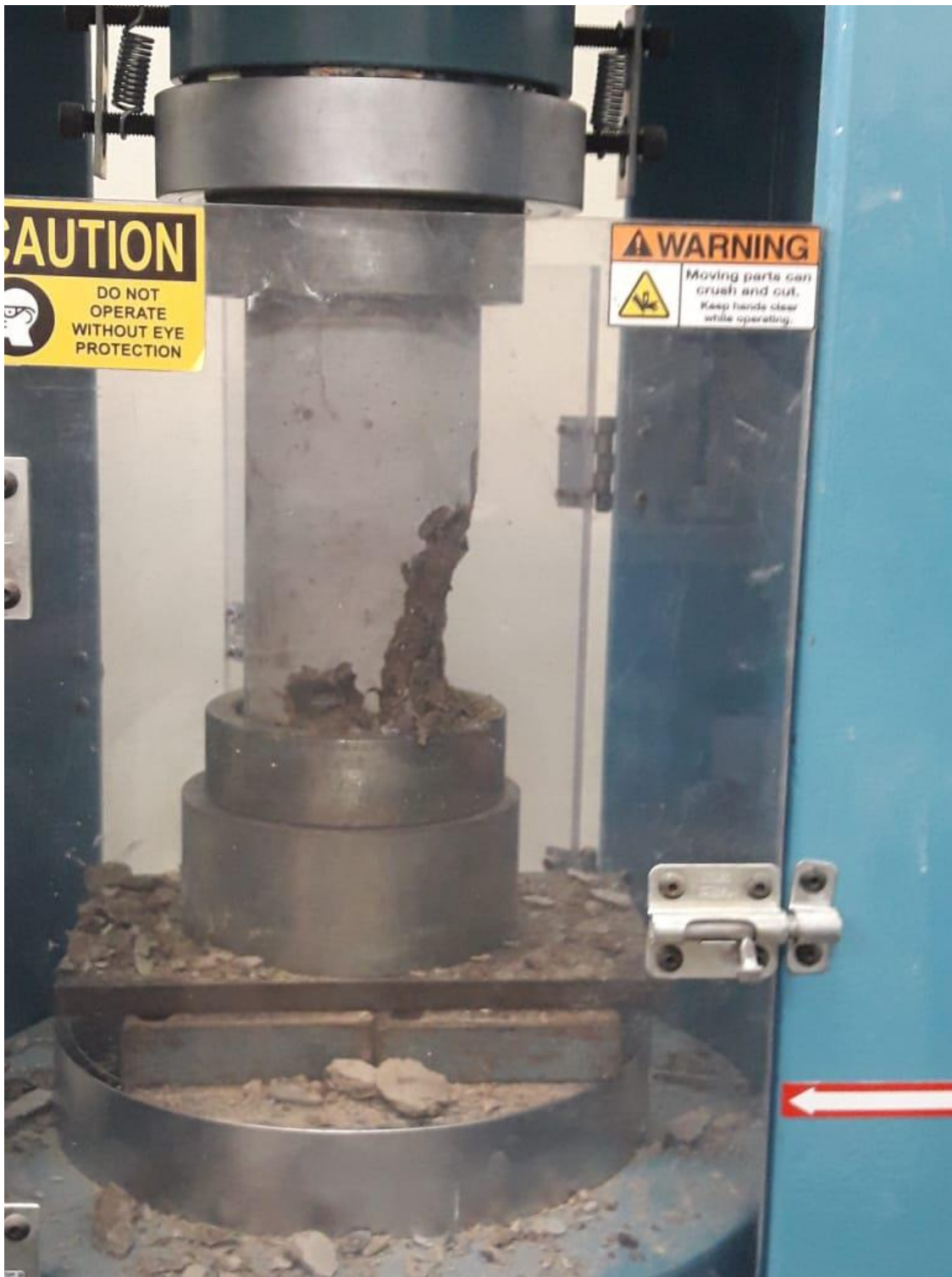
Ilustración 7 Rotura diagonal de probeta cilíndrica
