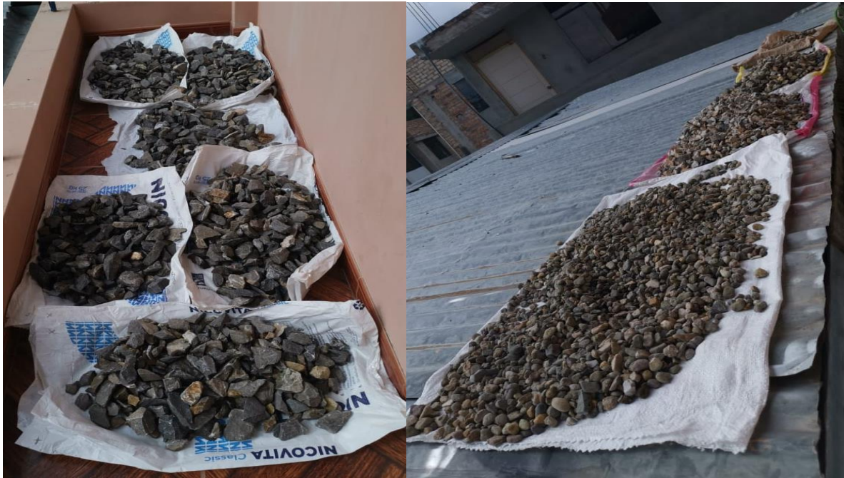
Figura 22: Secado de la piedra caliza y de piedra de río.
