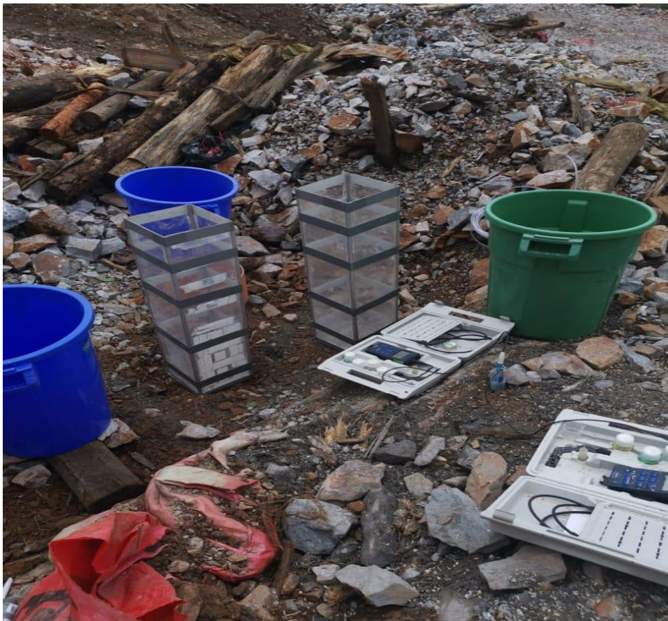
Figura 23: Tachos de agua, micas y multiparámetros para el sistema piloto
