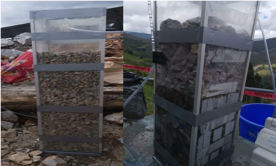
Figura 24: Filtro ascendente y alcalinizador respectivamente.
