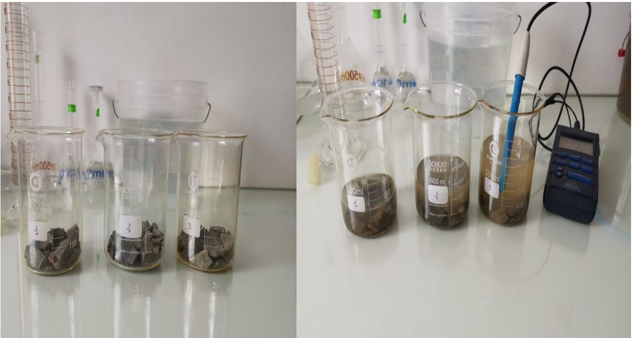
Figura 21: Proceso unitario, para aumentar el pH del efluente minero.
