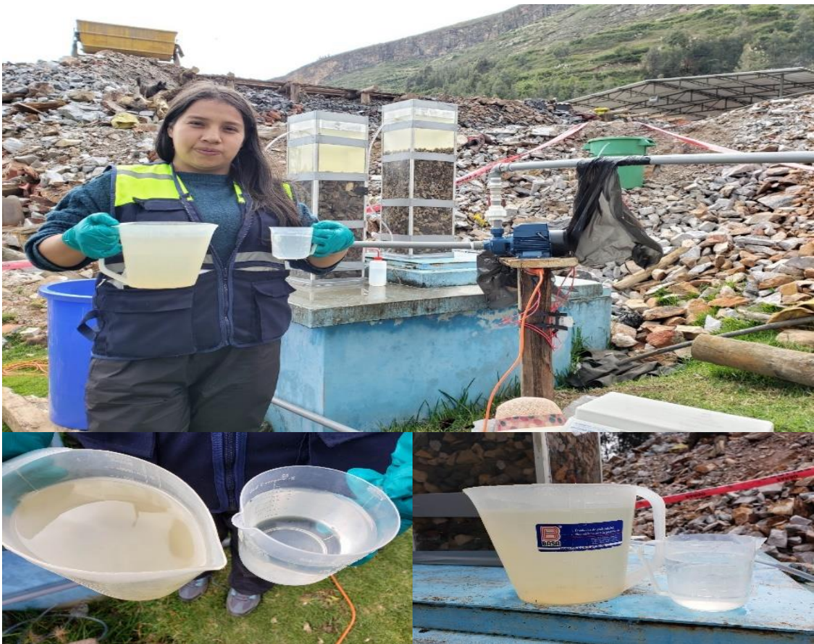
Figura 29: Diferencia de agua que ingresa con el agua que sale en el sistema piloto.
