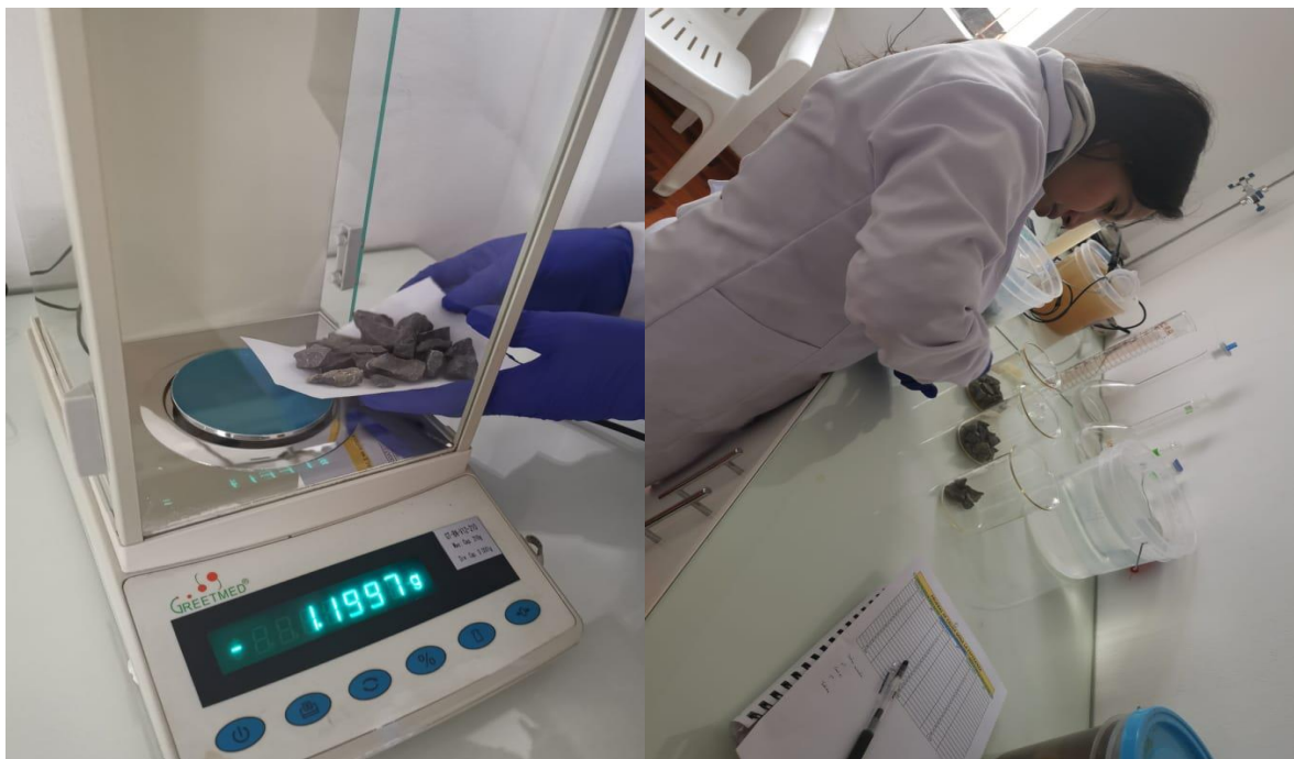
Figura 20: Pesado y llenado de la piedra caliza a los vasos de precipitación.
