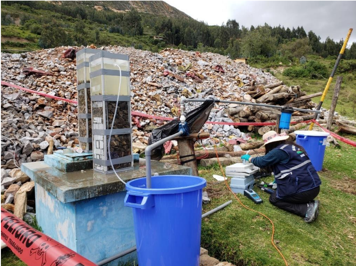
Figura 26: Monitoreo de los parámetros de conductividad, pH, turbidez.
