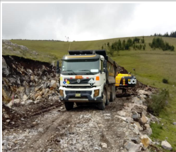
Fotografía 3. Extracción de la roca caliza de la cantera con excavadora JCB y volquete Volvo 440.
