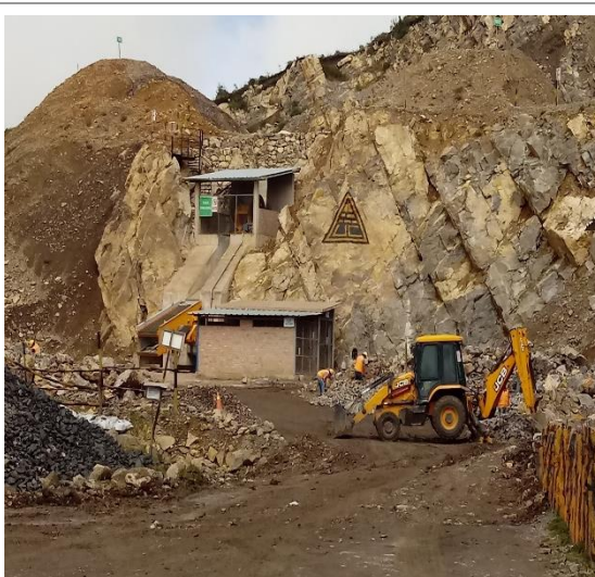
Fotografía 4. Transporte de roca caliza desde el área de chancado hacia los hornos mediante retroexcavadora JCB.
