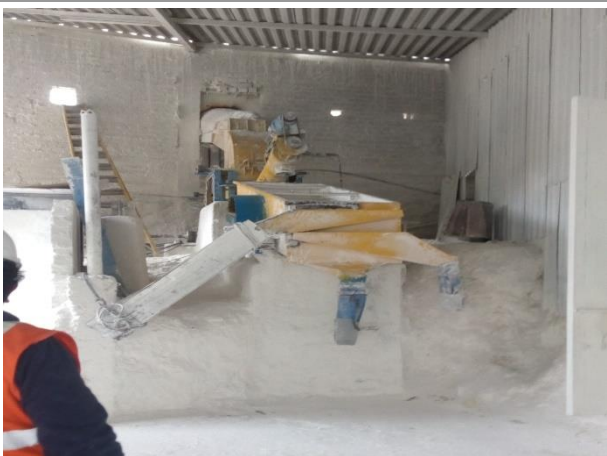
Fotografía 9: Molino de martillos para la producción de cal fina en la planta de producción Puyllucana.
