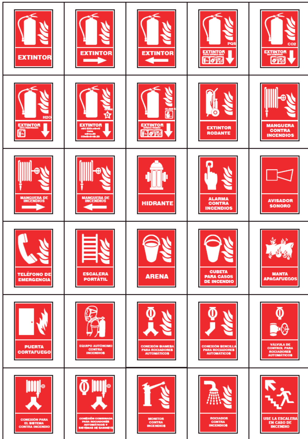
Figura 23. Ejemplo del diseño de carteles para equipos contra incendios según la NTP N° 399.
