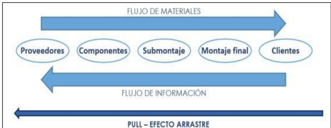
Figura 1. Sistema de control de producción tipo Pull.
