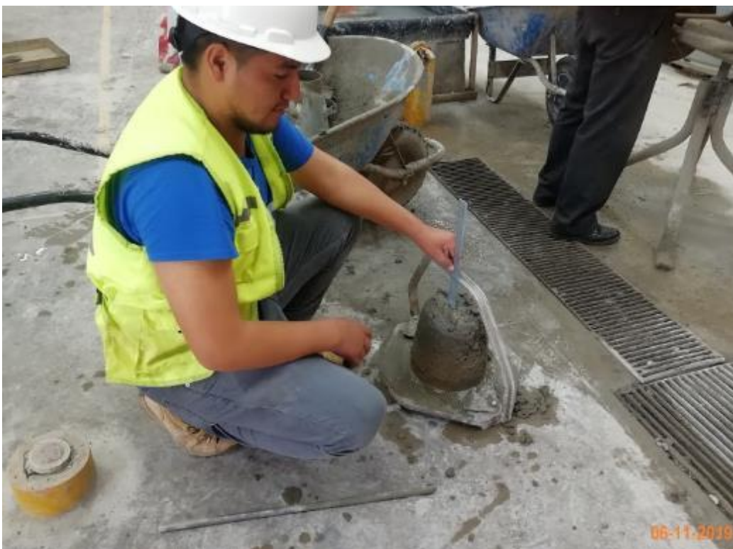
Figura 21. Realizando la medición del asentamiento del concreto en este caso tiene una consistencia plástica según Norma Técnica Peruana (NTP 339.035).
