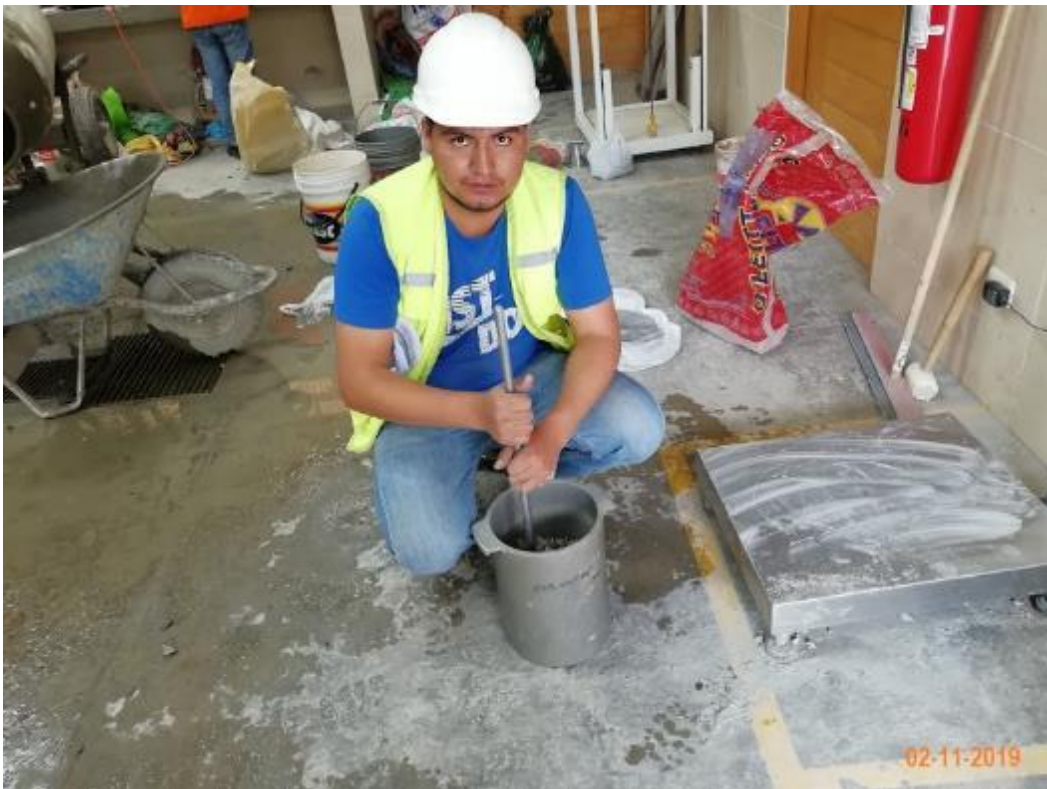
Figura 19. Realizando ensayo de peso unitario compactado de agregado grueso de cantera de río según Norma Técnica Peruana (NTP-400.017).
