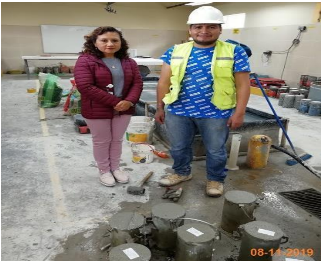
Figura 23. Elaboración de especímenes de concreto en moldes cilíndricos junto a mí asesora Ing. Anita Alva Sarmiento.
