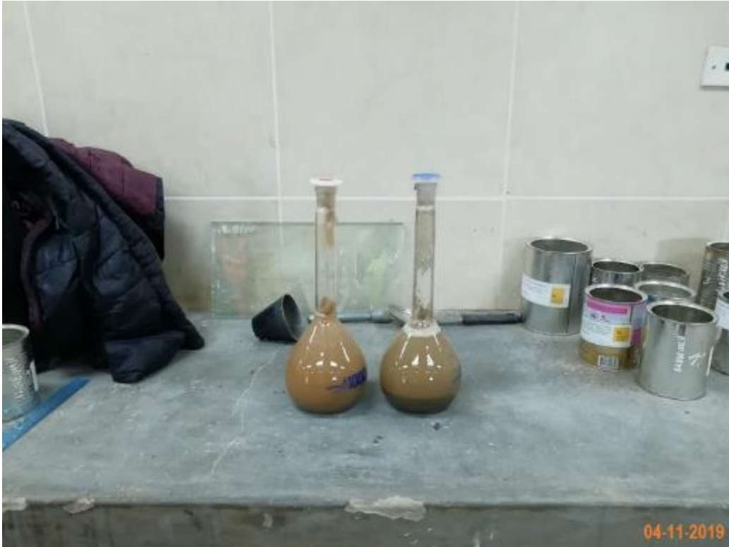
Figura 20. Agregado fino introducido en fiola para determinar el peso específico y absorción según Norma Técnica Peruana (NTP 400.022).
