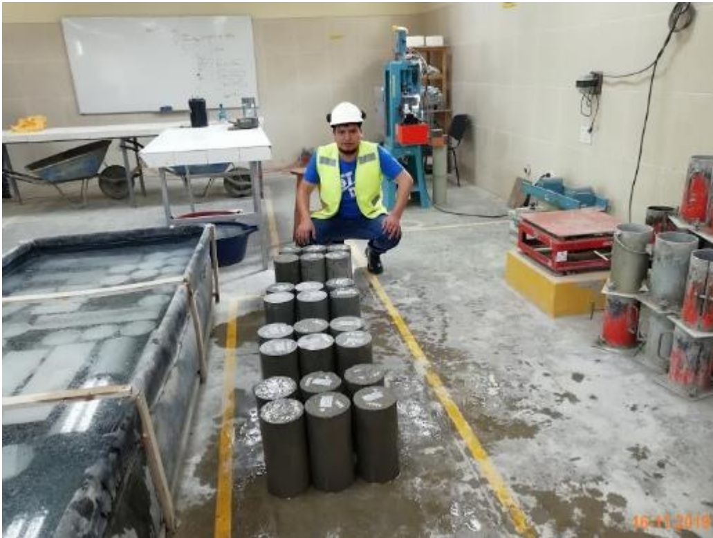
Figura 24. Extrayendo especímenes de concreto de la poza para su posterior medición y ensayos a compresión a diferentes edades de curado.
