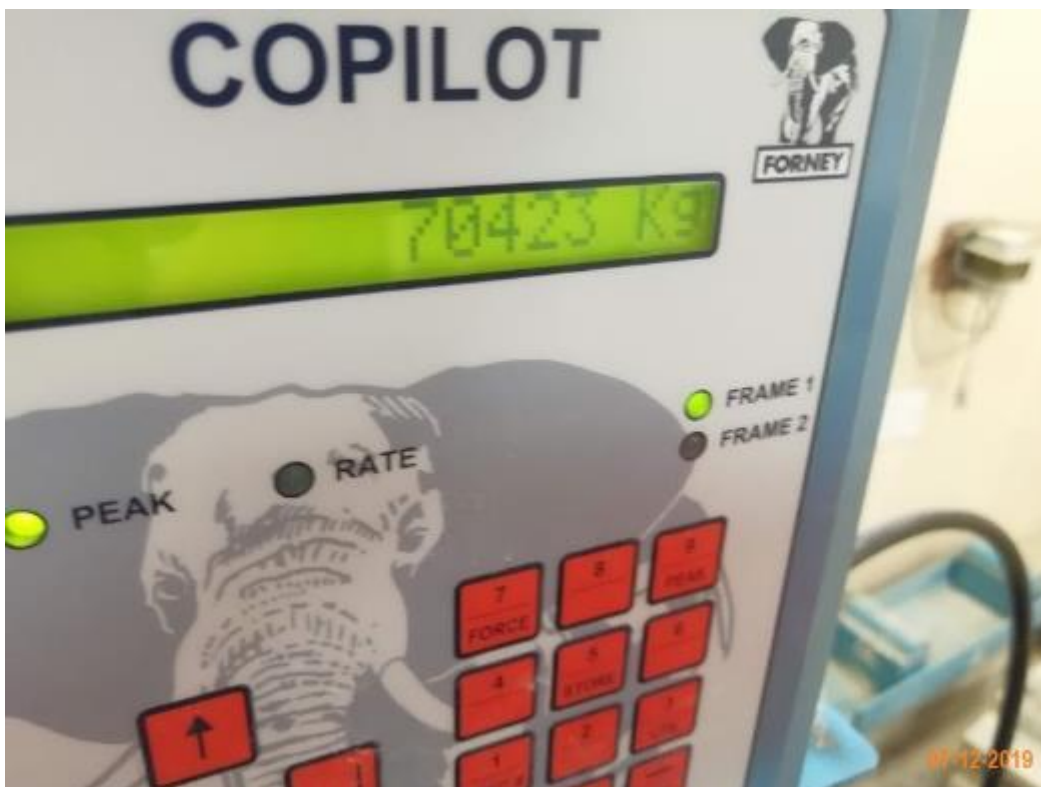
Figura 27. Carga ultima luego de realizar ensayos a compresión
