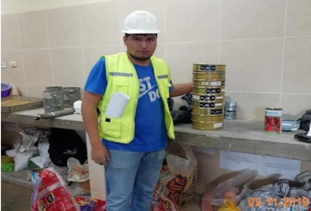
Figura 18. Juego de tamices para realizar ensayo de análisis granulométrico según Norma Técnica Peruana (NTP-400.012).
