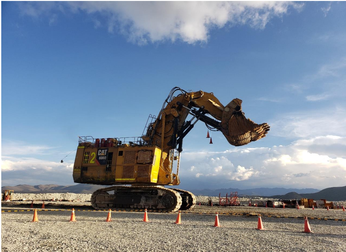
Foto 3: Pala CAT 6060 Fs Fs en mantenimiento programado.
