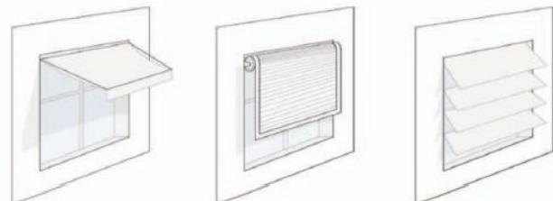
Protecciones solares móviles.
