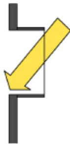
Figura 3.9. Ventana saliente o bow-window. Un menor porcentaje de radiación solar es recibida.
