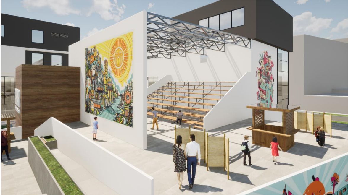
Figura 96 Anfiteatro elevado y cubierto por estructura metálica con policarbonato
