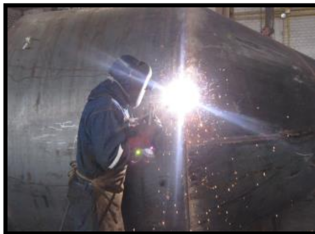
Anexo 2: Fabricación de silo de cal 18Tn
