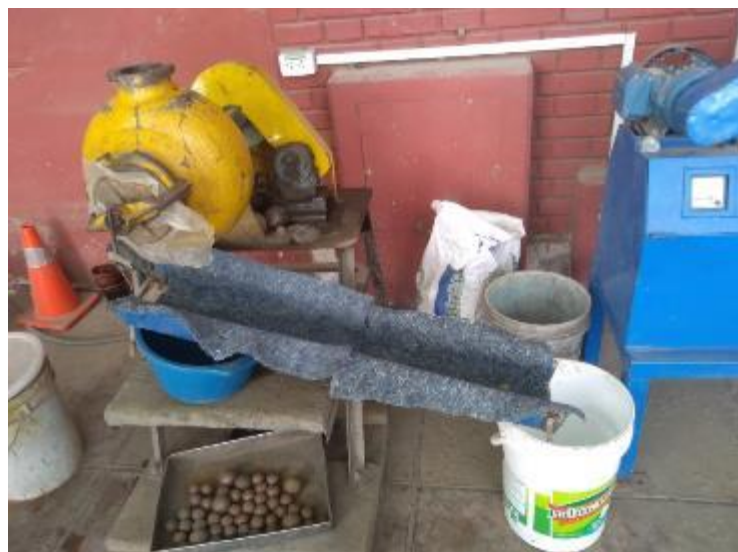
Ilustración 4: Canaletas para la concentración gravimétrica
