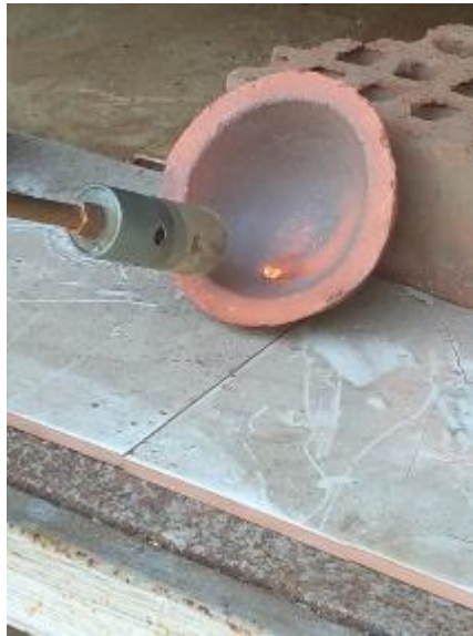
Ilustración 7: Fundición de amalgama
