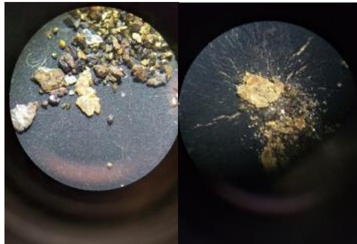
Ilustración 9: Observación de láminas de oro en el estereoscopio
