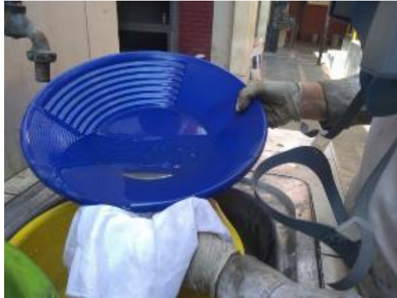
Ilustración 5: Chullado del mercurio
