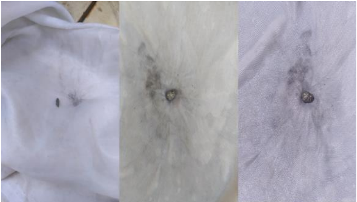
Foto 8. Obtención de la amalgama con mercurio.
