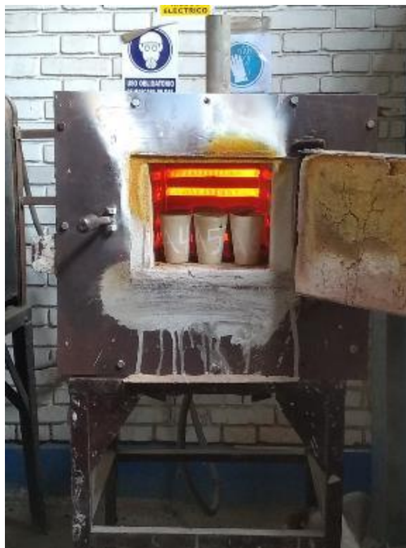
Foto 42. Crisoles dentro del horno de fundición.
