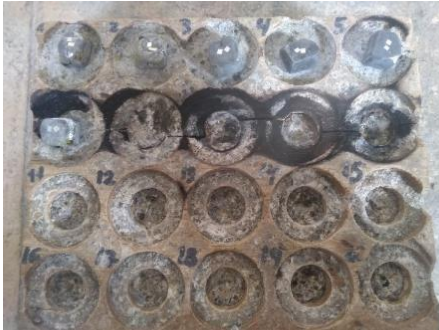
Foto 45. Régulos con encuarte (plata electrolítica) para tener una relación de 3:1 y poder refinar.
