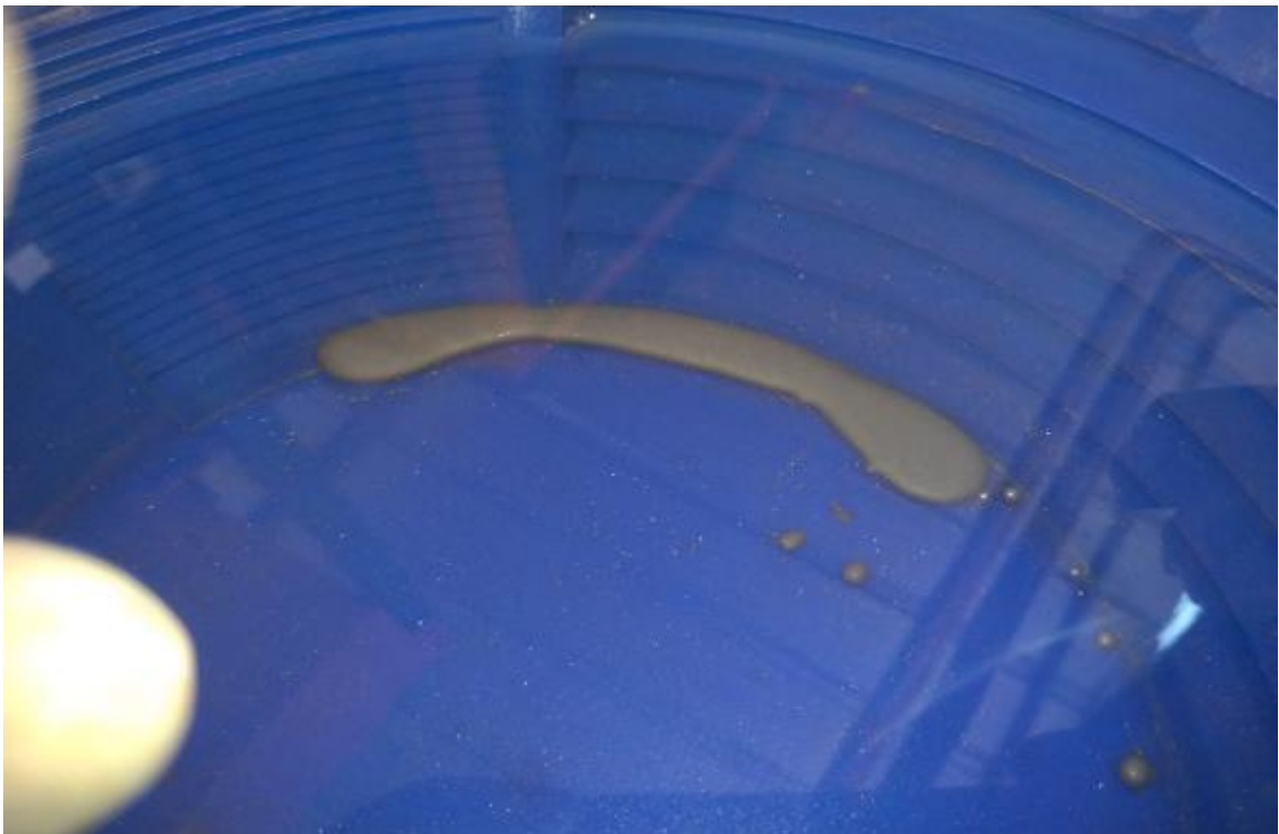
Foto 6. Amalgama con oro obtenido después de lavar el mineral.
