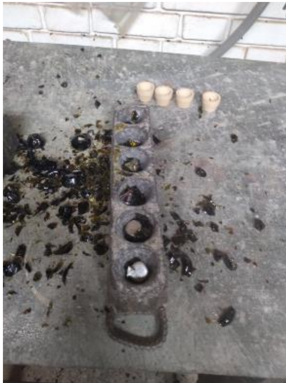
Foto 43. Régulos obtenidos de los dos tipos de minerales (COD A1 – A6).
