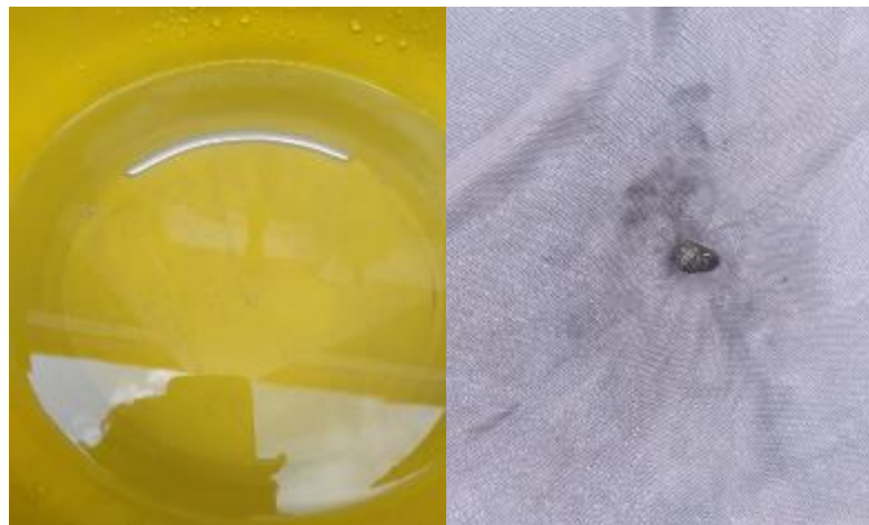
Ilustración 6: Mercurio limpio y amalgama para fundición
