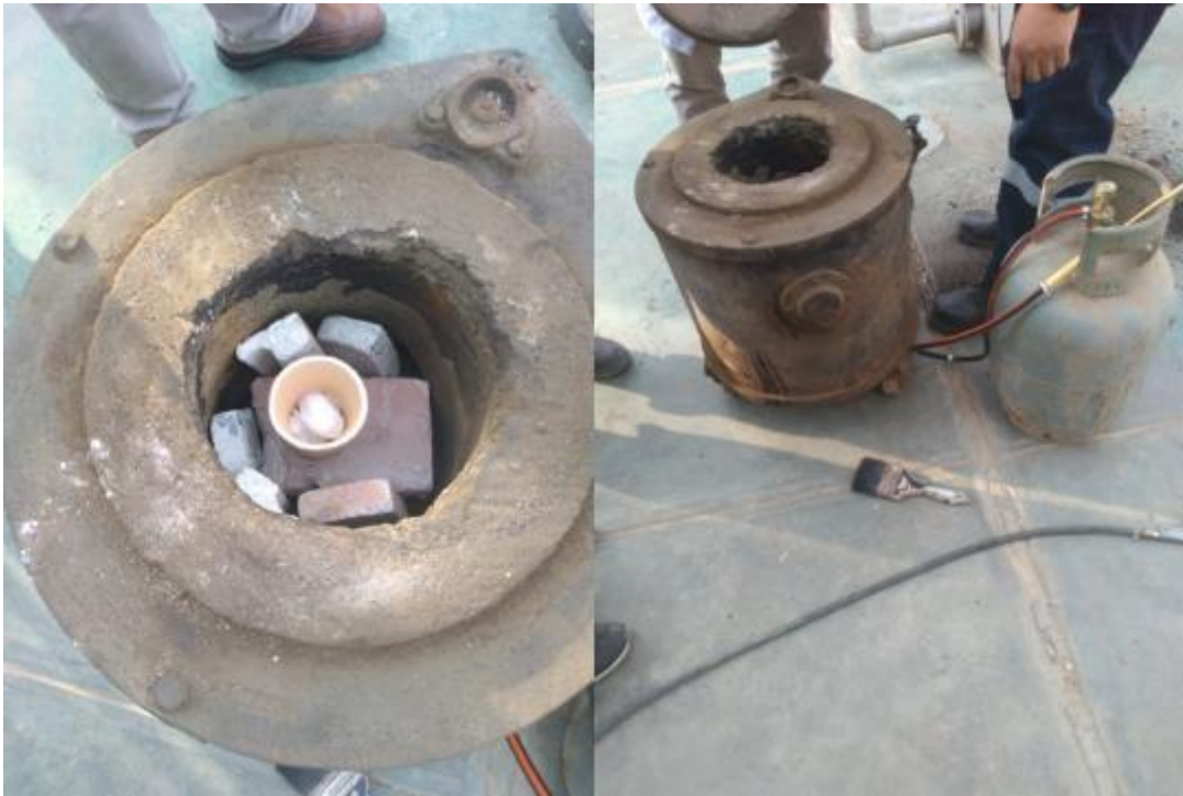
Foto 31. Fundición del mineral óxido con bórax.
