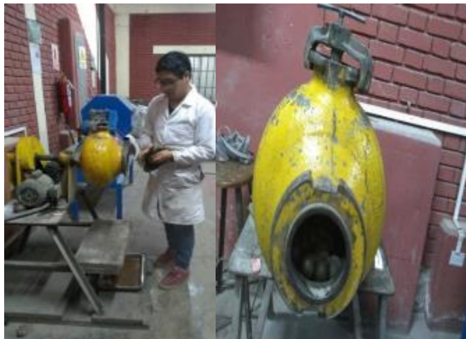
Ilustración 3: Pulverizado en molino de bolas
