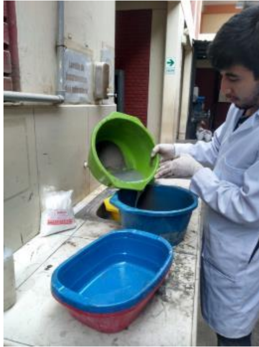
Foto 3. Lavado del mineral con mercurio.
