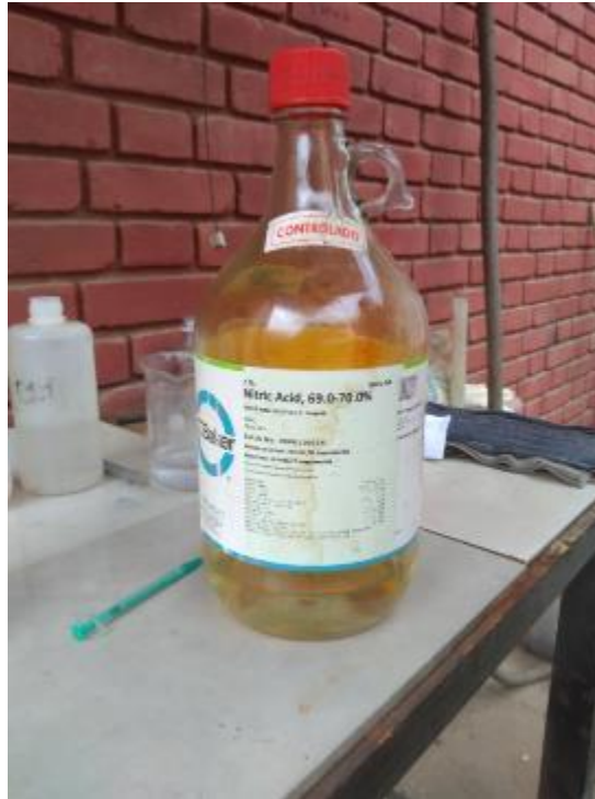
Foto 47. Ácido Nítrico usado para la refinación de los dorés.
