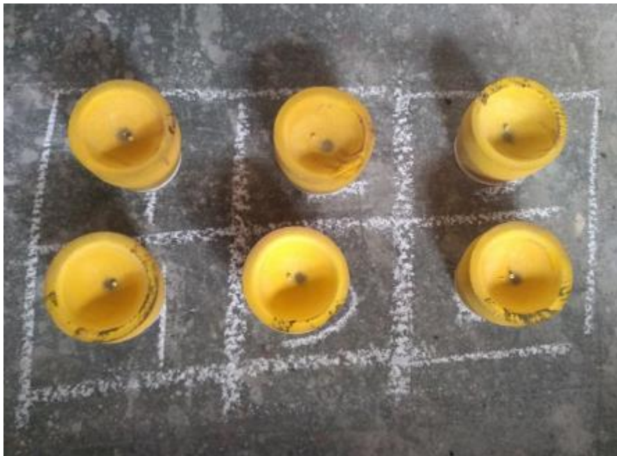
Foto 46. Dorés obtenidos por copelación de los régulos.
