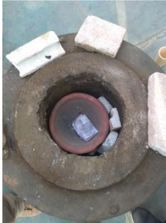
Foto 33. Fundición del mineral del río marañón con bórax
