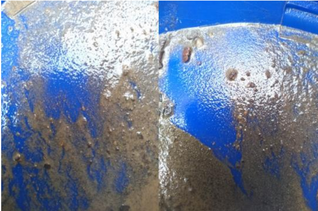
Foto 26. Lavado del mineral se puede observar pequeñas láminas de oro.
