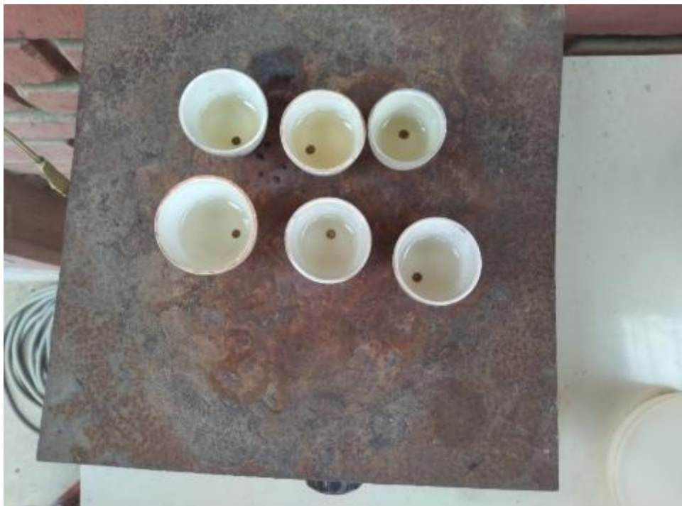
Foto 48. Refinación de los dorés para la obtención del oro refogado.
