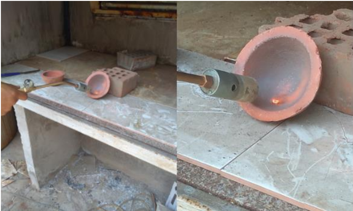
Foto 11. Fundición de la Amalgama para la obtención del doré.
