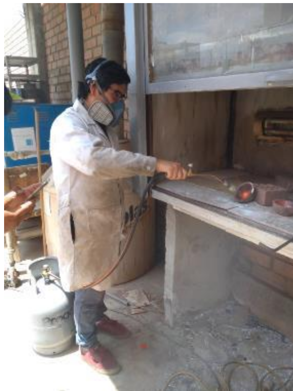
Foto 10. Fundición de la Amalgama para la obtención del doré.
