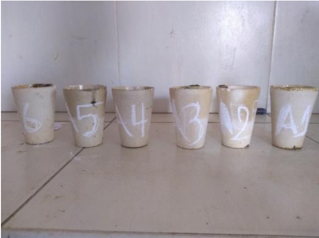
Foto 41. Crisoles para la fundición directa con flux con cada código del mineral.
