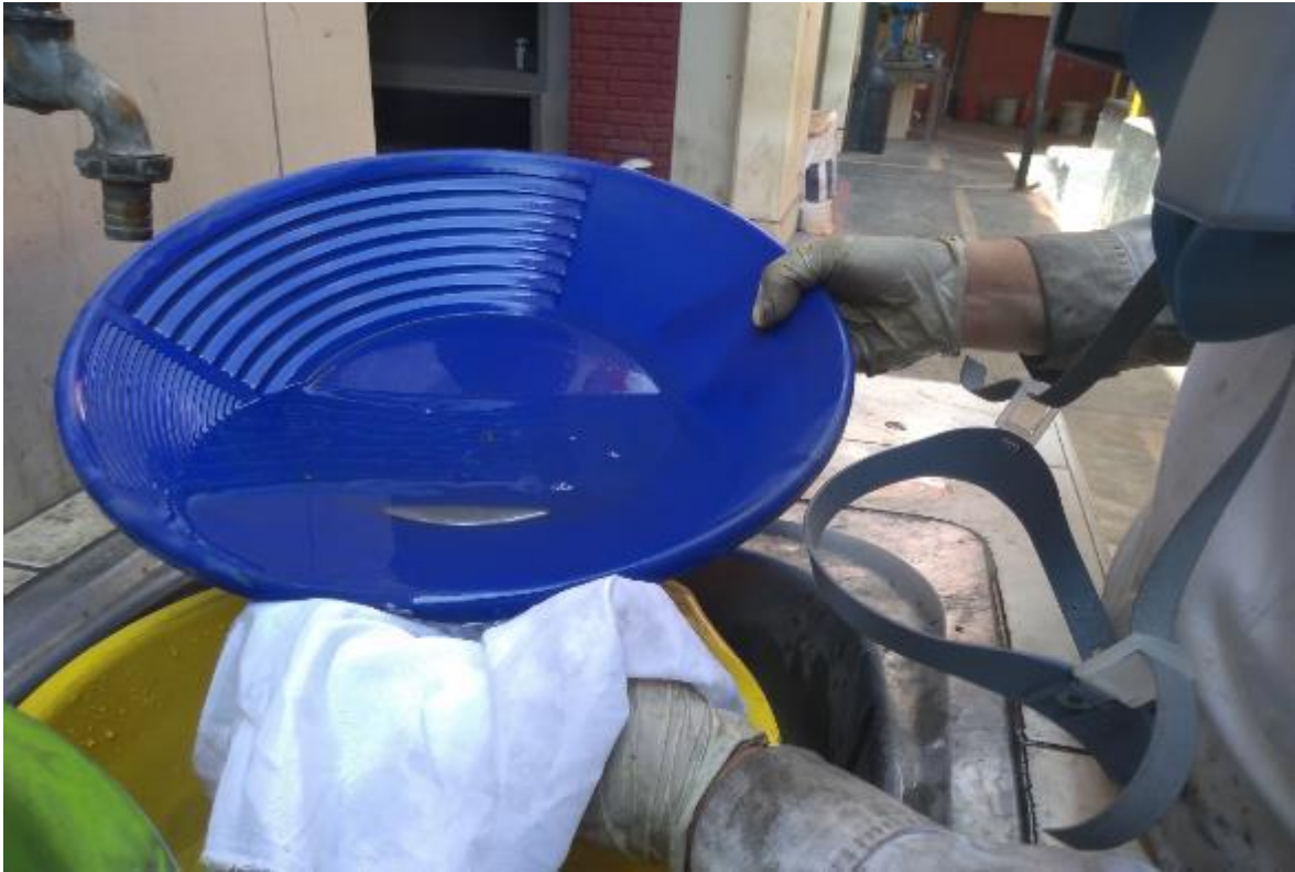
Foto 7. Chullado de la amalgama (filtración).
