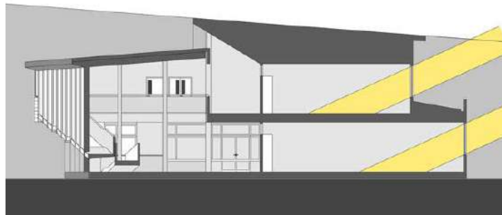
FIGURA 10. Captación solar directa en Escuela Gabriela Mistral, Aysén Fuente: Odone, L; Bobadilla, M; Veas, E y otros. (2012). “Manual de Diseño Pasivo y Eficiencia Energética en Edificios Públicos”.
