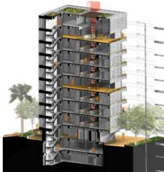
Figura 08: Sección 2 efecto chimenea
