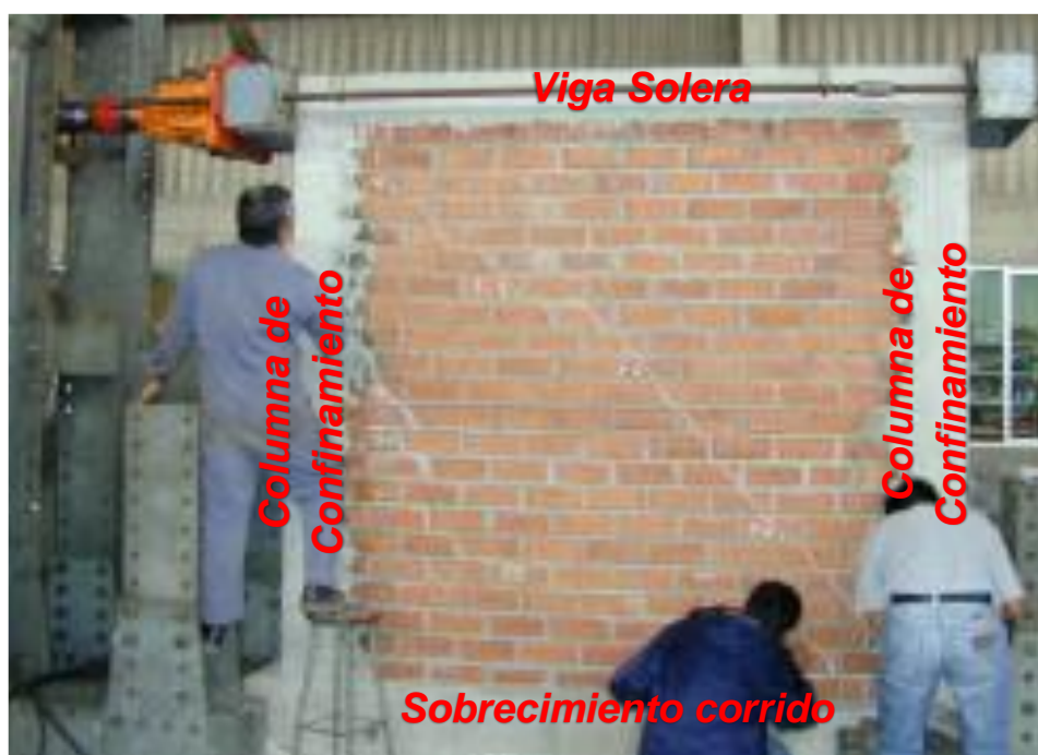
Figura 30 : Muro de albañilería confinada
