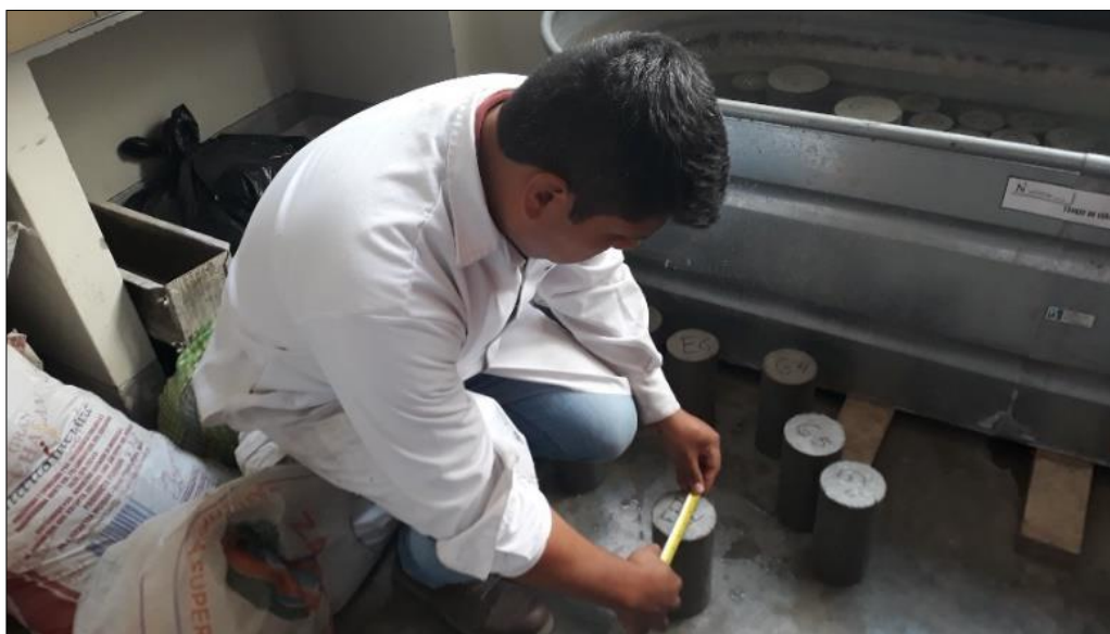
Figura 51. Cumplido el tiempo, se procede a realizar el ensayo de compresión. Fuente propia.
