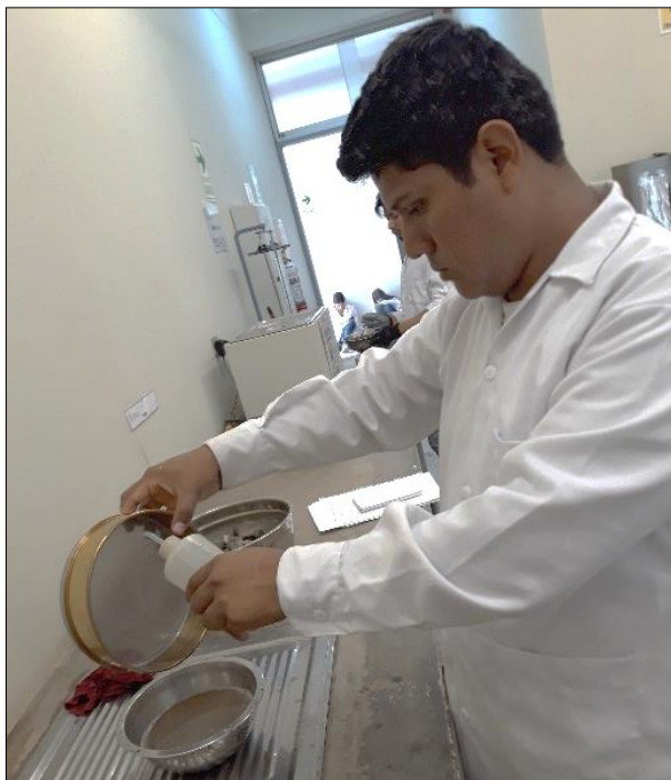
Figura 22. Lavado del agregado fino para el ensayo de malla N°200. Fuente propia.
