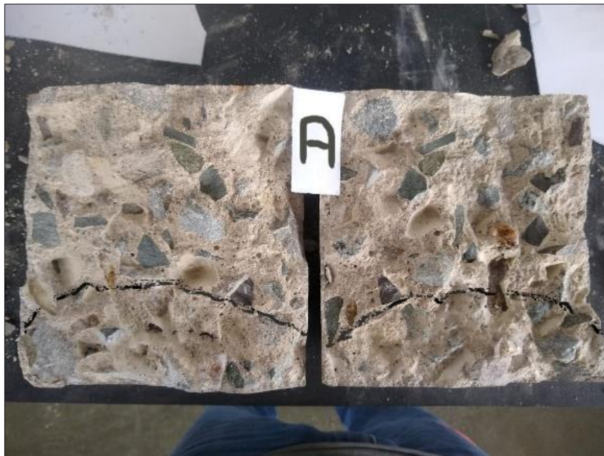
Figura 66. Penetración de agua. Concreto Patrón. Profundidad: 71.3. Fuente propia.
