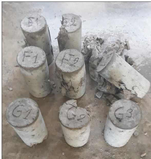
Figura 54. Concreto Patrón + fibra de coco, compresión a los 7 días de curado. Fuente propia.
