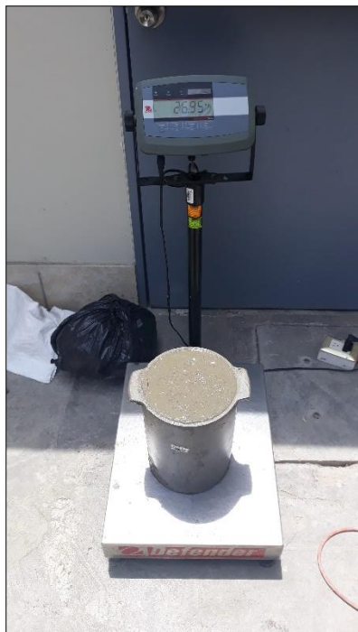
Figura 40. Peso unitario del concreto patrón + 0.1% de fibra de coco. Fuente propia.
