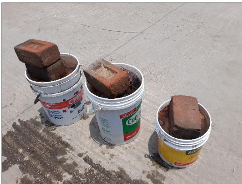
Figura 31. Humedecimiento de las cascaras de coco. Fuente propia.
