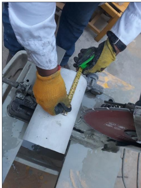
Figura 60. Medición de corte de probetas para el ensayo de Permeabilidad. Fuente propia.
