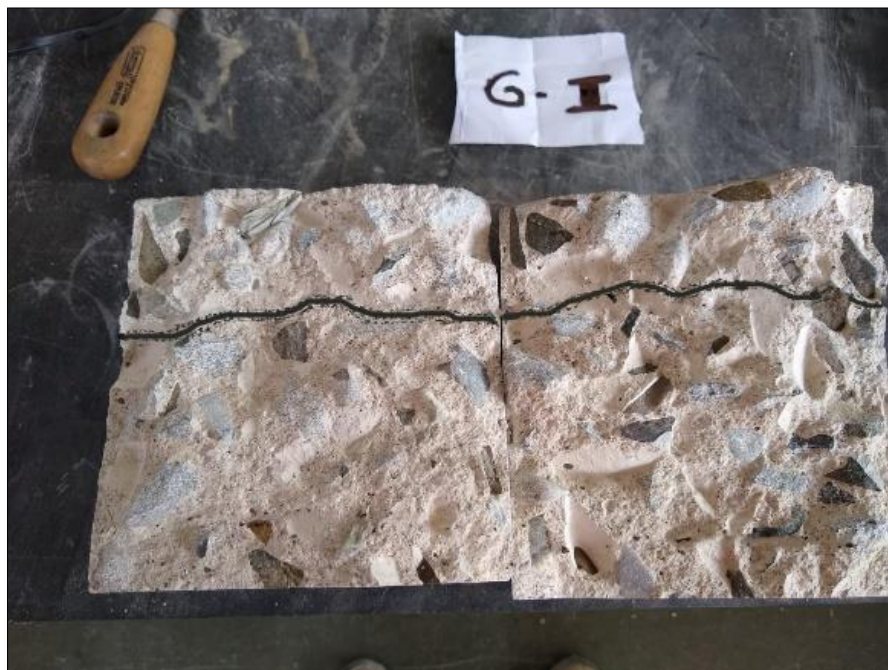
Figura 73. Penetración de agua. Patrón + 03% de fibra de coco. Profund.: 96.5 mm. Fuente propia.
