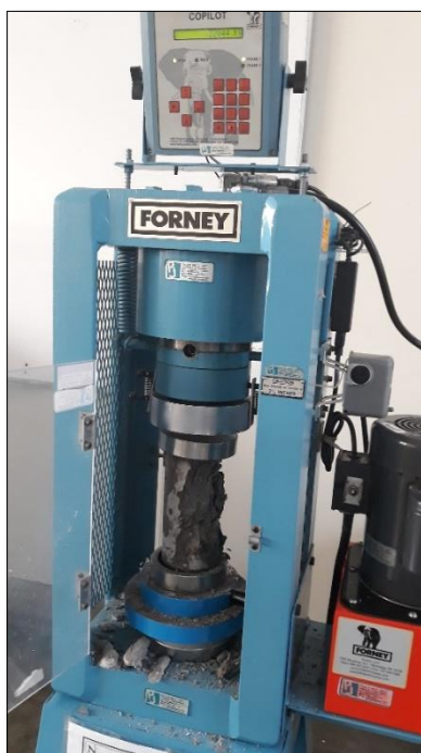
Figura 50. Ensayo de rotura de probetas patrón. Fuente propia.
