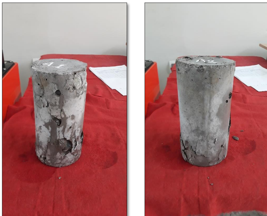
Figura 53. Probetas de Concreto Patrón ensayadas a compresión. Fuente propia.
