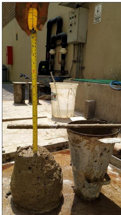
Figura 42. Asentamiento del Concreto Patrón. Fuente propia.
