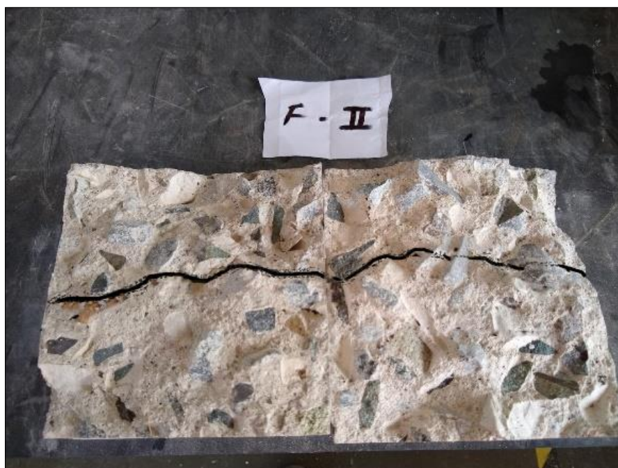
Figura 70. Penetración de agua. Patrón + 0.2% de fibra de coco. Profund.: 90.4 mm. Fuente propia.
