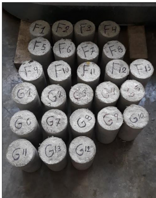
Figura 48. Probetas de concreto listas para su curado. Fuente propia.
