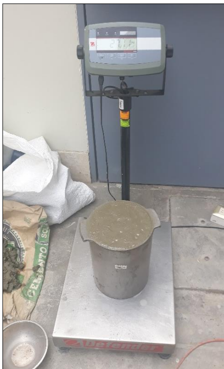
Figura 43. Peso unitario del concreto patrón + 0.3% de fibra de coco. Fuente propia.
