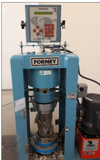
Figura 52. Ensayo de rotura de probetas con adición de fibra. Fuente propia.
