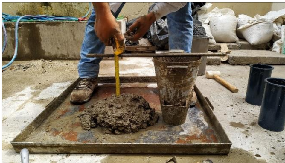
Figura 45. Asentamiento del concreto patrón + 0.2% de fibra de coco. Fuente propia.
