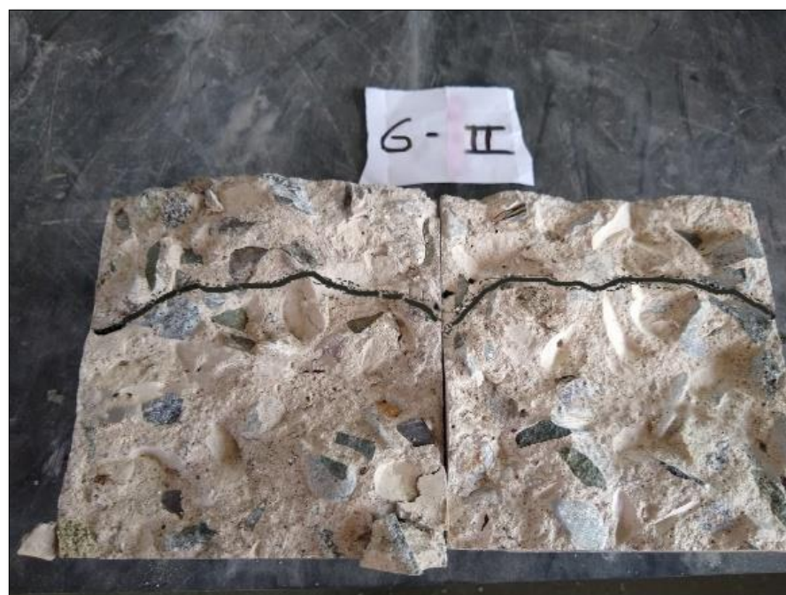
Figura 72. Penetración de agua. Patrón + 0.3% de fibra de coco. Profund.: 94.5 mm. Fuente propia.
