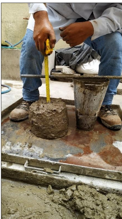
Figura 44. Asentamiento del Concreto Patrón + 0.1% de Fibra de coco. Fuente propia.
