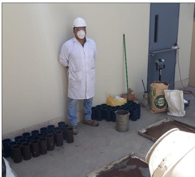
Figura 36. Preparación de moldes de para probetas de concreto. Fuente propia.
