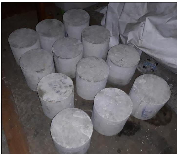
Figura 61. Probetas adecuadas para el ensayo de permeabilidad. Fuente propia.
