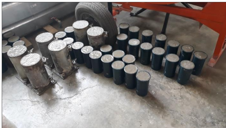
Figura 47. Colocación de mezcla de concreto en probetas. Fuente propia.
