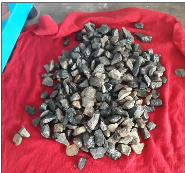
Figura 24. Secado superficial del agregado grueso. Fuente propia.
