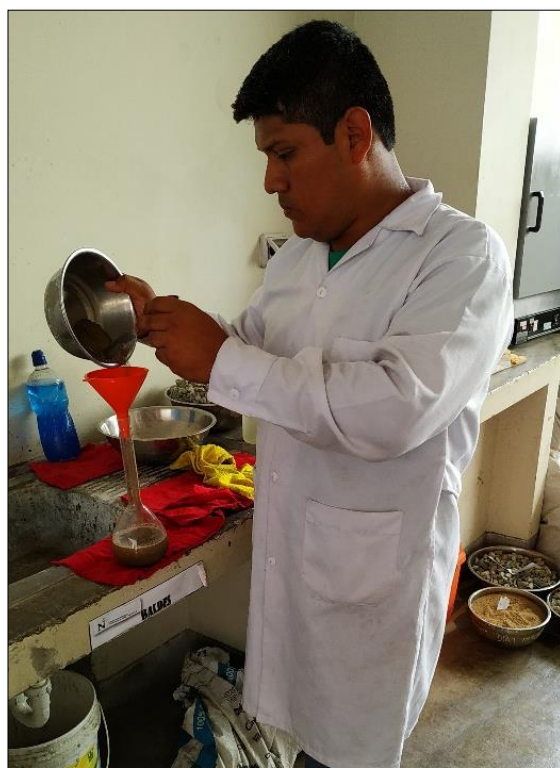
Figura 28. Colocación del agregado fino en el picnometro. Fuente propia.
