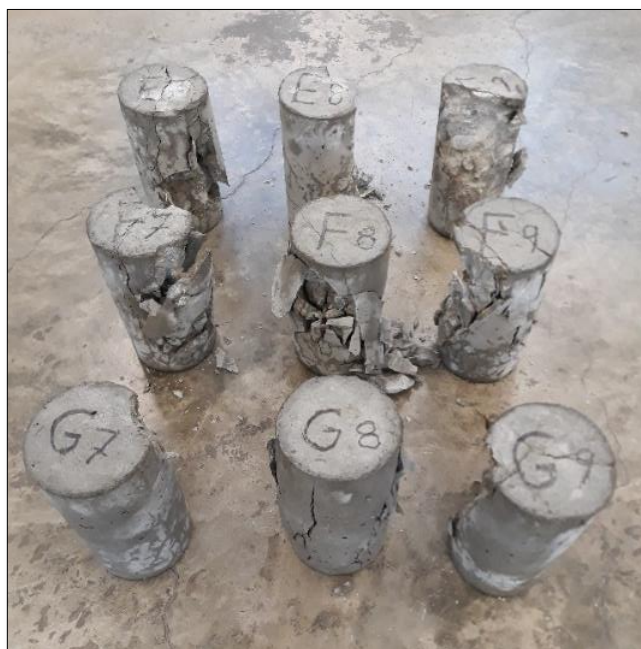
Figura 56. Compresión a los 21 días de curado. Fuente propia.
