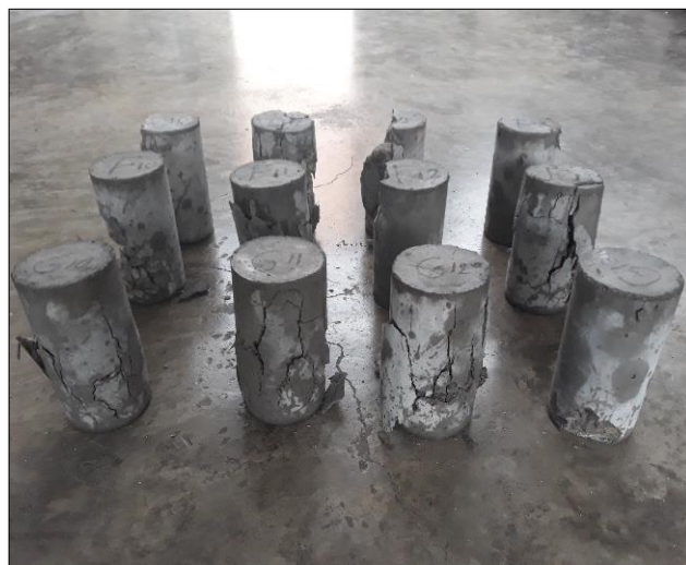
Figura 57. Compresión a los 28 días de curado. Fuente propia.
