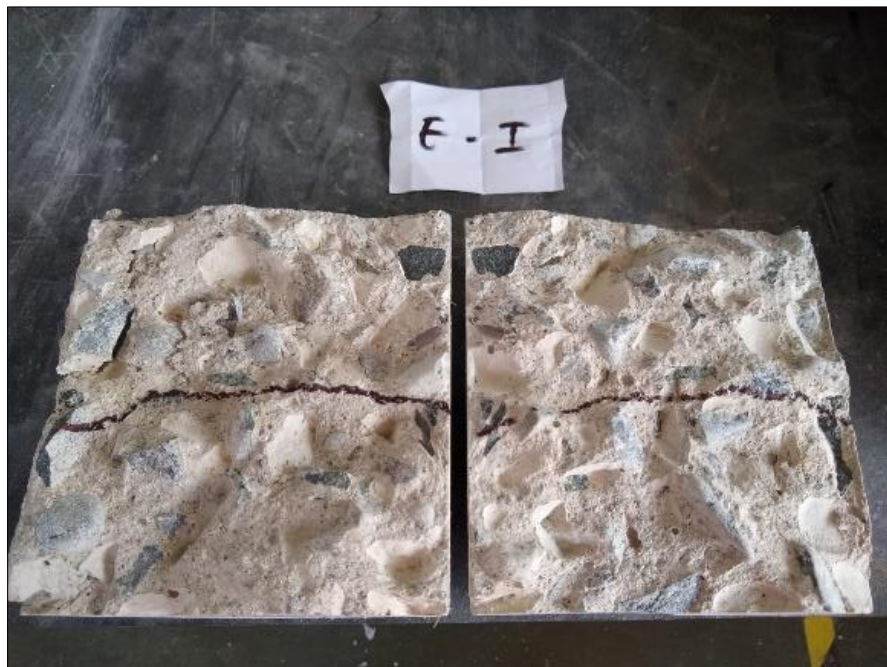
Figura 69. Penetración de agua. Patrón + 0.1% de fibra de coco. Profund.: 64.0 mm. Fuente propia.
