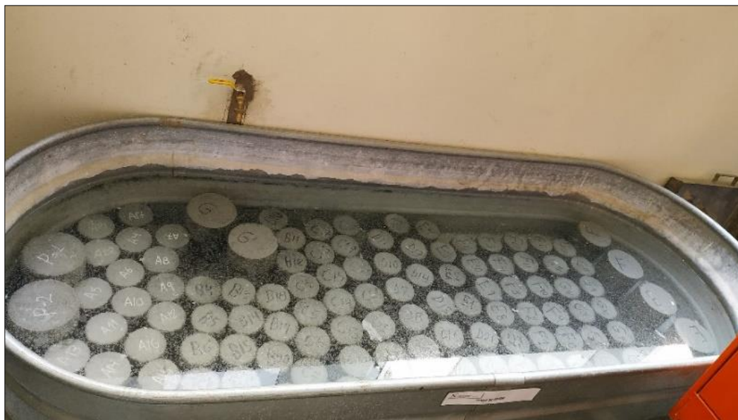
Figura 49. Colocación de probetas en la piscina de curado. Fuente propia.
