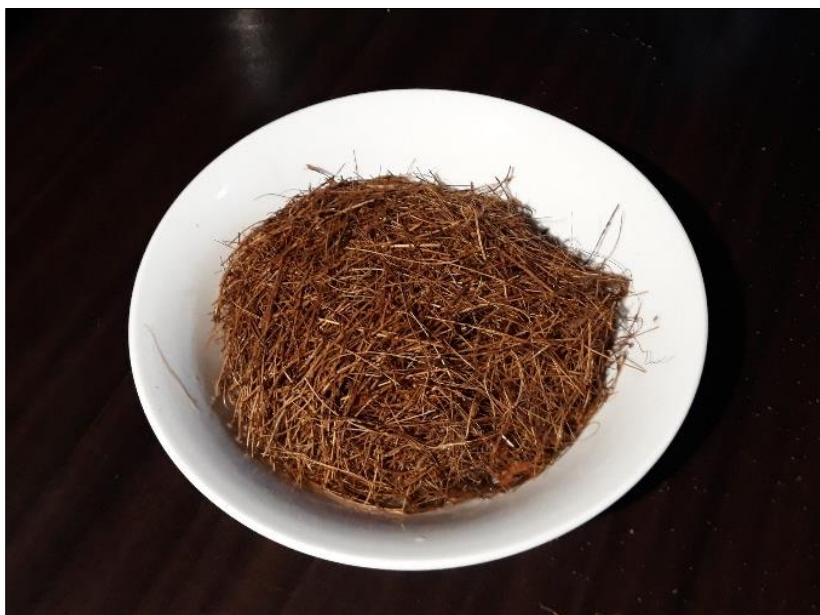
Figura 34. Fibras de coco debidamente procesadas. Fuente propia.
