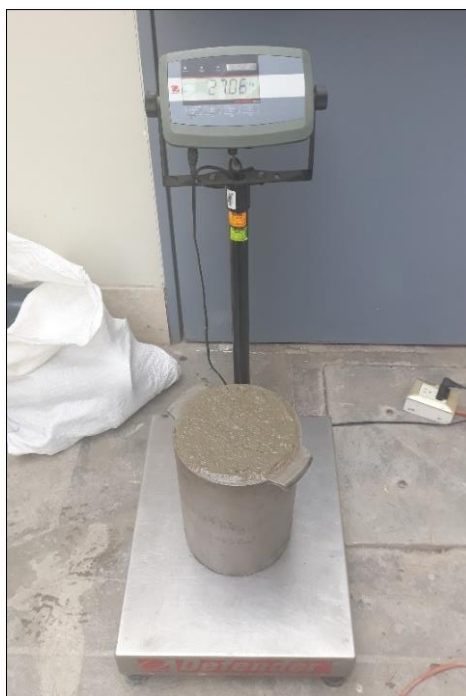
Figura 41. Peso unitario del concreto patrón + 0.2% de fibra de coco. Fuente propia.
