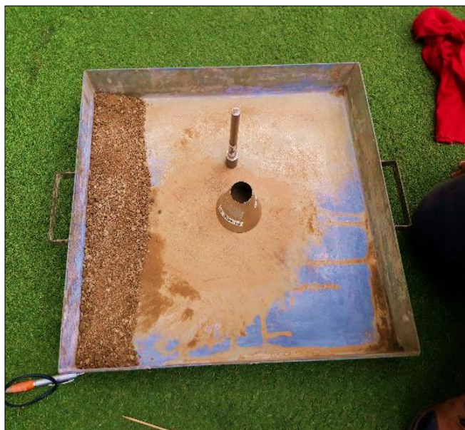
Figura 27. Preparación del agregado fino para el ensayo de peso específico. Fuente propia.
