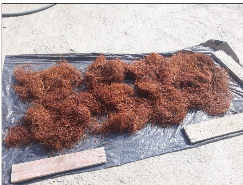
Figura 33. Extracción de la fibra de coco, secadas de forma natural. Fuente propia.
