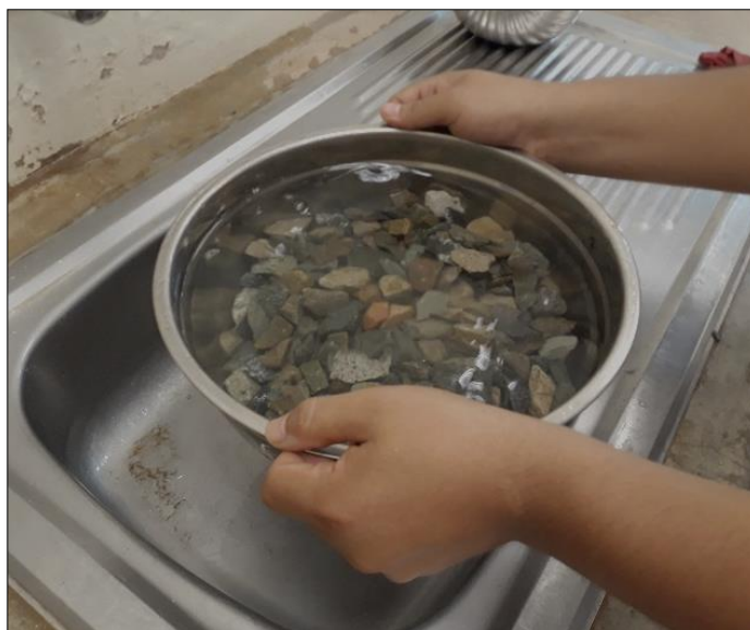
Figura 23. Lavado de los agregados para el retiro de finos. Fuente propia.
