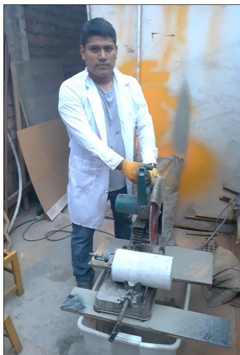
Figura 58. Corte de probeta de concreto para el ensayo de permeabilidad. Fuente propia.
