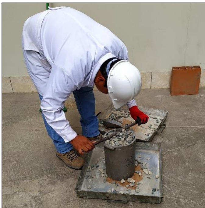
Figura 29. Colocación de Agregado grueso en recipiente. Fuente propia.
