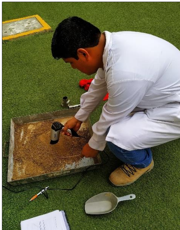
Figura 26. Secado del agregado fino para el ensayo del Peso específico. Fuente propia.
