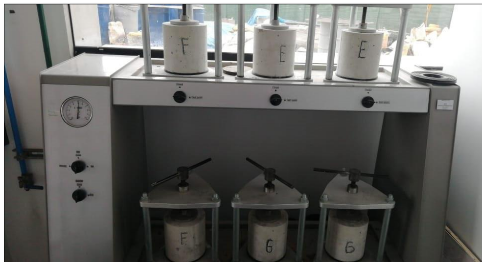
Figura 64. Colocación de probetas en el equipo de Permeabilidad. Fuente propia.
