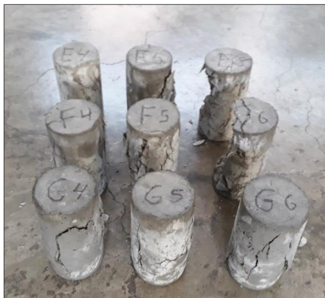
Figura 55. Compresión a los 14 días de curado. Fuente propia.
