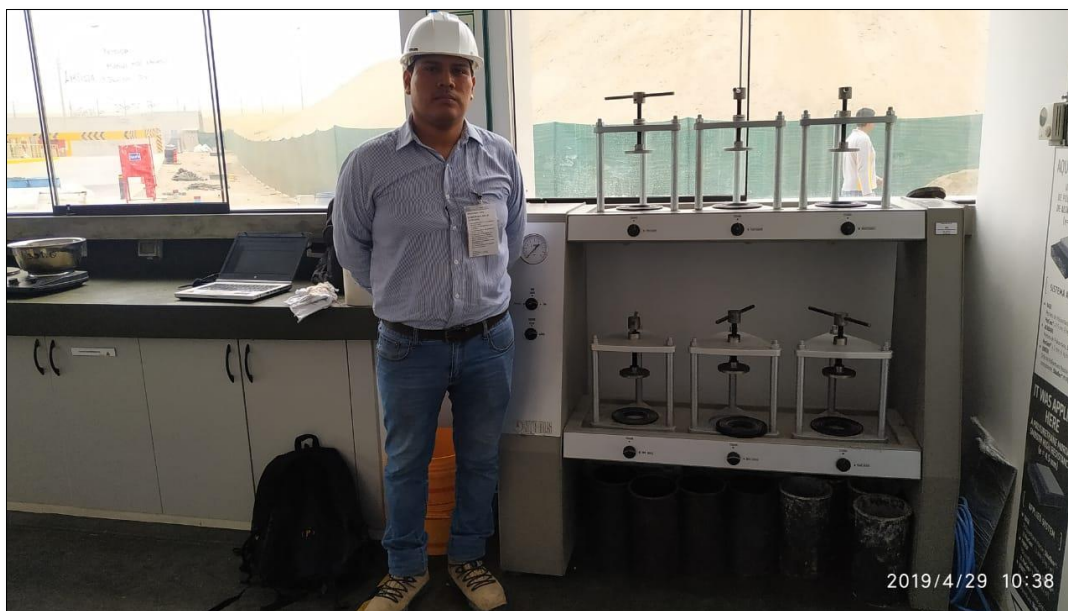
Figura 63. Equipo para el ensayo de Permeabilidad en el LEM de la empresa SIKA. Fuente propia.
