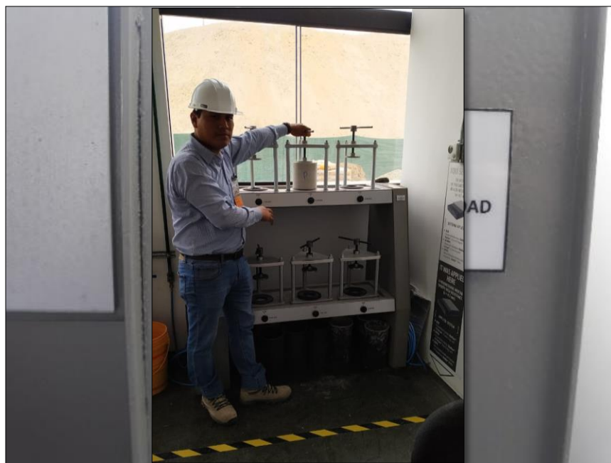
Figura 65. Colocación de probetas en el equipo de permeabilidad. Fuente propia.
