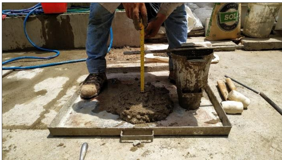
Figura 46. Asentamiento del concreto patrón + 0.3% de fibra de coco. Fuente propia.
