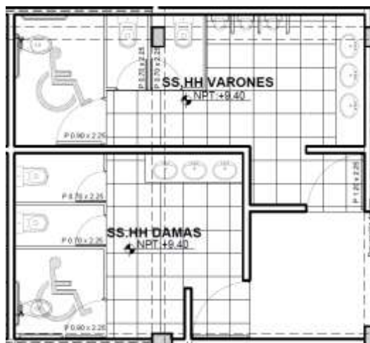
Figura 100: Batería de Baños de Consulta Especializada
