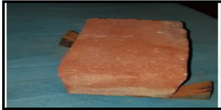
Imagen 20. Ladrillo inclinado para su nivelación Fuente. Elaboración propia 2018.
