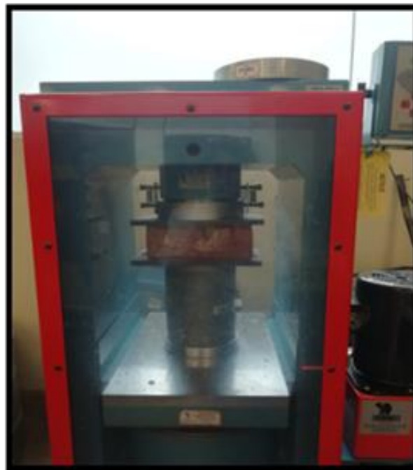
Imagen 25. Máquina de ensayo de resistencia a la compresión. Fuente. Elaboración propia 2018.
