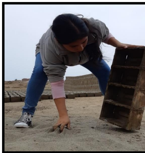
Imagen 7. Arenado de Molde para evitar que se pegue la arcilla Fuente: Elaboración propia
