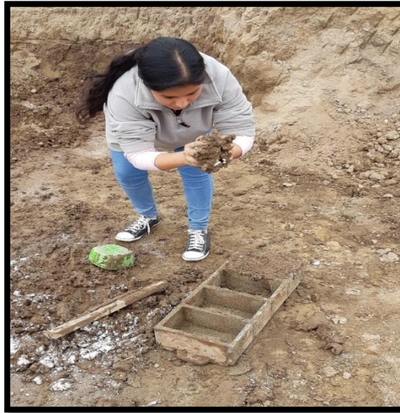
Imagen 8. Moldeado de ladrillo y colocación en el molde Fuente: Elaboración propia
