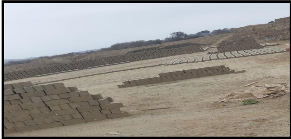
Imagen 11. Secado del ladrillo al aire libre Fuente: Elaboración propia
