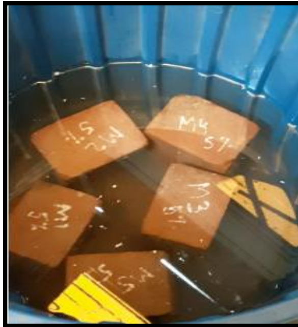
Imagen 30. Ladrillos adicionados al 5% de carbonato de calcio para ser evaluados en su absorción Fuente. Elaboración propia 2018.
