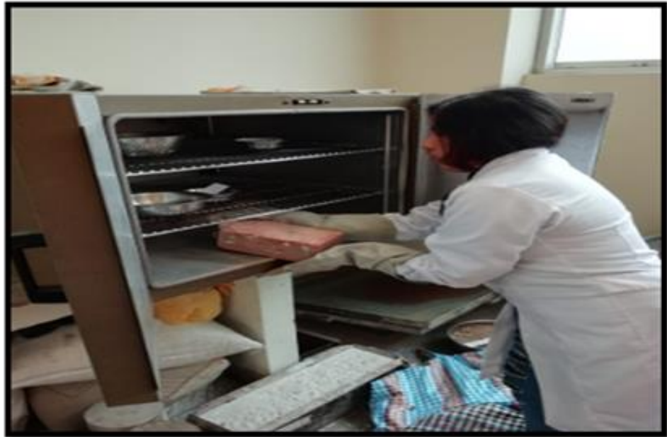
Imagen 28. Colocación de Ladrillo en el Horno Fuente. Elaboración propia 2018.
