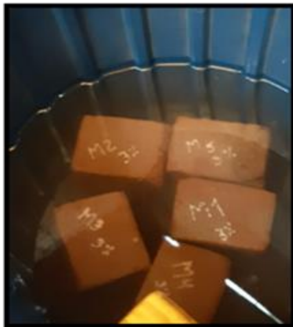
Imagen 29. Ladrillos adicionados al 3% de carbonato de calcio para ser evaluados en su absorción Fuente. Elaboración propia 2018.
