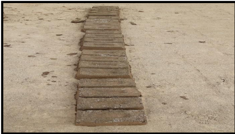
Imagen 10. Ladrillos ya moldeados Fuente: Elaboración propia
