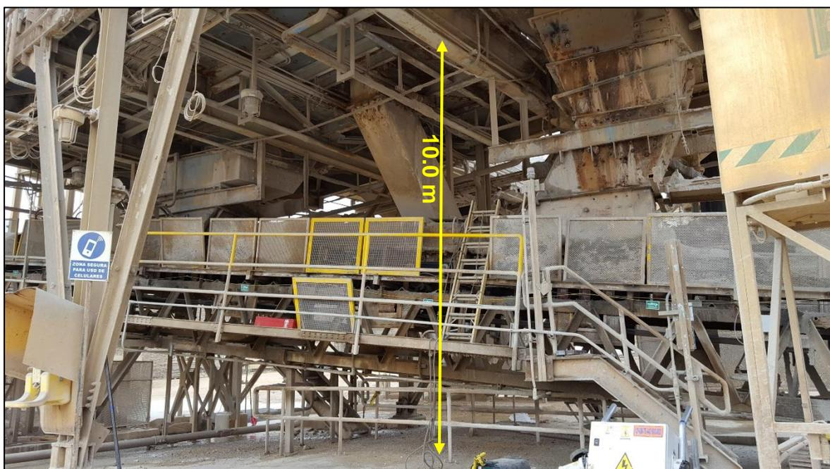
Figura 12. Altura de la planta Gold Mill.
