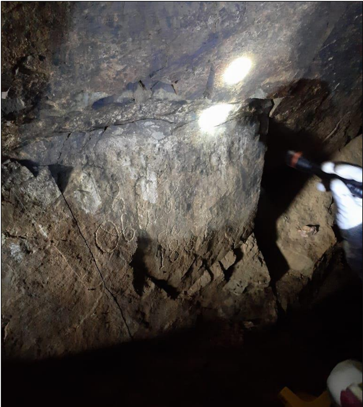
Figura 26: Estación geomecánica del macizo rocoso N°2. Donde podemos observar que la roca andesita está ligeramente alterada, presenta Dieciséis fracturas presenta el macizo rocoso con espaciamiento de las discontinuidades tiene un promedio de 0.18m, ligeramente rugosa, apertura promedio es menor a 0.1mm, relleno es suave con alteración moderada del macizo rocoso.
