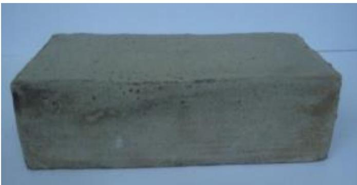
Figura 2. Ladrillo elaborado con mezcla óptima (53)
