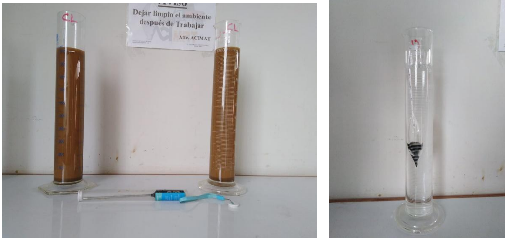
Figura 50: Muestra de tierra – ensayo de Hidrometria
