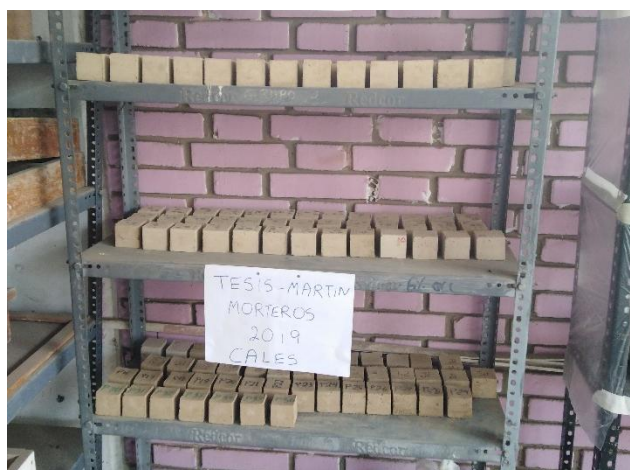
Figura 49: Almacenamiento de morteros bajo sombra
