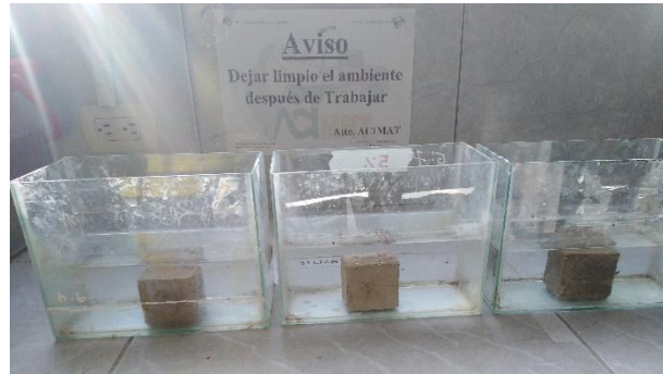
Figura 54: Morteros consolidados 2 horas de ensayo
