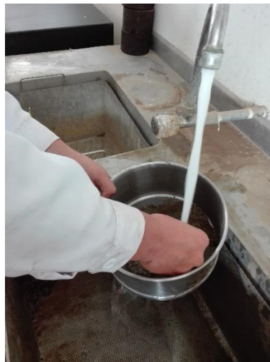
Figura 43: Lavado por la malla N°200
