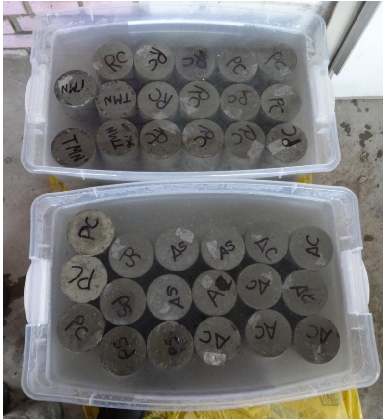
Figura 72: Probetas en poza de curado agua + cal.
