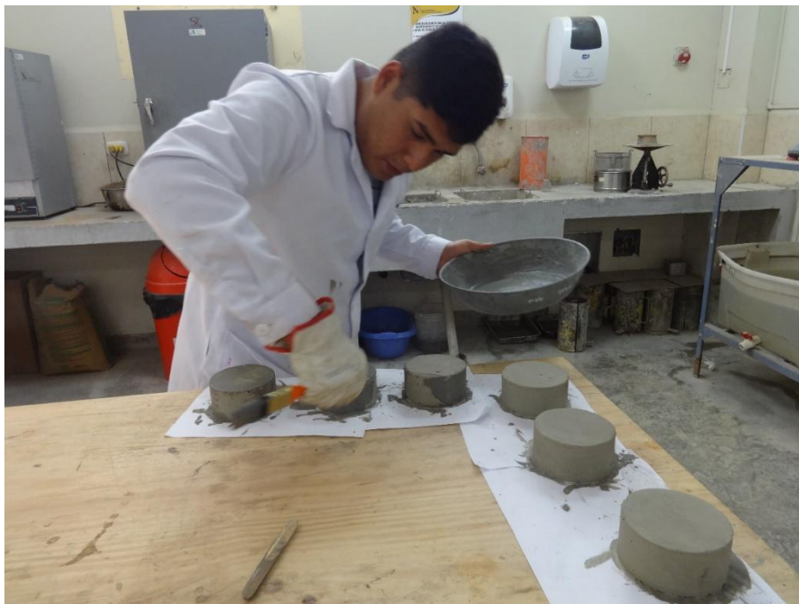
Figura 78: Impermeabilización de muestras para ensayo de sorptividad
