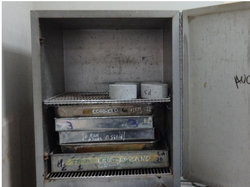
Figura 77: Secado al horno de muestras para ensayo de sorptividad.
