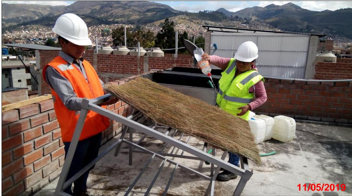
*Fotografía 25: No filtra nada de agua después de haber probado varias veces, entonces trabajamos con un espesor de 5 cm*
