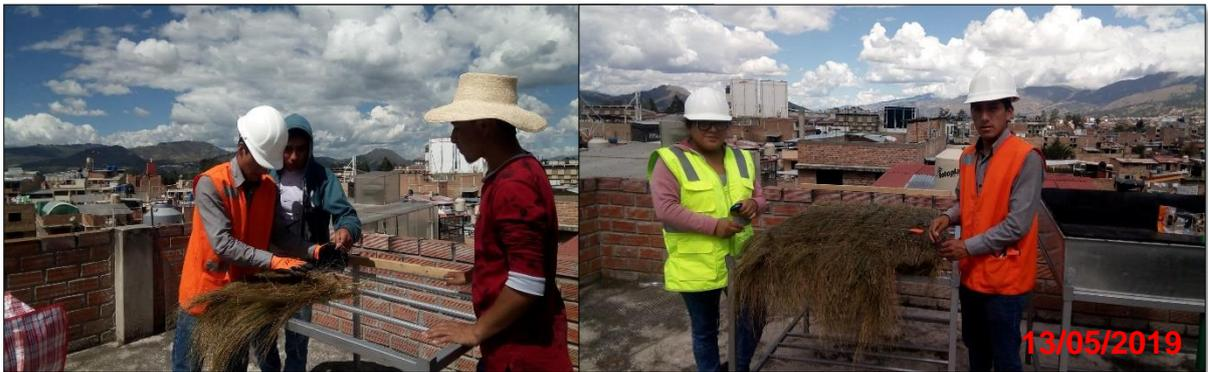
*Fotografía 24: Realizando la prueba de impermeabilidad para obtener el espesor adecuado*
