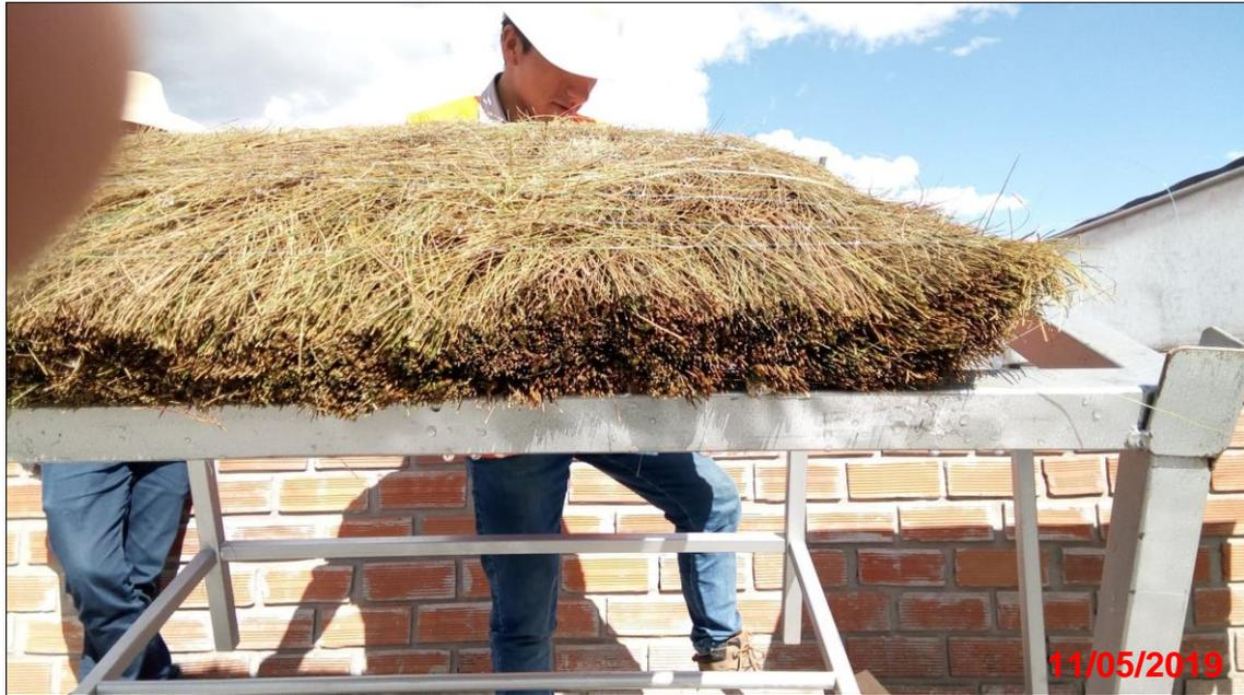
Fotografía 26: Colocación de las membranas de *Stipa Ichu* dentro de las bandejas
