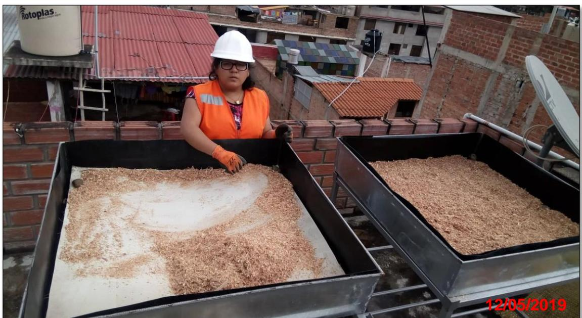
*Fotografía 19: Pesando el material orgánico y la tierra para luego ser mezcladas (20% y 80% respectivamente)*
