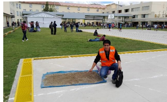
Foto N° 06: Secado de los agregados para la realización de los ensayos.
