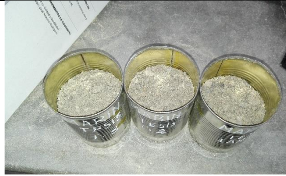
Foto N° 8: Muestra de agregado fino sacado del horno.
