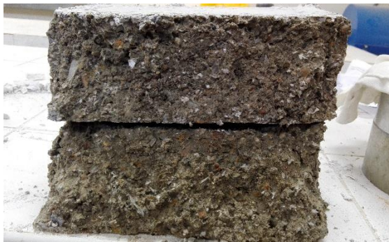
Foto N° 27: Unidades de ladrillo ensayadas con la incorporación de papel y PET..
