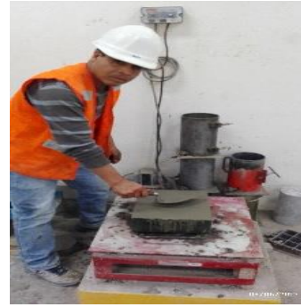
Foto N° 18: Vibrado de los moldes de ladrillo, para su posterior desmolde.
