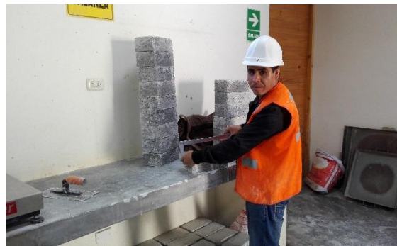
Foto N° 24: Medición de las medidas de las unidades de ladrillo.
