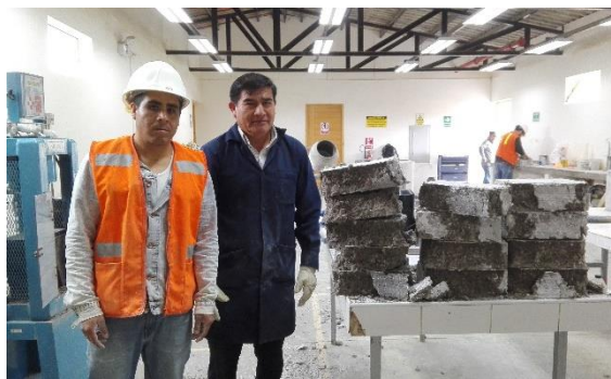
Foto N° 21: Rotura de las unidades de ladrillo.
