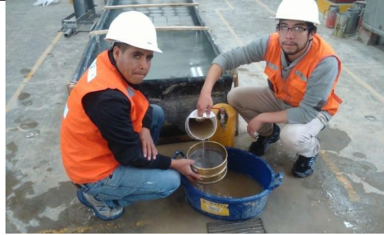
Foto N° 16: Lavado del agregado para determinar la cantidad de material fino.
