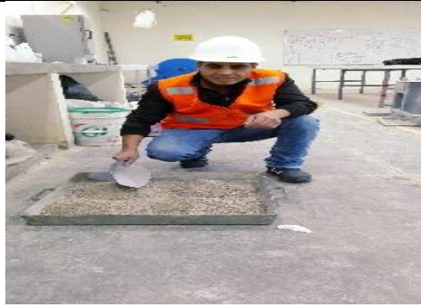
Foto N° 07: Selección de las muestras de agregados para la realización de ensayos.
