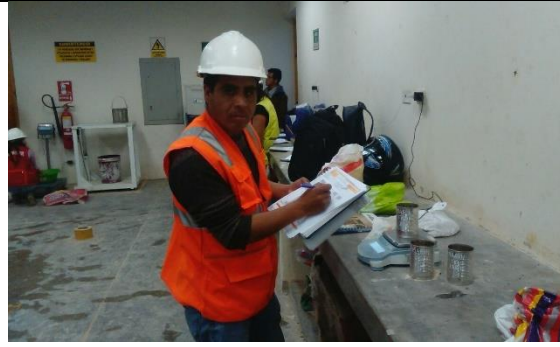
Foto N° 14: peso de las muestras sacadas del horno.
