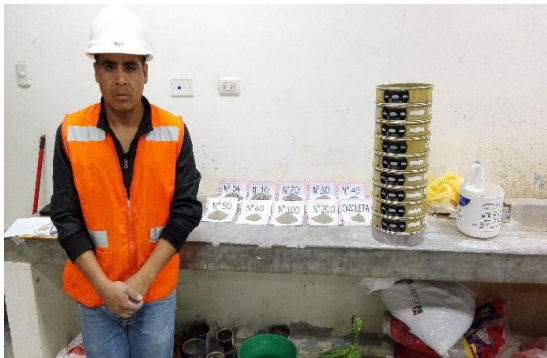
Foto N° 09: Ensayo de granulometría por tamizado de agregado fino.
