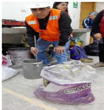
Foto N° 11: Pesos volumétrico de los agregados.
