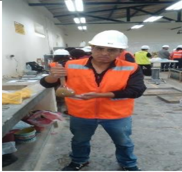
Foto N° 15: sacando el aire del picnómetro para determinar el peso específico.
