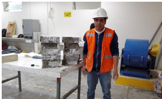
Foto N° 23: unidades de ladrillo ensayadas.
