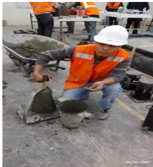
Foto N° 17: Medición del slump, después de corregir por la incorporación del papel.
