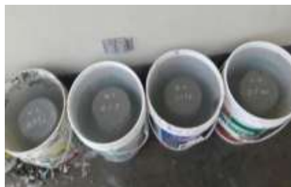
Figura 8: Probetas sumergidas en agua para el curado.
