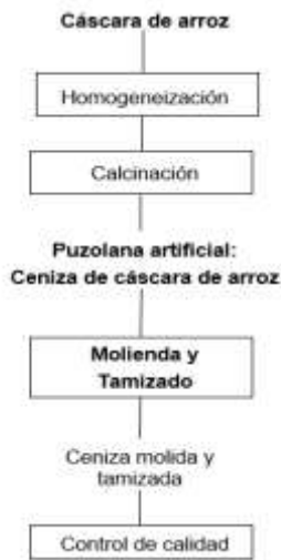
Figura 1: Proceso de obtención de la ceniza de cáscara de arroz.
