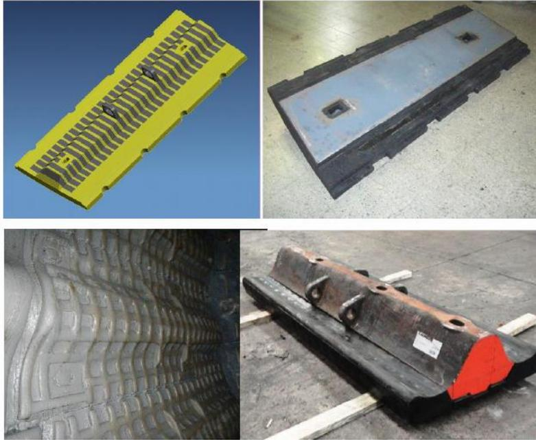
*Figura 15. Revestimiento en el cilindro de molino SAG*
