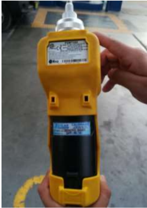
Imagen 6 - Equipo MiniRae3000 - calibración vigente
