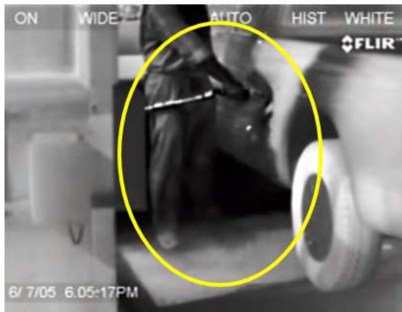
Imagen 1 - Vapores generados en el despacho de combustible - Fase II
