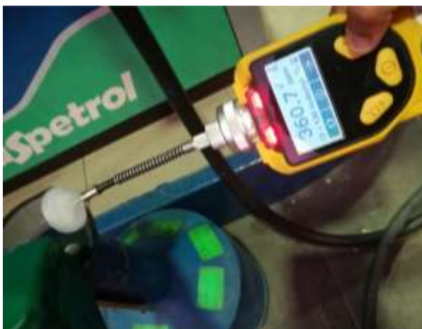
Imagen 8 - Medición de vapores en control de cantidad en patrón volumétrico
