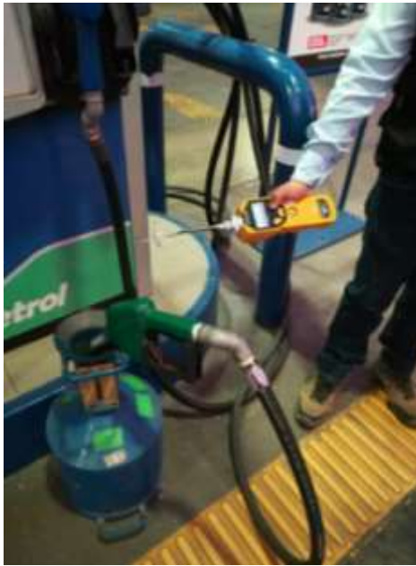
Imagen 9 - Medición de vapores en control de cantidad
